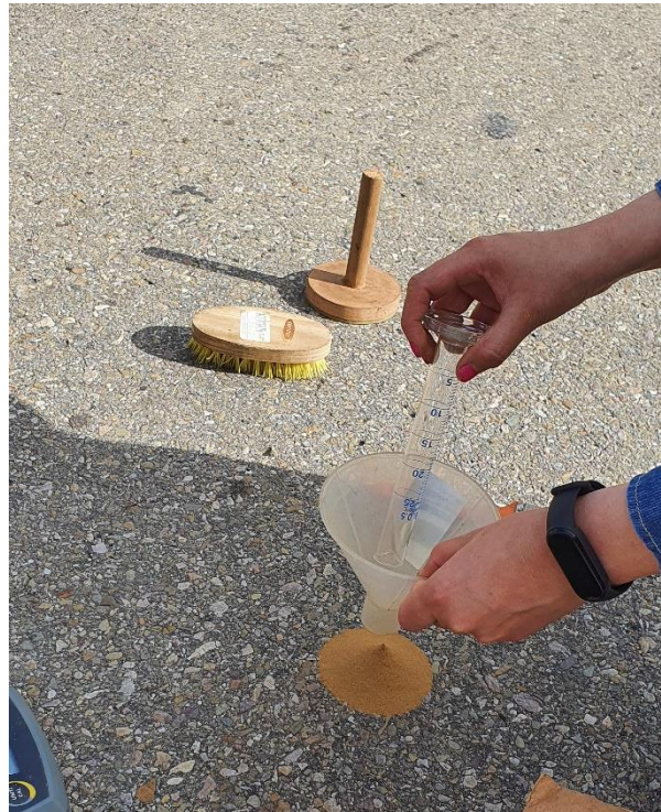
Ensayo de la mancha de arena.
