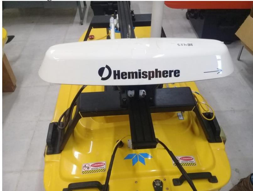
El V320 proporciona información precisa y fiable de la información de posición y rumbo. Para llevar a cabo esta tarea el V320 utiliza un receptor GNSS de alto rendimiento y dos antenas para procesamiento de señales GNSS. Una antena es primaria y la otra secundaria. Las posiciones calculadas por la V320 se referencian entre el centro de la fase de la antena GNSS primaria.
