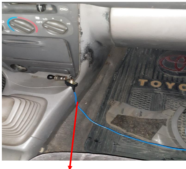
Interruptor de la bomba de agua
