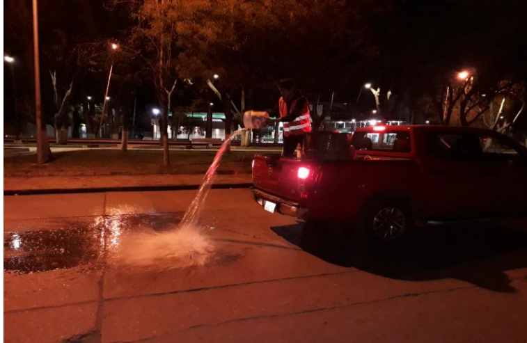
Humedecido de la vía para realizar la prueba de frenado
