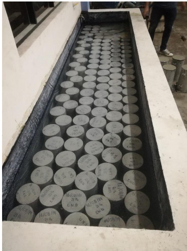
Probetas para la calibración con la prensa hidráulica
