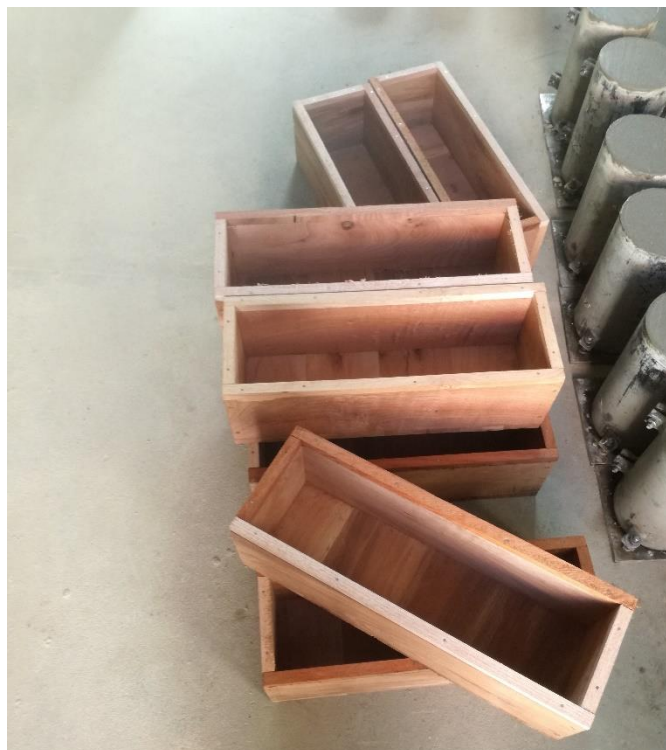
Moldes para la elaboración de las vigas
