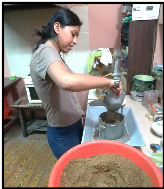
Fotografía 9: Colocación de la muestra al molde -Ensayo Peso Unitario
