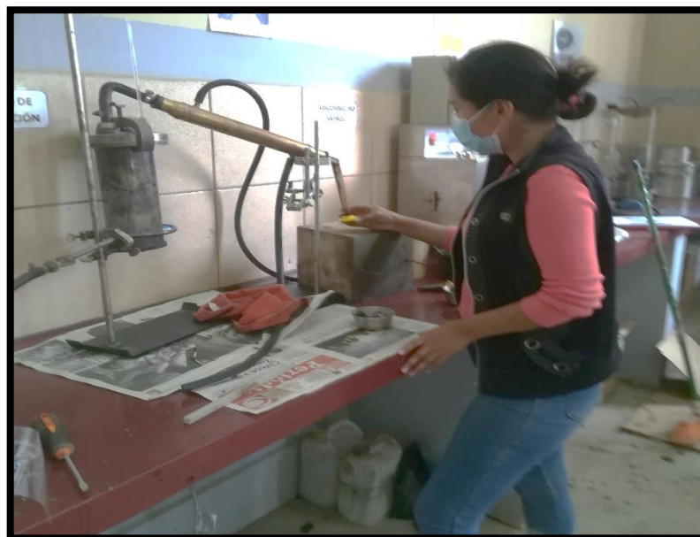
Fotografía 4: Destilación emulsión asfáltica
