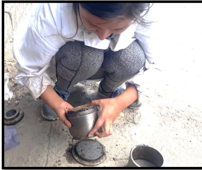
Fotografía 11: Retiro del molde para extraer la briqueta asfáltica
