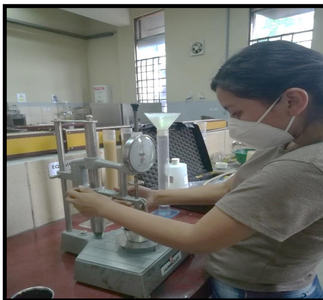
Fotografía 2: Ensayo de penetración al asfalto residual
