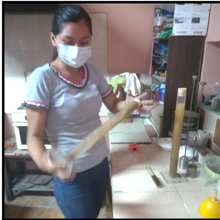
Fotografía 8: Agitado del tubo por 90 seg -Ensayo equivalente de arena
