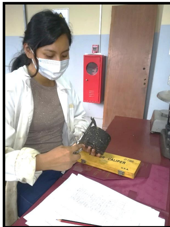
Fotografía 12: Medición de alturas y diámetros de las briquetas asfálticas
