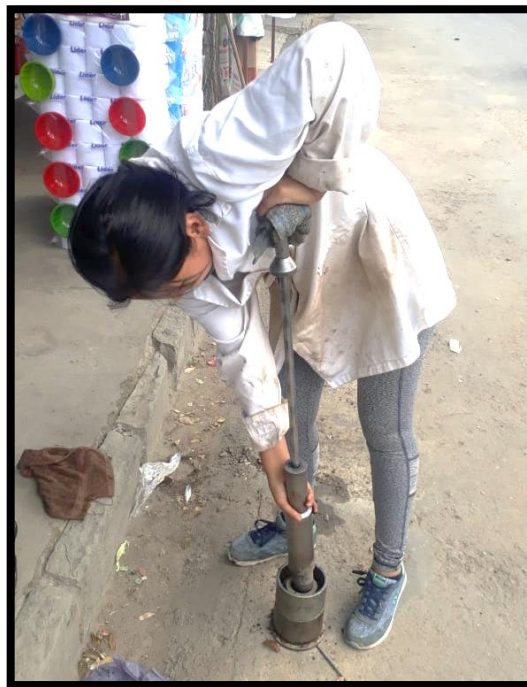
Fotografía 10: Compactación briqueta asfáltica
