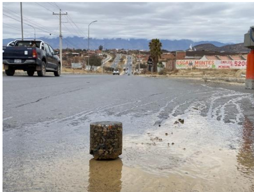
Extracción de la avenida Panamericana, Espesor promediado 10.31 cms
