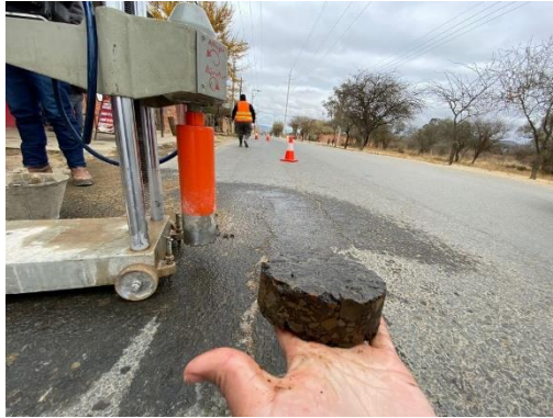
Extracción de la avenida Colon, Espesor promediado 3.72 cms
