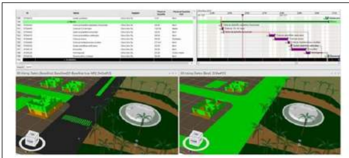
Figura 8: Control de la producción en obra y actualización de la planificación en tiempo real
