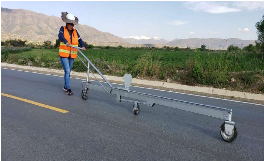
Desplazando el detector HI-LO
