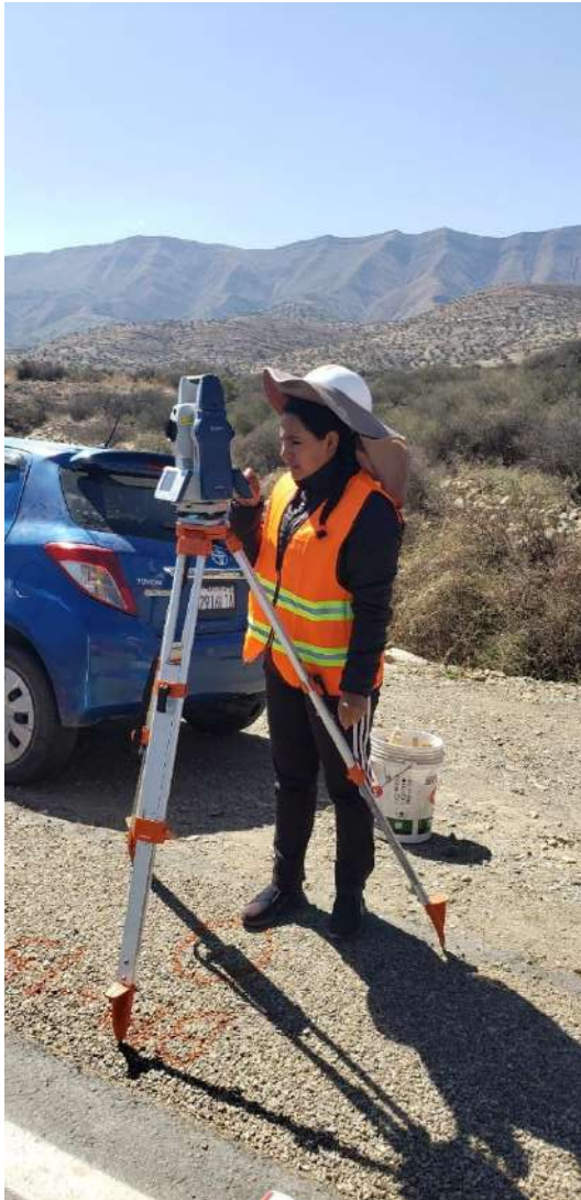
Nivelación de la estación total
