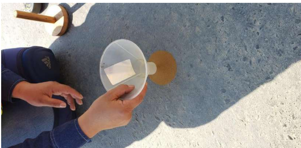
Colocado de la arena sobre el pavimento
