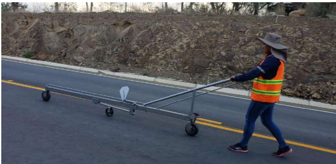
Registro de un bajo con el detector
