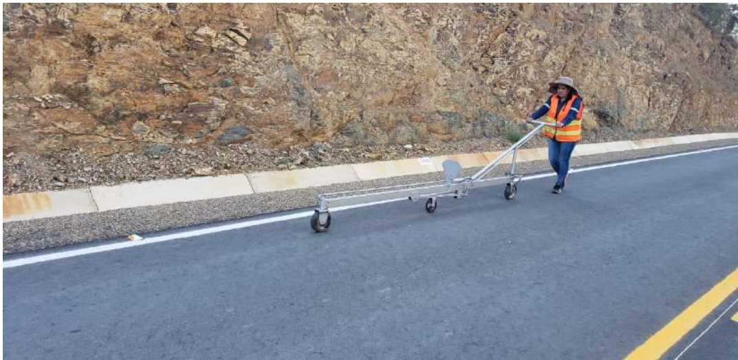
Desplazando el equipo del detector HI-LO
