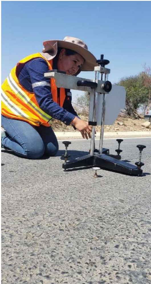
Nivelando el péndulo Británico
