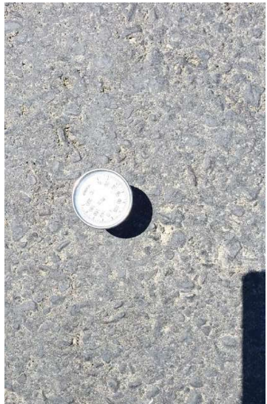
Lectura la temperatura del pavimento
