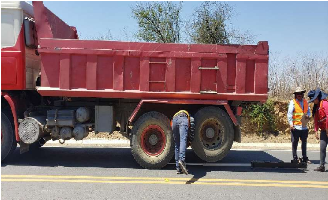
Colocando la viga Benkelman en posición
