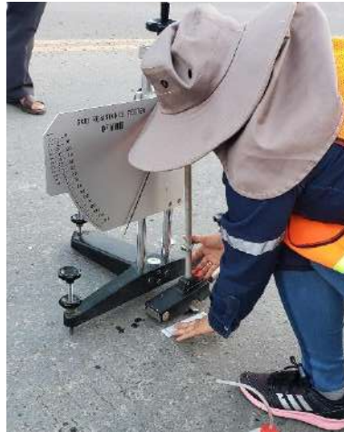
Verificando la longitud de la huella de la zapata
