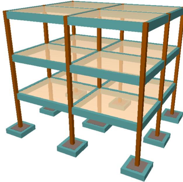
**Paso N°6** – Pasada la verificación de los elementos pasamos a revisar la deformada de la estructura, es aquí entonces donde podemos ver que el modelado de la cimentación con el módulo de balasto nos muestra las fundaciones, esto decir que nuestra estructura ahora si esta interactuando con el terreno.
