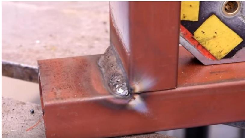
**Figura 3.8.** Soldadura en Perfiles Rectangulares
