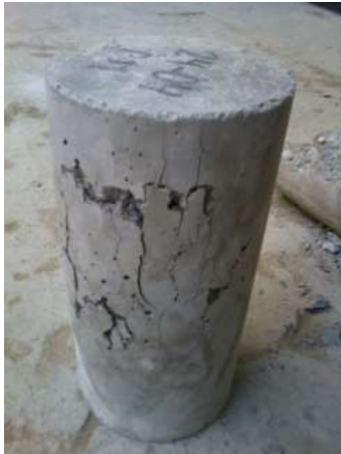
Probeta cilíndrica después del ensayo de resistencia a compresión
