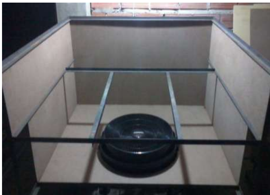
Ventilador en la cámara ambientada
