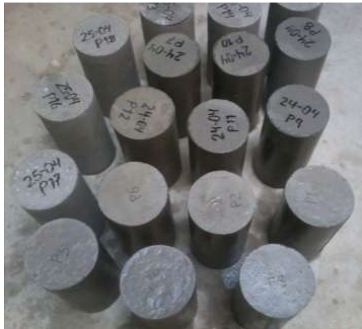
Probetas cilíndricas para el ensayo de resistencia a compresión
