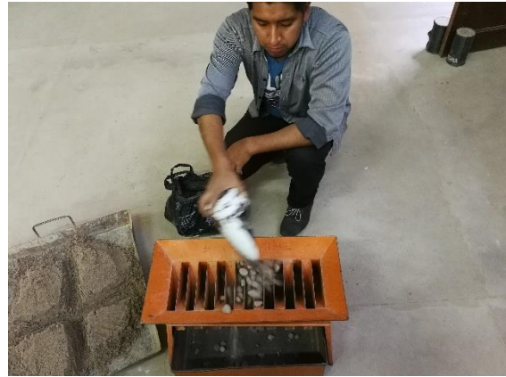
b) Cuarteo del agregado grueso.
