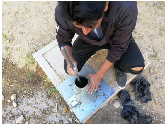
d) Compactado del H° en el cono de abram.
