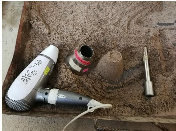
d) prueba de humedad del agregado fino.
