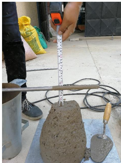
f) Medición del asentamiento.
