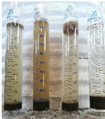
Figura 5. 21. SV30 Anóxico – Anaeróbico – Aeróbico – SBR
