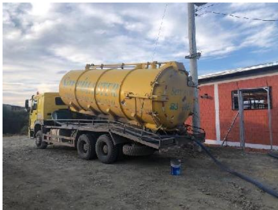
Figura 5. 14. Descarga del lodo hacia la PTAR cathedral
