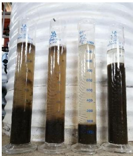
Figura 5. 20. Actualmente las muestras de sedimentación en el tanque anóxico, anaeróbico, aeróbico y SBR
