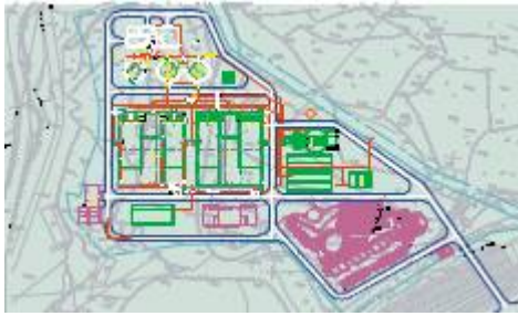
Sanming 80.000 m 3 / d WWTP para eliminación de DBO, NH 3 -N y TSS, ciudad de Sanming, provincia de Fujian, China (CSBR)
