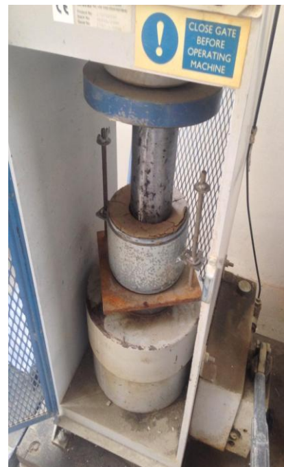
Fotografía 4. 5 Extracción de muestra con prensa hidráulica
