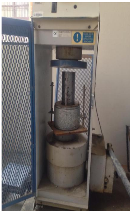
Fotografía 4. 5 Extracción de muestra con prensa hidráulica
