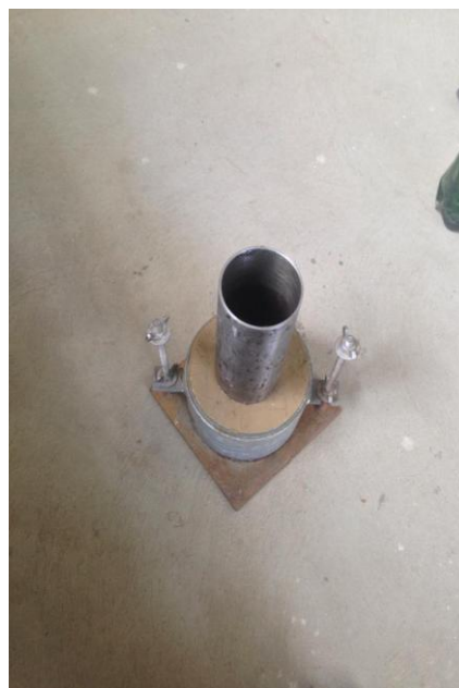
Fotografía 4. 4 Cambio de molde de la muestra para ensayo de permeabilidad
