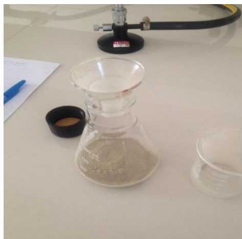
Fotografía 4. 10 Pesado de muestra de suelo para ensayo de pH
