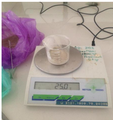
Fotografía 4. 10 Pesado de muestra de suelo para ensayo de pH
