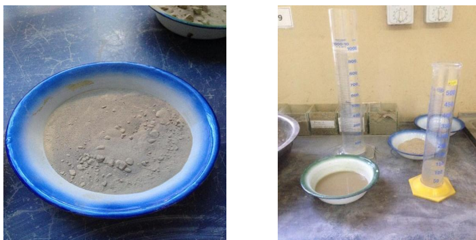
Fotografía 3. 12 Preparación de muestra para ensayo de hidrómetro
