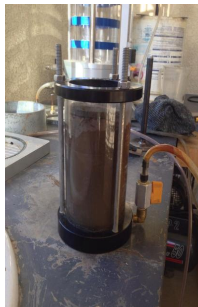
Fotografía 4. 8 Muestra de suelo dentro del permeámetro
