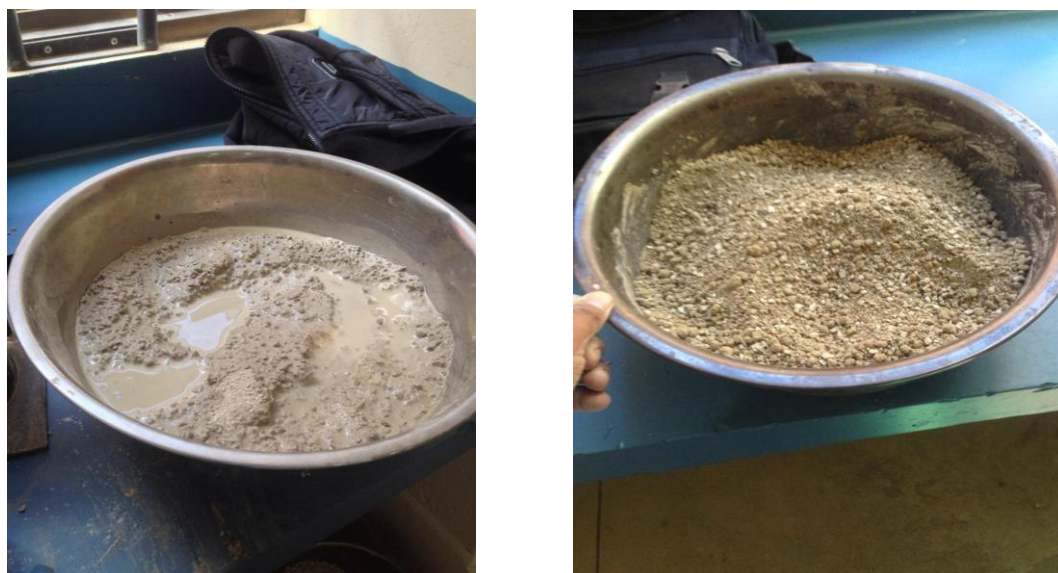
Fotografía 3. 16 Muestra con 5 % de humedad para compactación
