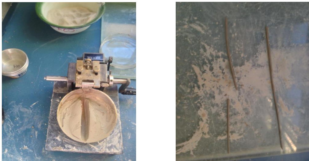
Fotografía 4. 15 Ensayo de límite líquido y límite plástico para muestra suelo-cal
