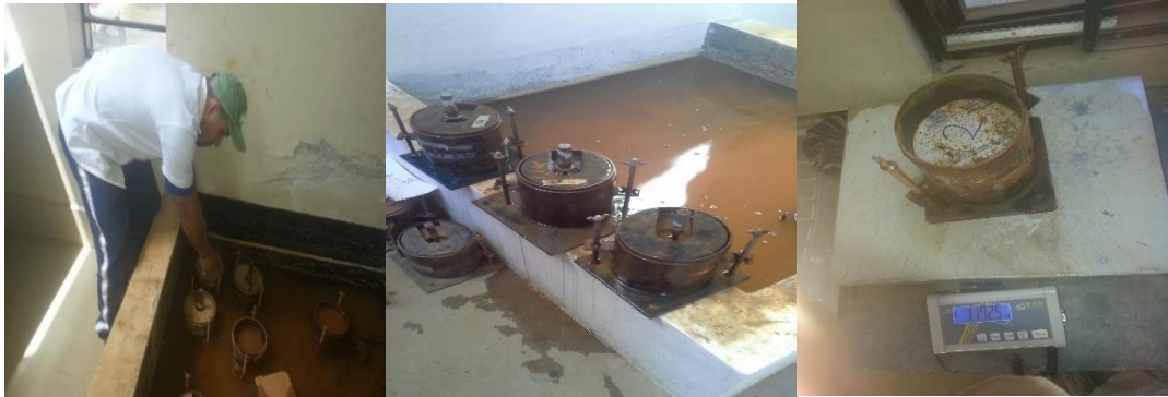
Anexo A.18. Introducción de los moldes en la piscina de saturación.
