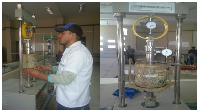
Anexo A.19. Lectura de la deformación del molde de CBR en la prensa encofinada.
