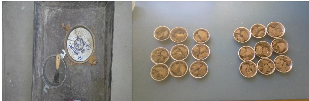
Anexo A.20. Extracción de las muestras de los moldes de CBR.
