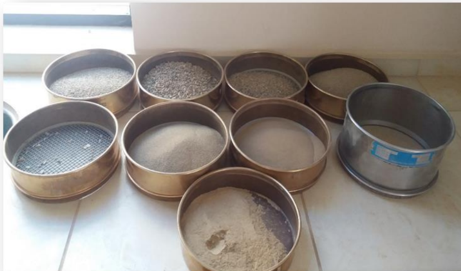
Tamices con peso retenido de la arena.
