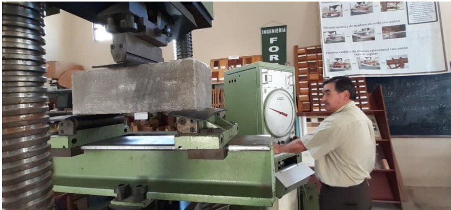
Anexo 15 Probeta colocada en prensa universal
