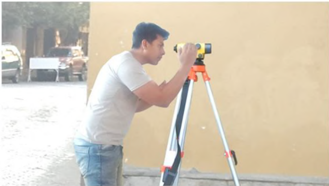
Fotografía 6: Levantamiento de pendiente de la intersección Campero – Corrado
