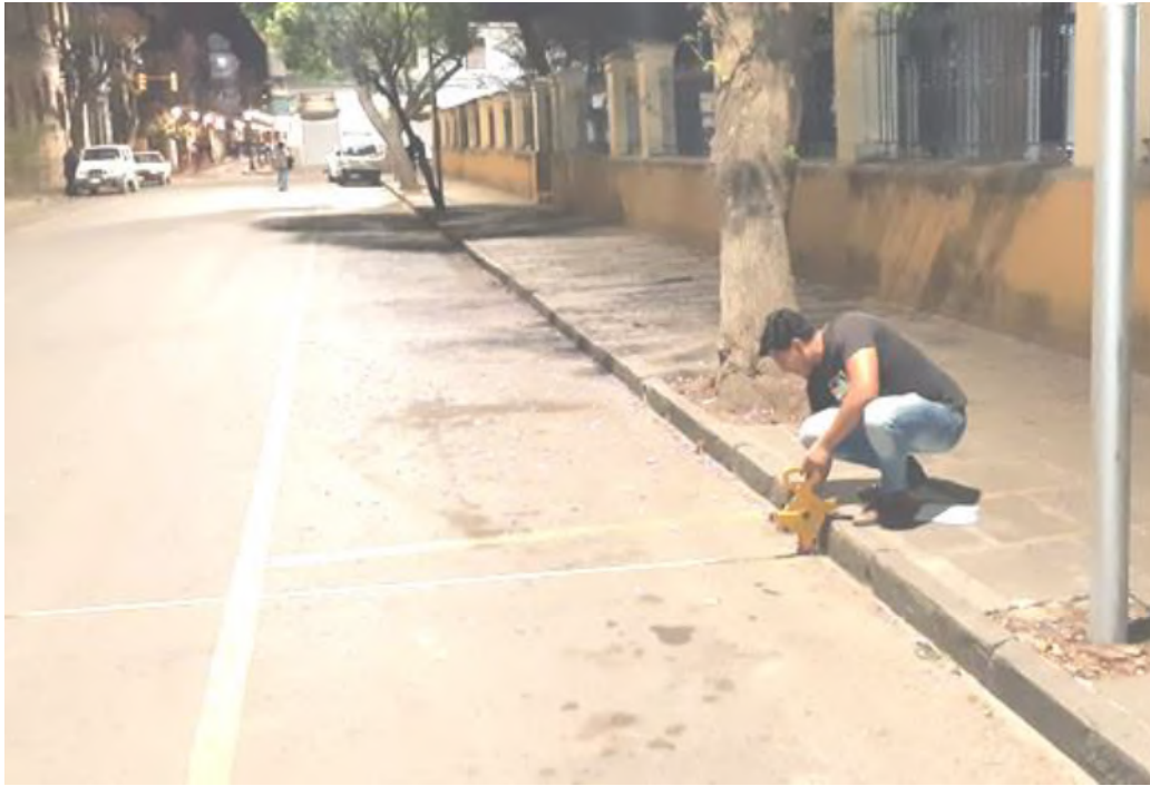
Fotografía 3: Medición del ancho de la calzada de la calle Ingavi
