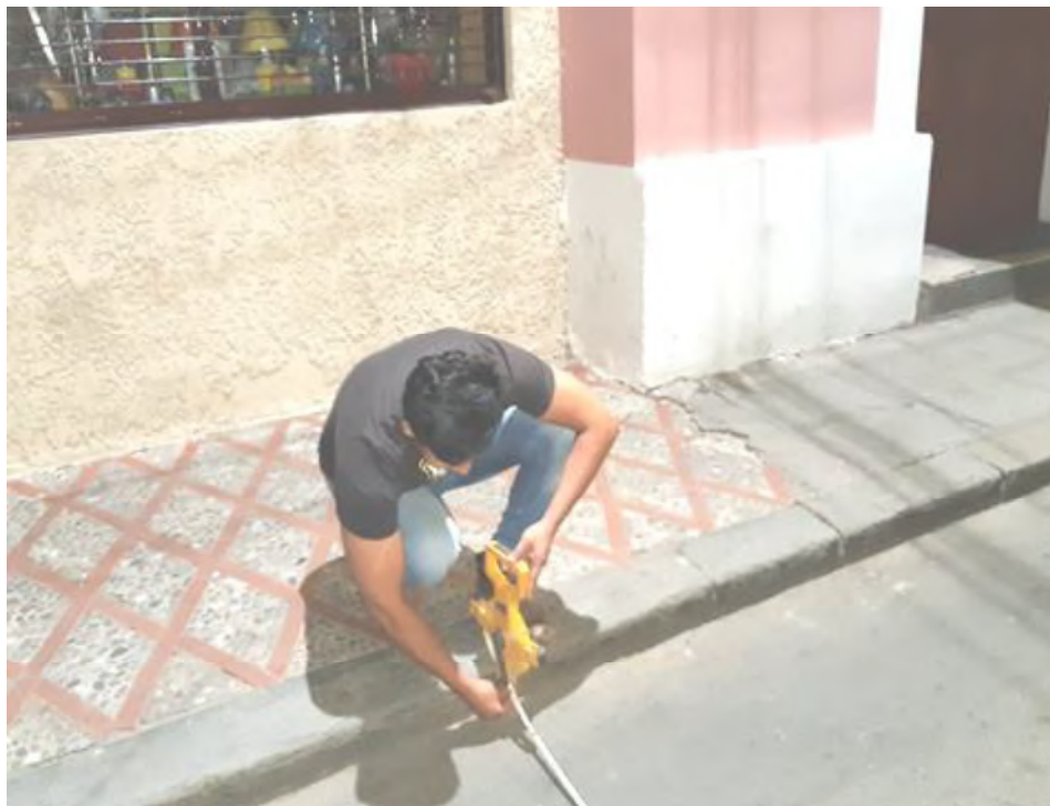
Fotografía 4: Medición del ancho de la calzada de la calle Bolívar
