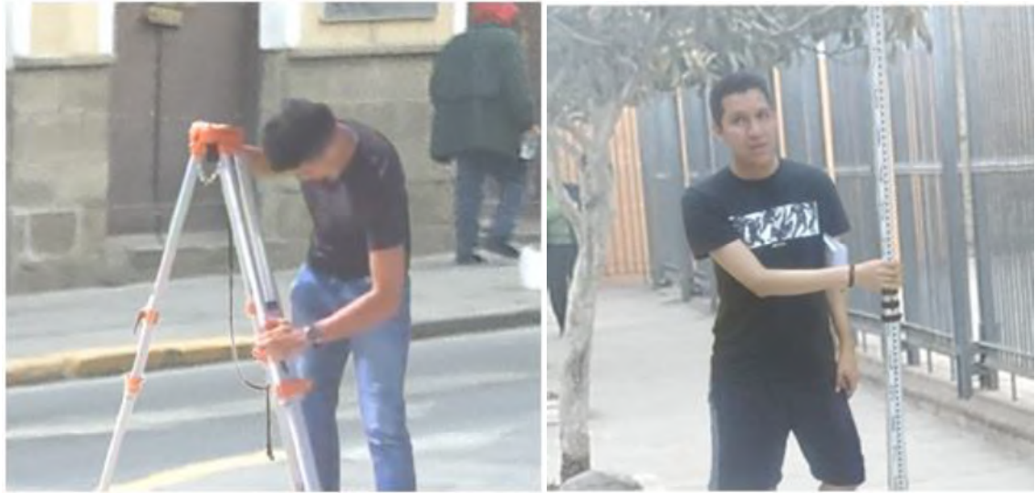
Fotografía 5: Equipo utilizado para el levantamiento de pendiente trípode y mira estadimétrica
