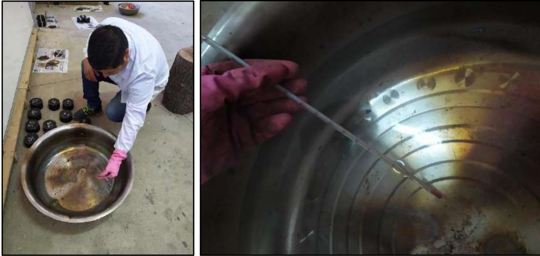
Figura 69: Baño maría a 60 °C antes de la rotura
