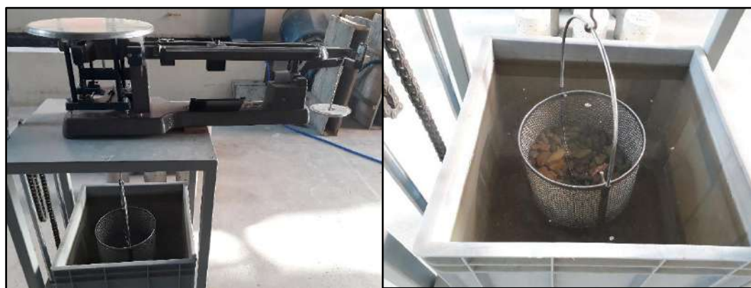
Figura 31: Balanza para determinar el árido sumergido
