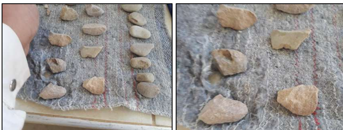
Figura 20: Inspección visual de las partículas de acuerdo al conjunto de fracción separado
