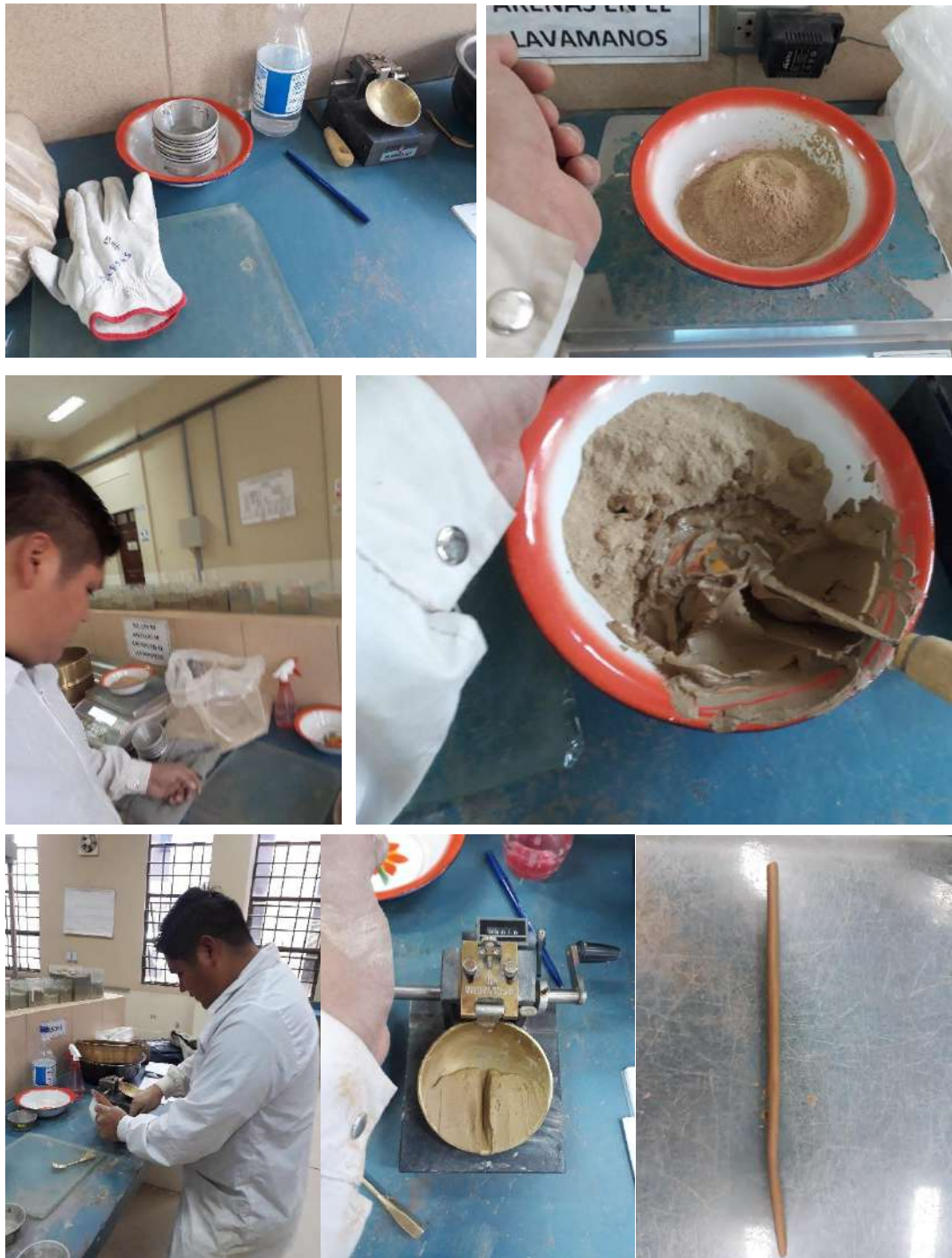
Figura 58: Preparación y obtención de resultados de límite líquido y límite plástico
