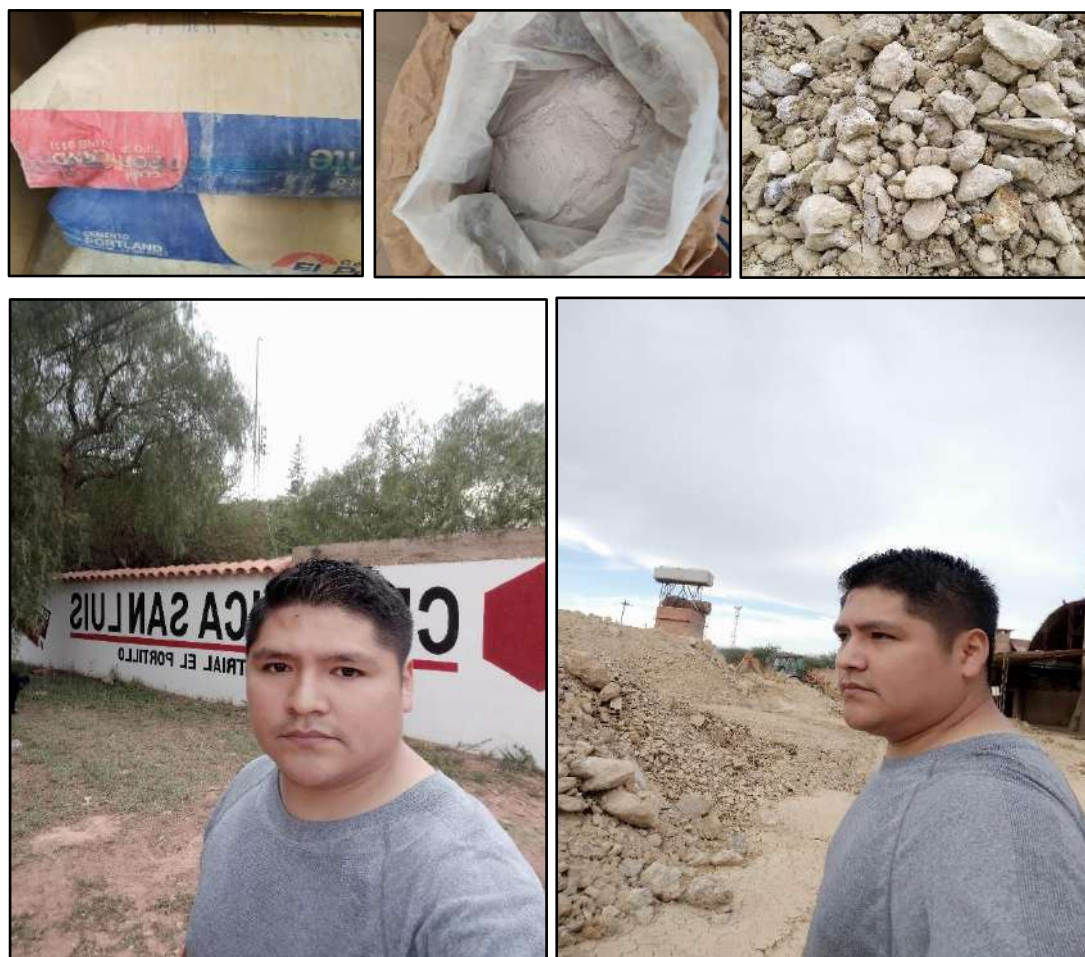
Figura 5: Tipos de filler a utilizar (Cemento Portland IP – 30, arcilla procedente de la cerámica San Luis y cal apagada o hidratada procedente del municipio el Puente)
