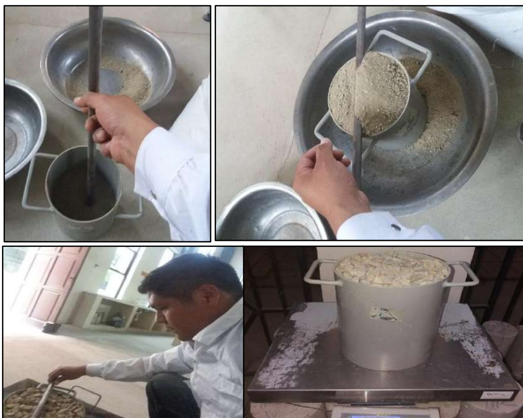
Figura 24: Compactado de material y enrase
