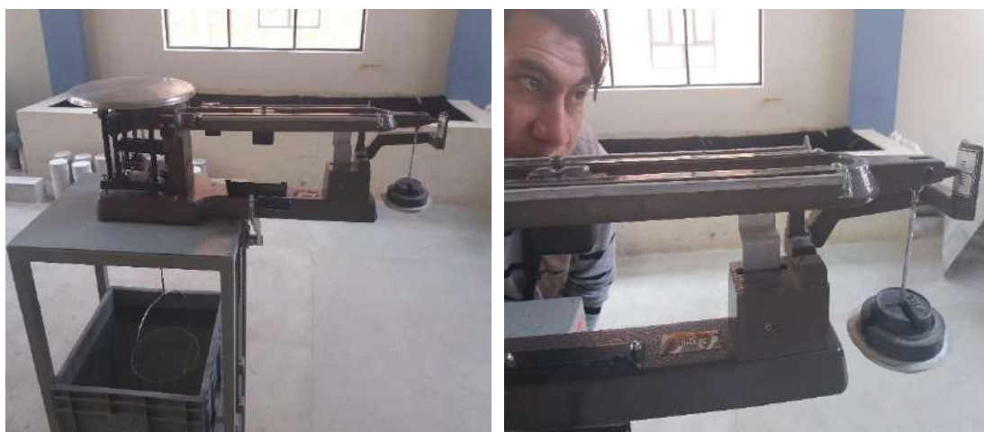
Figura 10: Equipo para determinar el peso sumergido del árido
