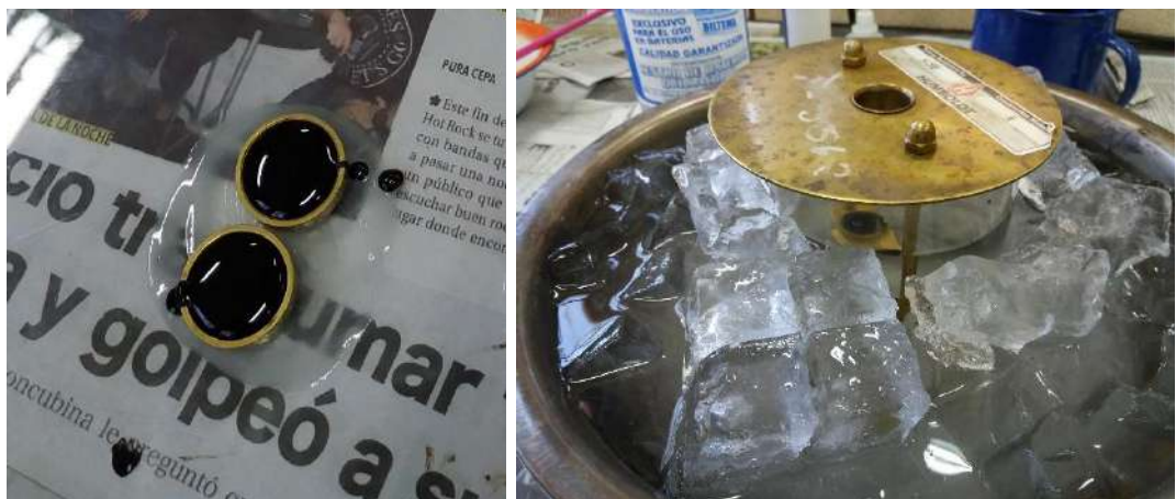
Figura 53: Enfriado de la muestra y posterior lectura con el termómetro para cada variación de temperatura
