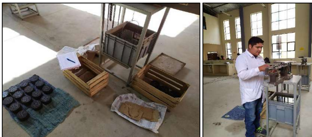
Figura 68: Lectura de peso sumergido
