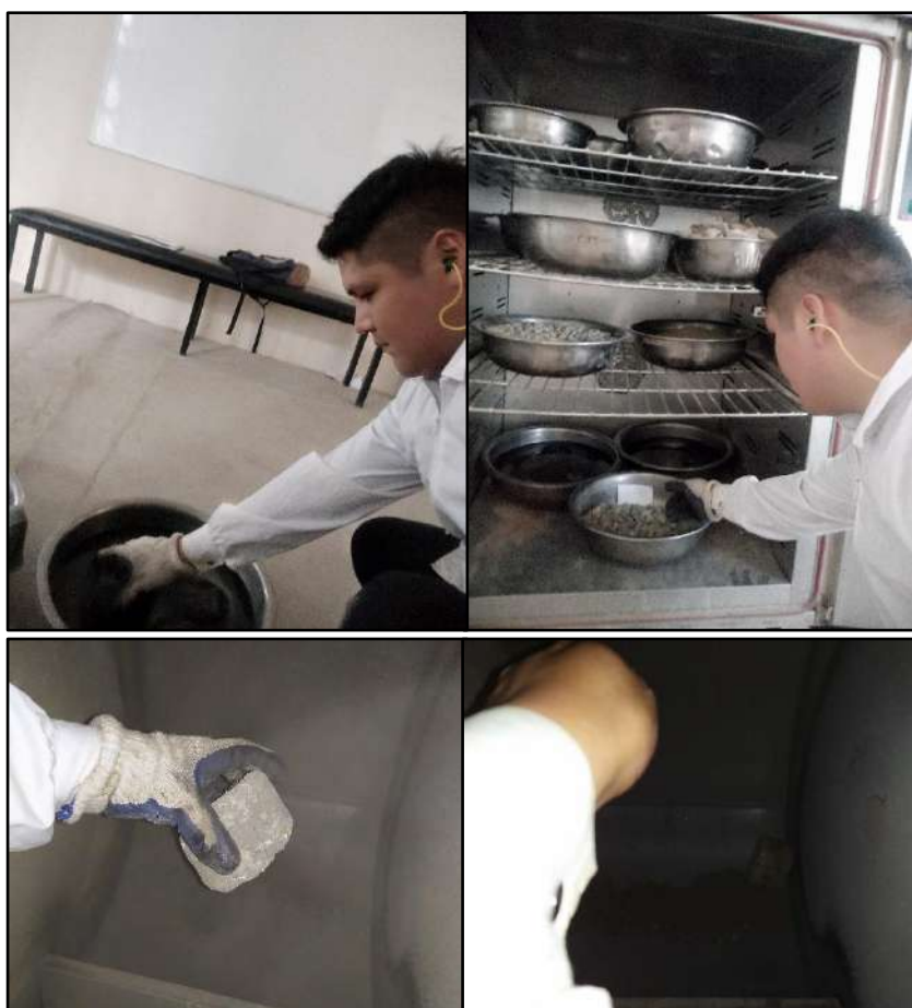
Figura 73: Ensayo en la máquina de Cántabro luego de las 24 horas
