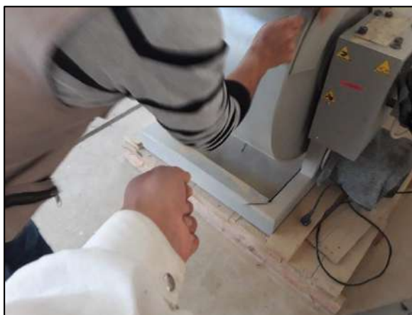
Figura 35: Puesta en marcha de la máquina de los Ángeles
