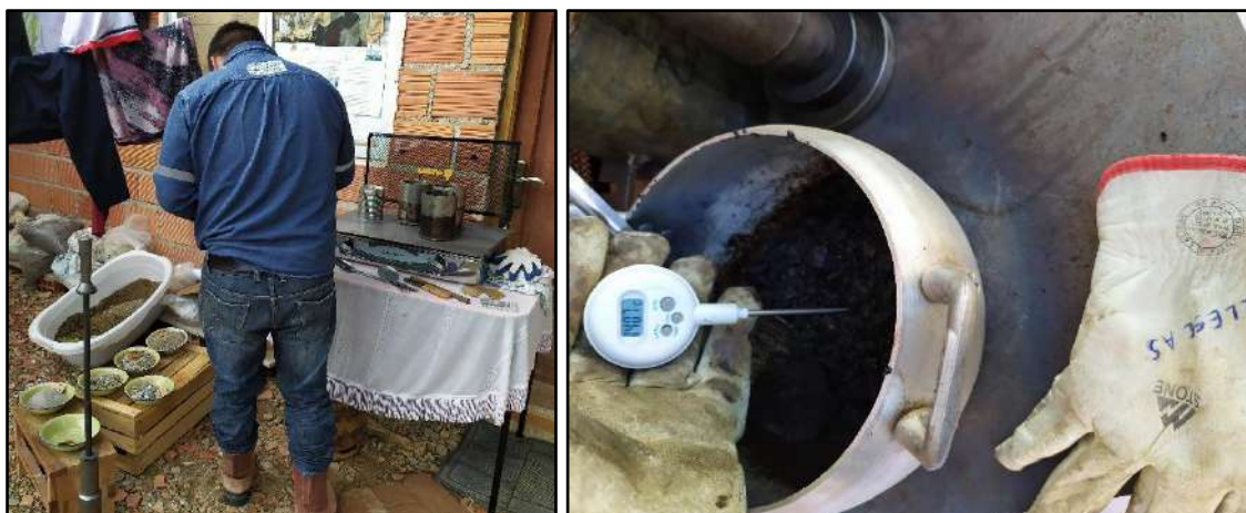
Figura 63: Preparación de los materiales pétreos a diferentes porcentajes y toma de temperatura de la mezcla
