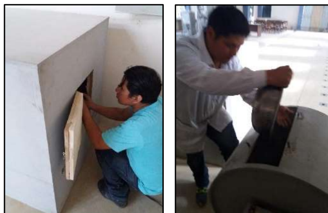
Figura 15: Introducción del material a la máquina de los Ángeles
