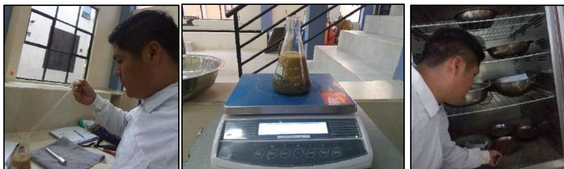
Figura 13: Pesado y colocado al horno para el secado del material fino
