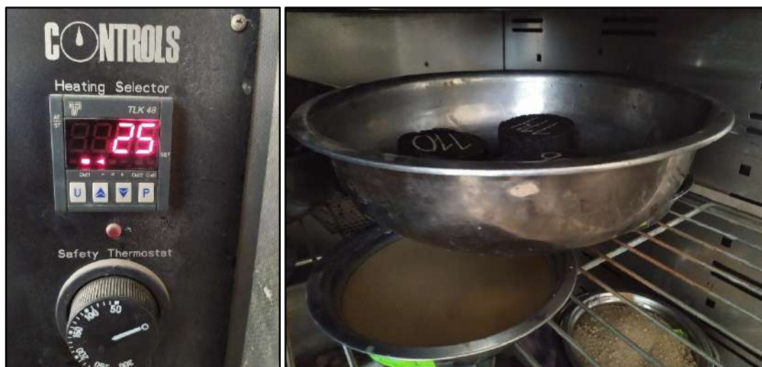
Figura 74: Control de temperatura a 25 °C para su posterior ensayo
