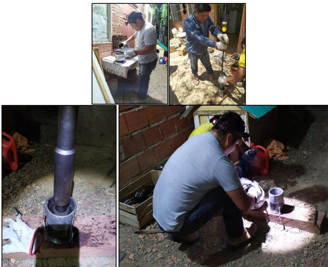
Figura 64: Compactación de la mezcla asfáltica
