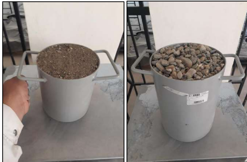
Figura 42: Apisonado de material y pesado
