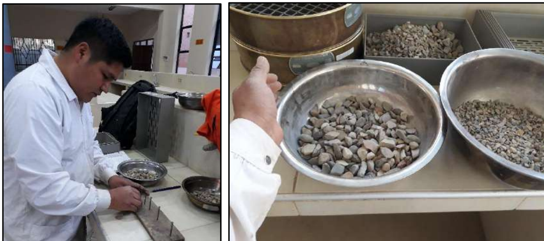
Figura 25: Preparación de material a utilizar y selección de partículas alargadas
