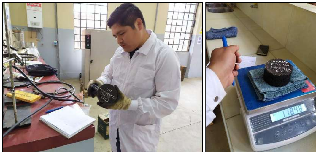
Figura 66: Determinación de la altura con Vernier y peso seco de cada briqueta diseñada
