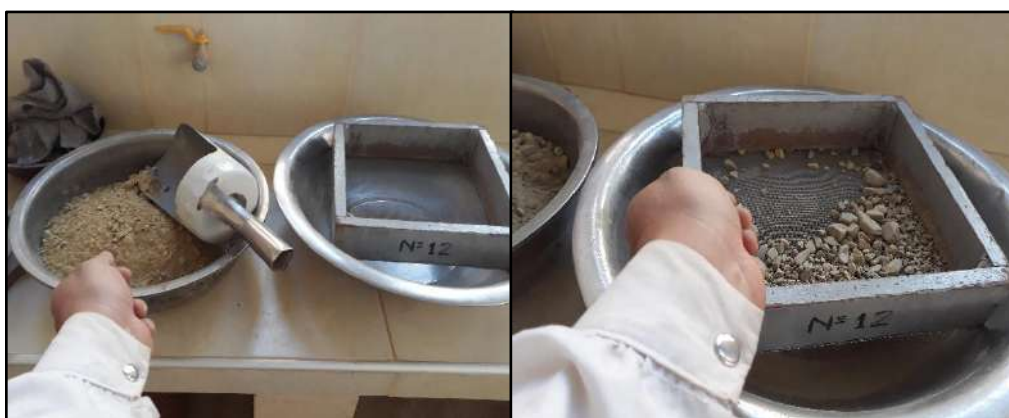
Figura 37: Tamizado del material
