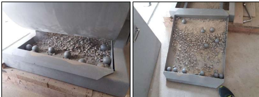
Figura 16: Material desgastado a 500 revoluciones
