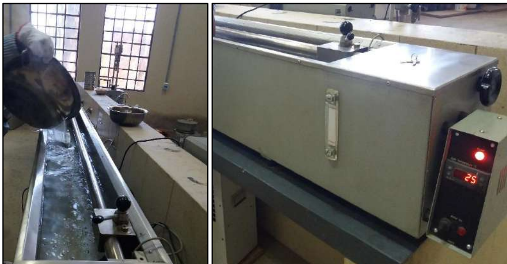
Figura 50: Preparación de la muestra en baño a 25 °C según norma
