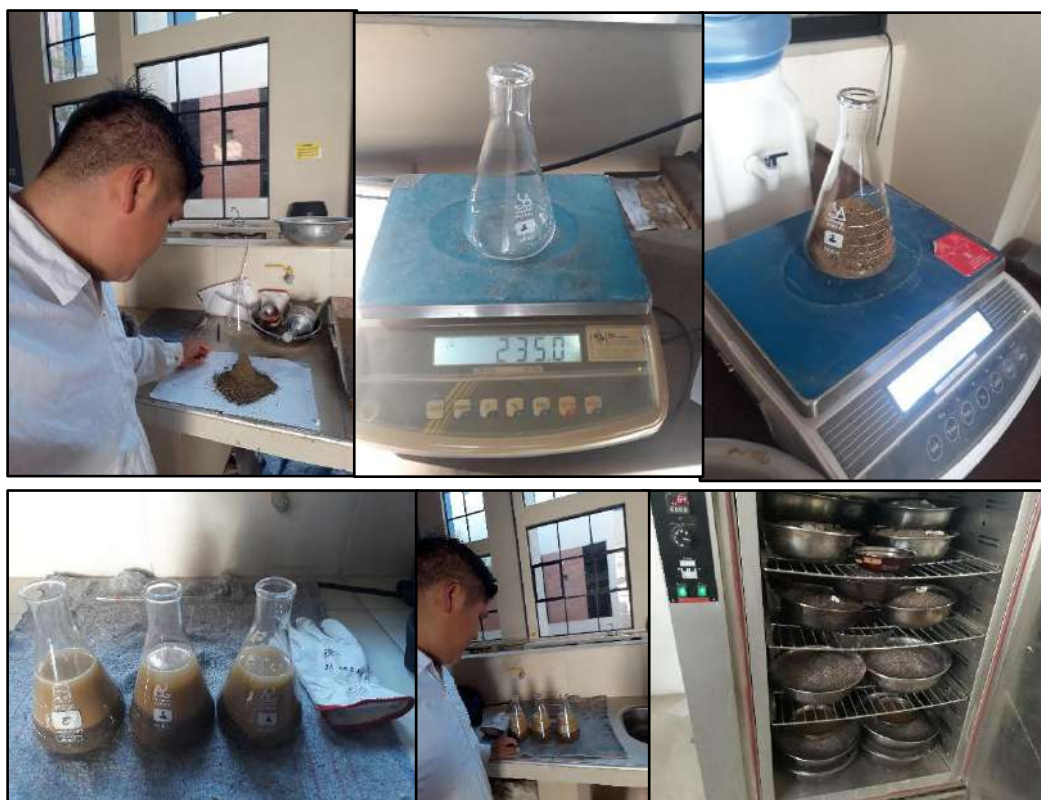
Figura 33: Verificación, pesado y colocación del material fino en el matraz
