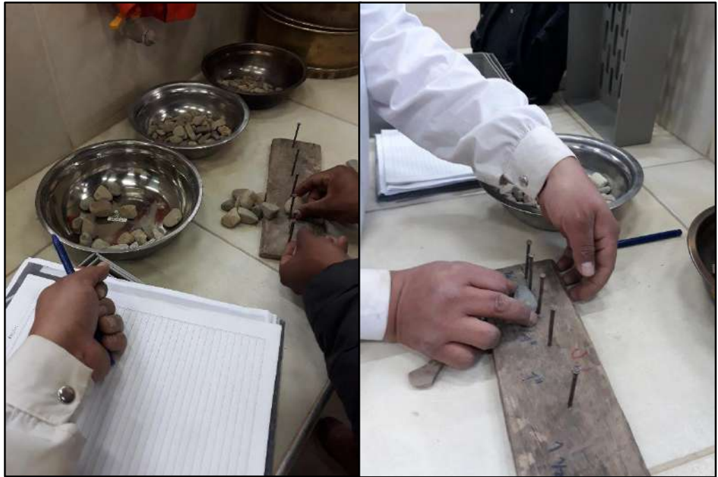
Figura 43: Verificando el alargamiento del material
