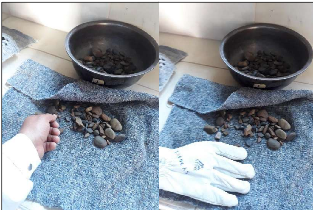
Figura 30: Secado superficial del agregado luego de ser sumergido en agua durante 24 horas
