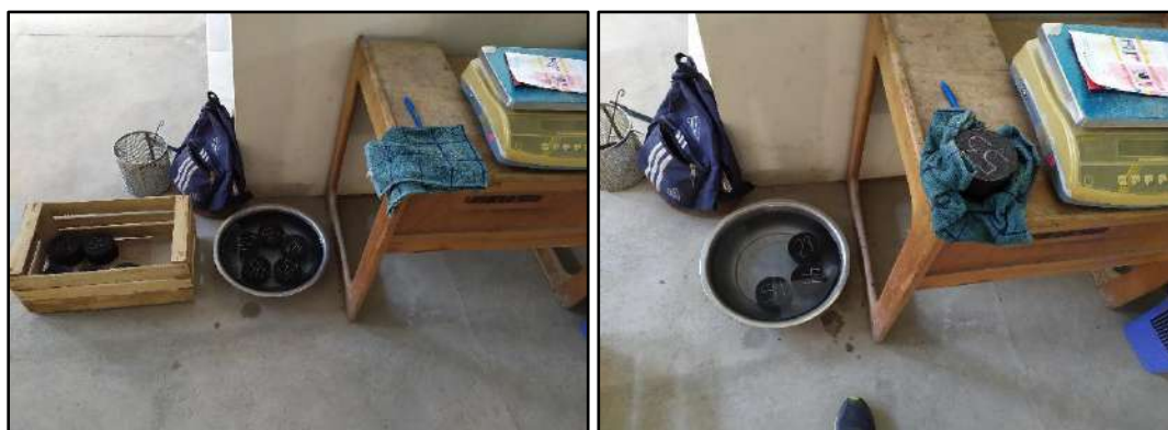
Figura 67: Lectura de peso superficialmente seco
