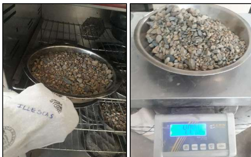
Figura 38: Material del desgaste colocado al horno y posterior pesado en seco
