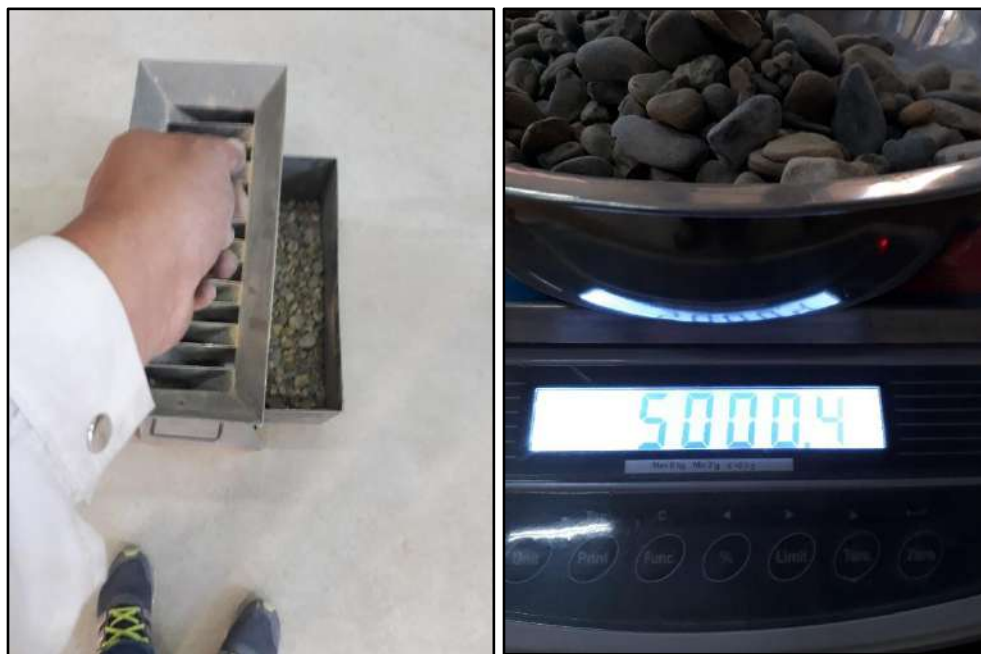
Figura 27: Cuarteo y pesado de la muestra
