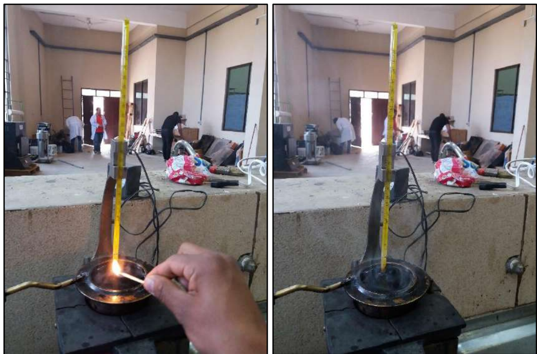
Figura 51: Determinando el punto de inflamación del cemento asfáltico
