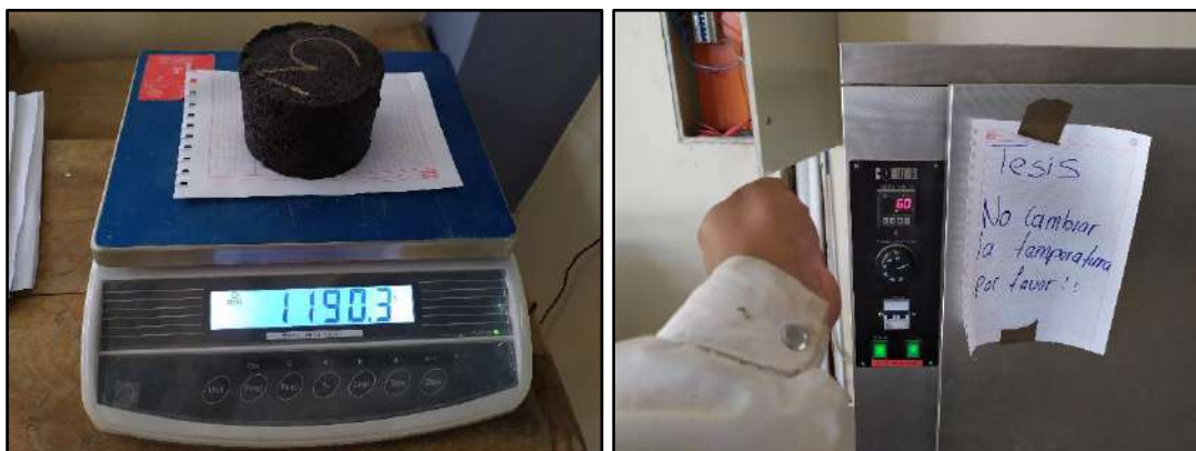
Figura 72: Lectura de su peso y control de temperatura para sumergir las briquetas a 60 °C durante 24 horas según norma
