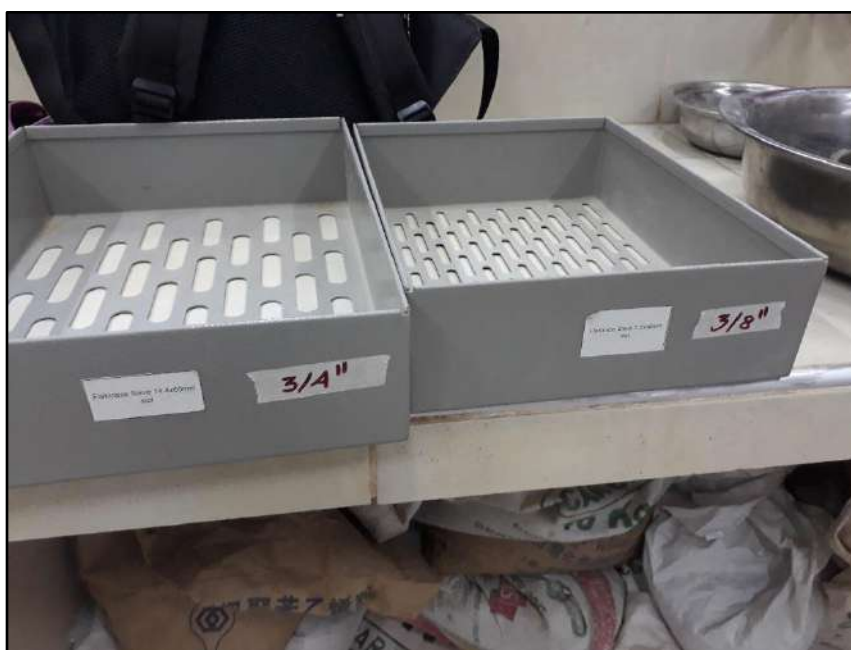
Figura 26: Tamices para determinar el aplanamiento de las partículas
