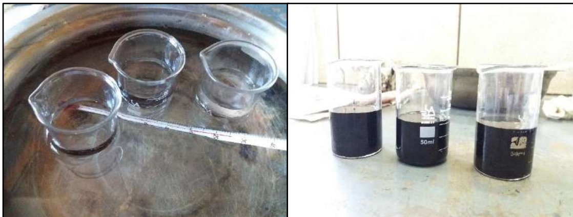
Figura 46: Determinación de la densidad del cemento asfáltico
