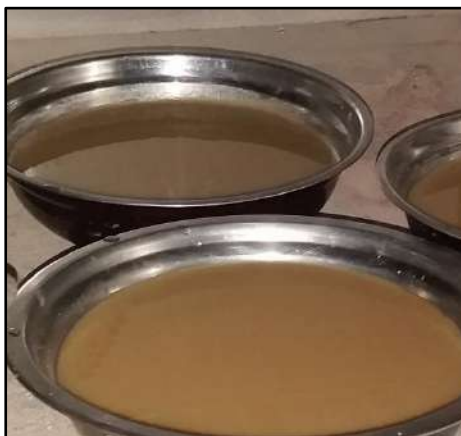
Figura 11: Árido fino sumergido en agua durante 24 horas
