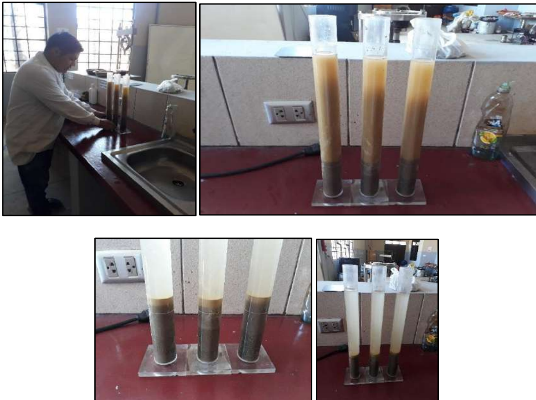
Figura 40: Colocación del material en la probeta mas solución, medición de altura de equivalente de arena
