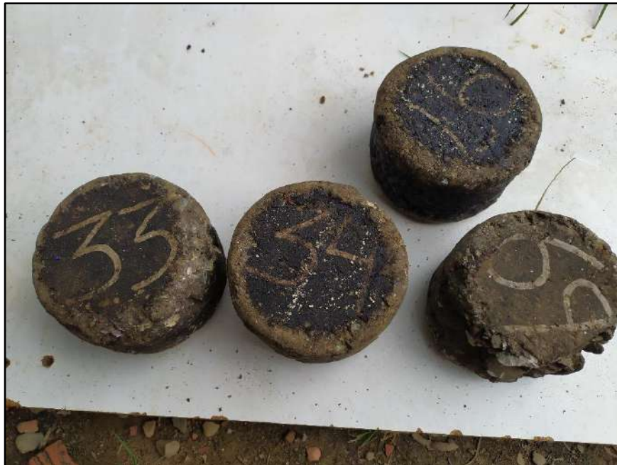
Figura 79: Desgaste con adición de cal hidratada y material de canto rodado
