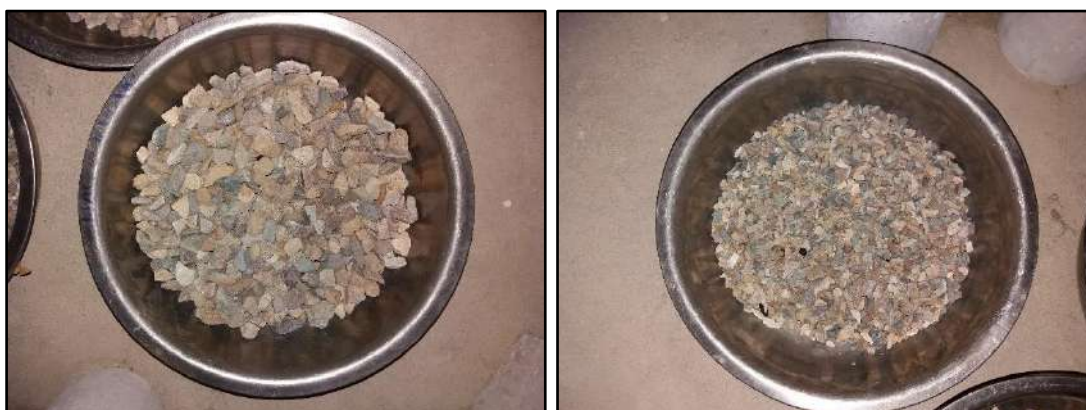
Figura 14: Muestra de ensayo tamizado según especificaciones
