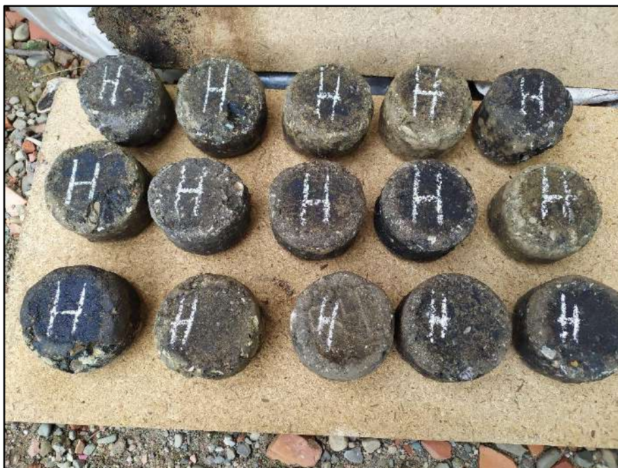
Figura 77: Desgaste en húmedo con material de canto rodado
