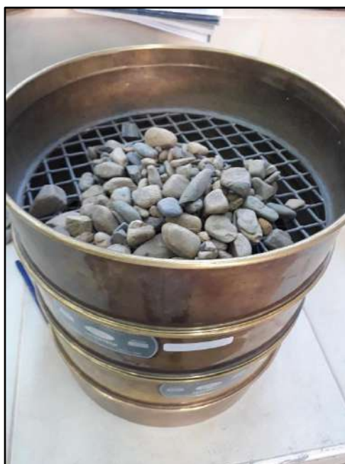
Figura 28: Tamizado del material
