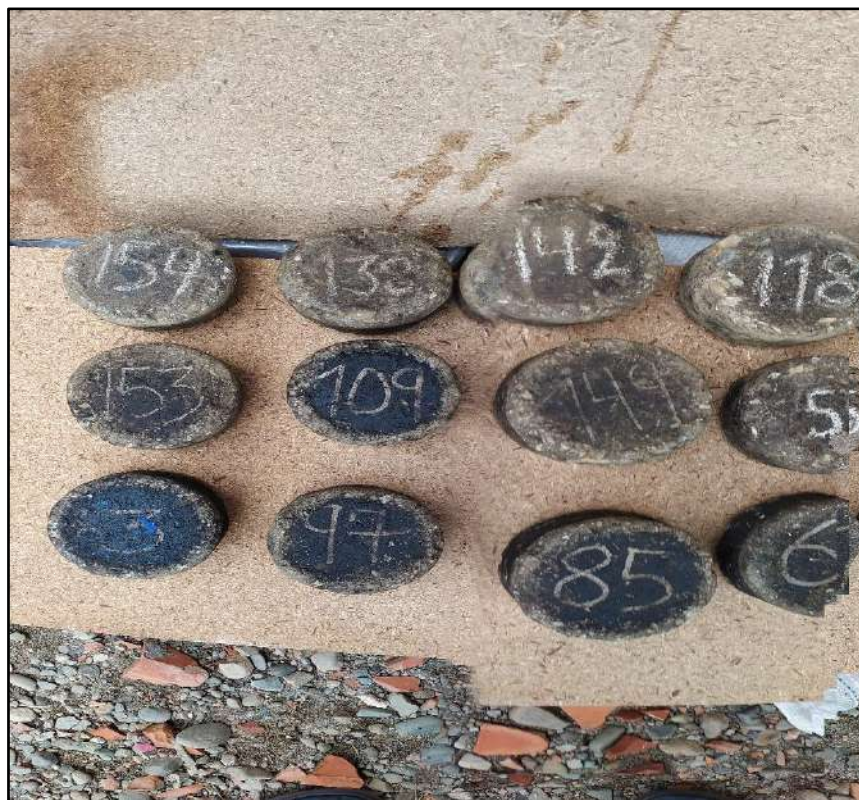
Figura 80: Desgaste en seco con adición de cemento y material chancado
