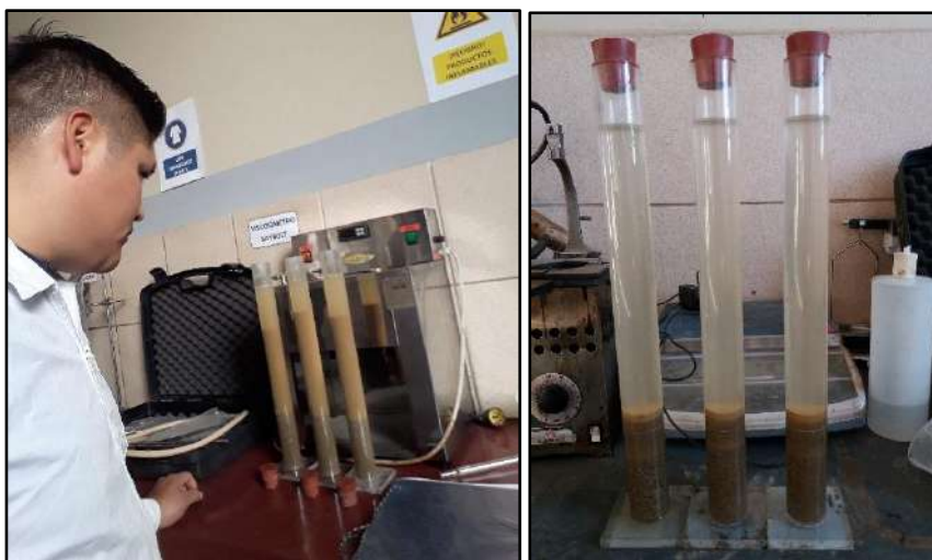
Figura 22: Medición de altura de equivalente de arena
