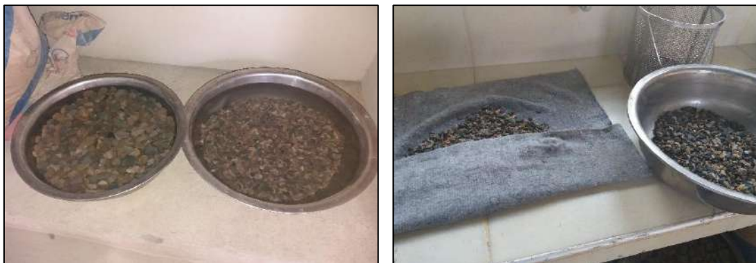
Figura 8: Árido grueso sumergido durante 24 horas antes de realizar la práctica
