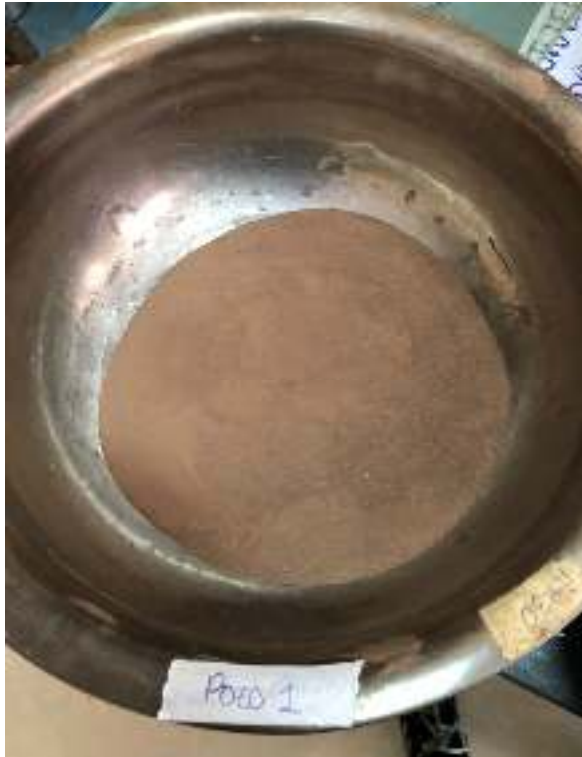
Pesado de taras para el ensayo de Límites de Atteberg
