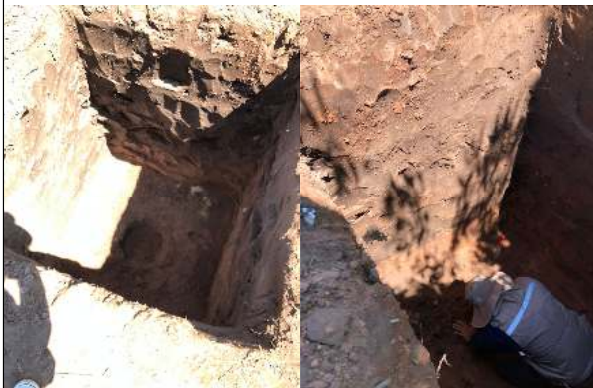
Perfil estratigráfico a 2 metros de profundidad
