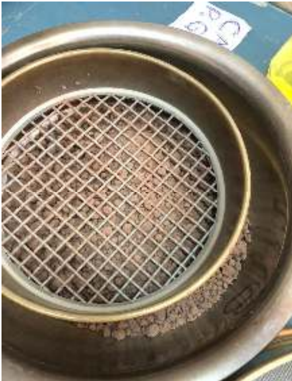
Ensayos realizados para el ensayo de granulometría
