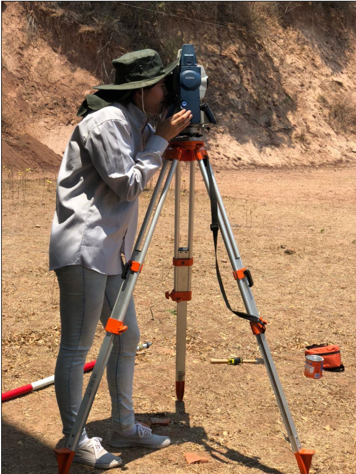
Fotografía de la estudiante Jijena Michel Carol Dayana realizando el levantamiento topográfico mediante el uso de la Estación total Sokia
