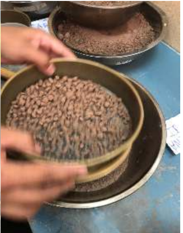
Ensayos realizados para el ensayo de granulometría
