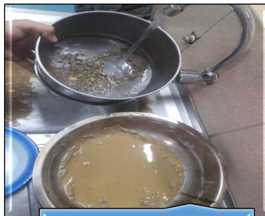
Lavado de la muestra en el tamiz N° 200
