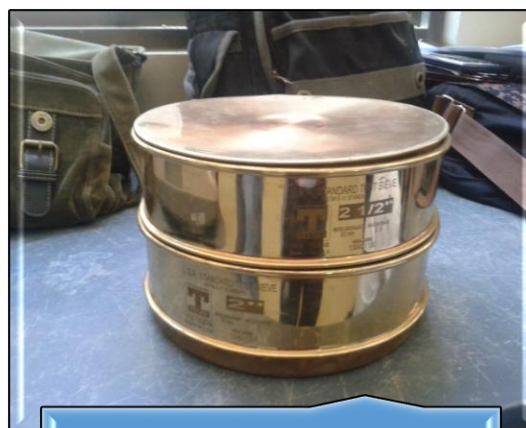
Registro y tamizado de la muestra seca
