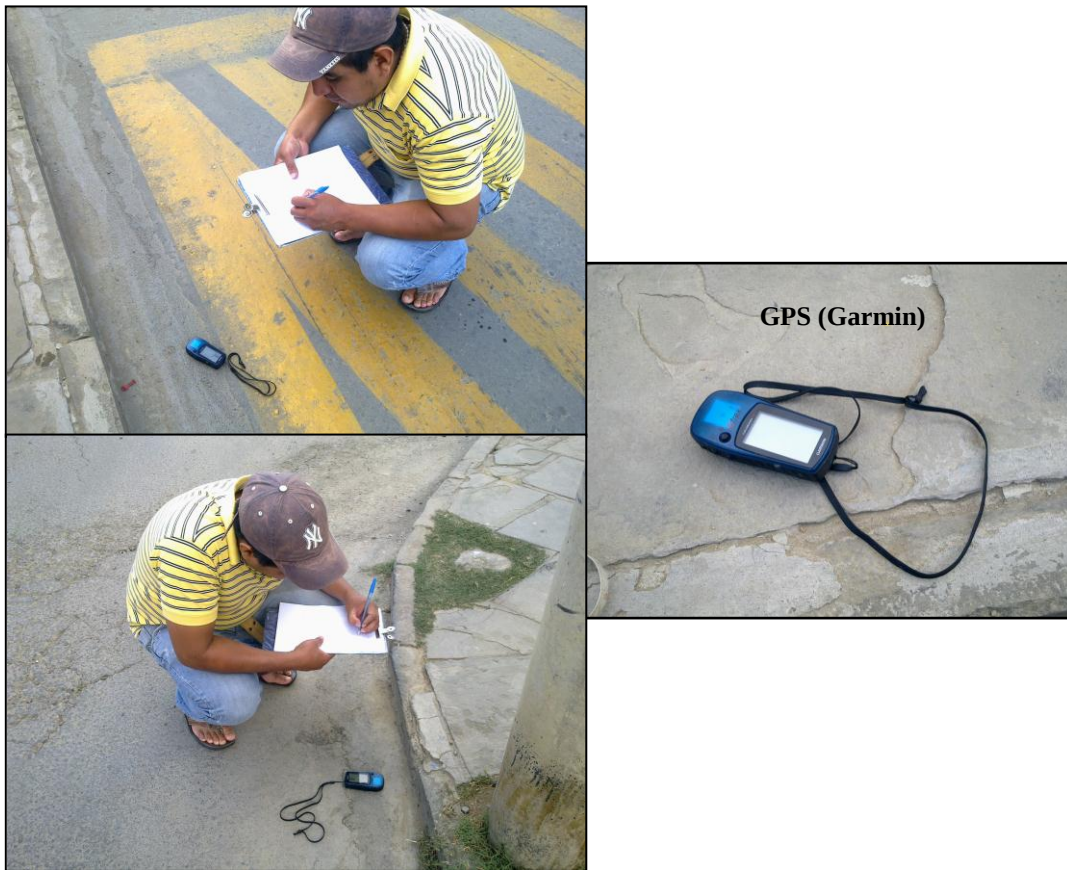
FIGURA 4.6.- Medición de la Pendiente de la Calle con GPS.
