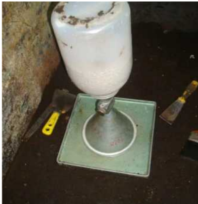
Fotografía 0.10 Toma de densidad en la caja
