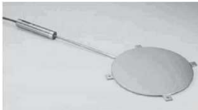
Figura 0.27 Geosensor para medición de esfuerzos
