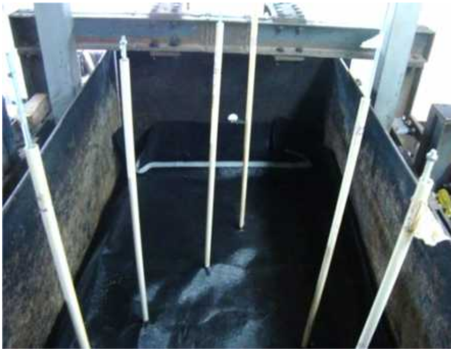
Fotografía 0.7 Geotextil en la interfase
