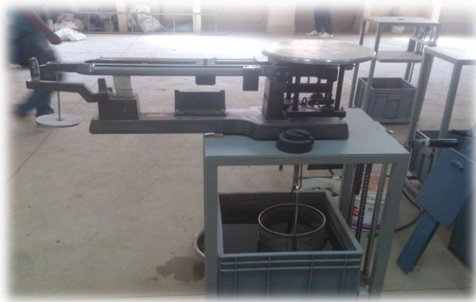
Imagen A.10: Obtención del peso sumergido.
