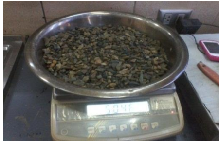
Imagen A.27: Pesaje del material retenido en el tamiz N° 4
