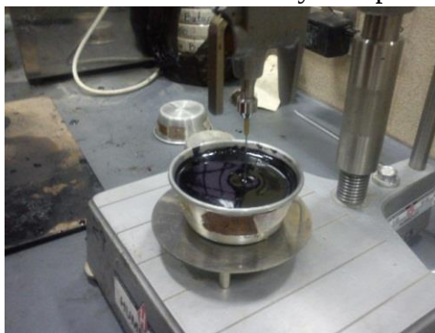
Imagen A.18: Realización del ensayo de penetración.
