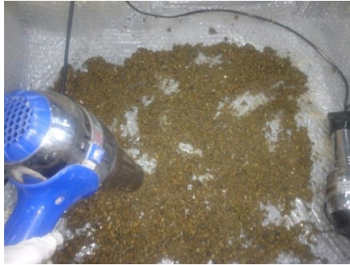
Imagen A.5: Secado superficial con secadora.
