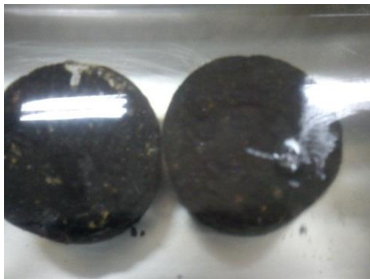
Imagen A.28: Briquetas en Baño María a 25°C por 5 min.
