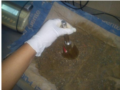
Imagen A.6: Verificación de la condición muestra saturada con superficie seca.
