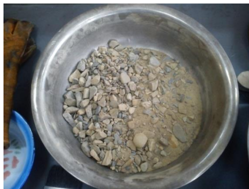
Imagen A.21: Agregados listos para adicionar a la mezcla bituminosa.
