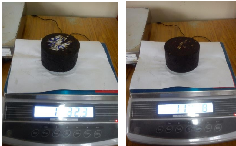
Imagen A.27: Pesaje de cada briqueta en su estado seco al aire libre.
