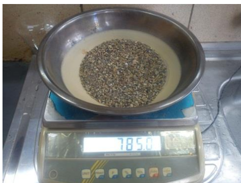
Imagen A.9 Obtención del peso de la muestra seca.
