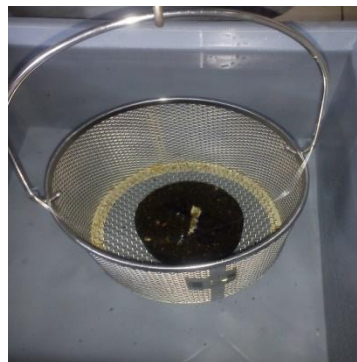
Imagen A.30: Determinación del peso sumergido en el agua.
