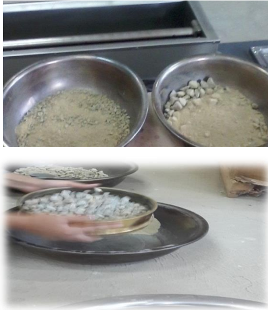
Imagen A.15: Pesaje de la muestra retenida en el tamiz N°12, después del lavado y secado en el horno.
