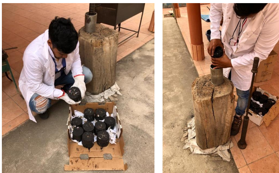
Imagen A.24: Compactación con martillo con 75 golpes por cara.
