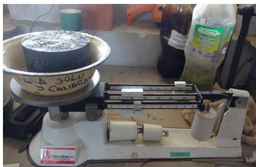
Imagen A.30: Determinación del peso sumergido en el agua.
