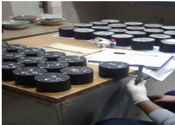
Imagen A.26: Medición de cada Briqueta
