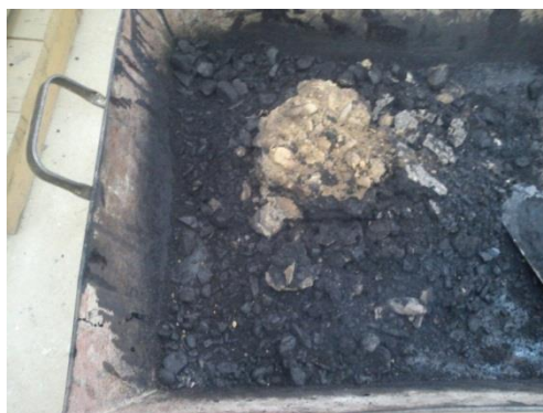
Imagen A.22: Mezcla del agregado pétreo con el cemento asfáltico con y sin Biomodificador
