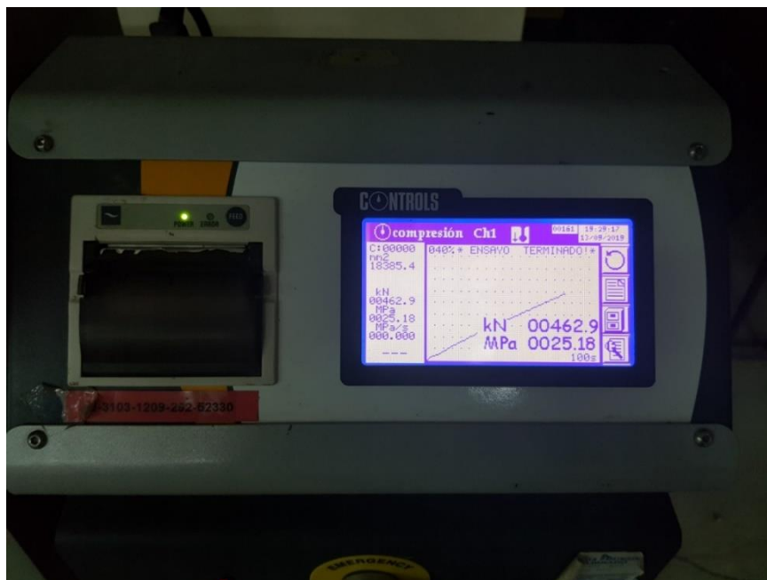
Figura 14. Rotura de probeta 25Mpa
