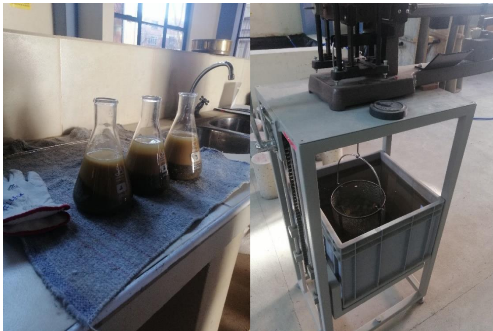
Figura 3. Ensayo de caracterización del material “Peso específico”
