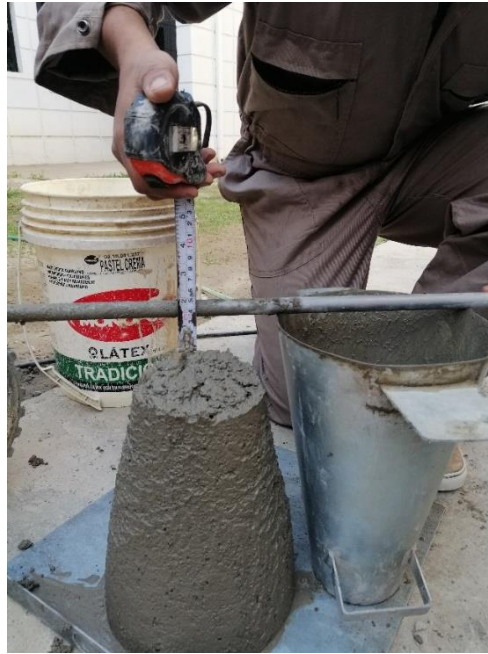
Figura 7. Prueba de revenimiento
