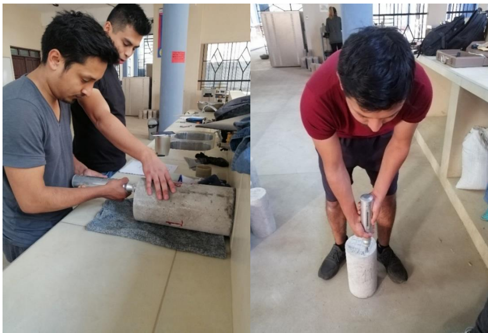
Figura 12. Ensayo de esclerometría en probetas
