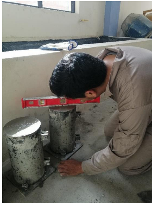
Figura 9. Control del nivel de probetas
