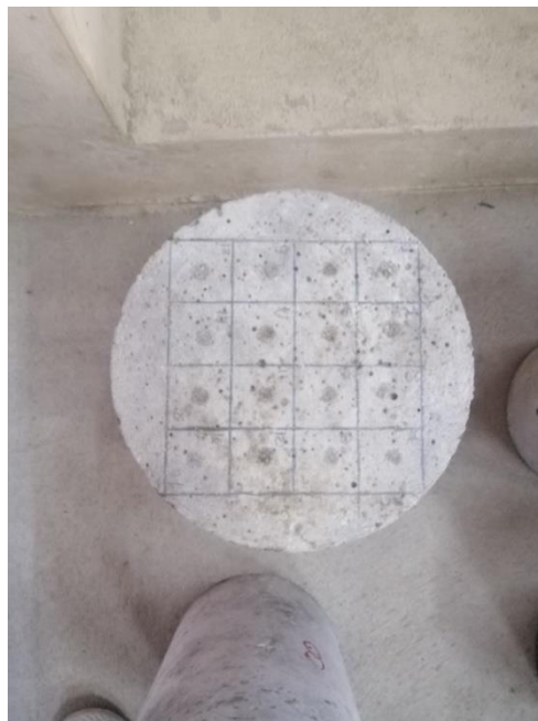
Figura 11. Cuadrantes de disparo del esclerómetro en probeta
