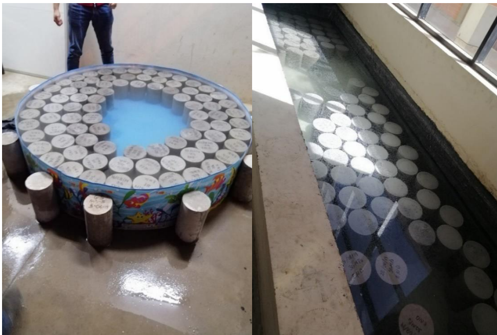
Figura 10. Curado de probetas por sumersión
