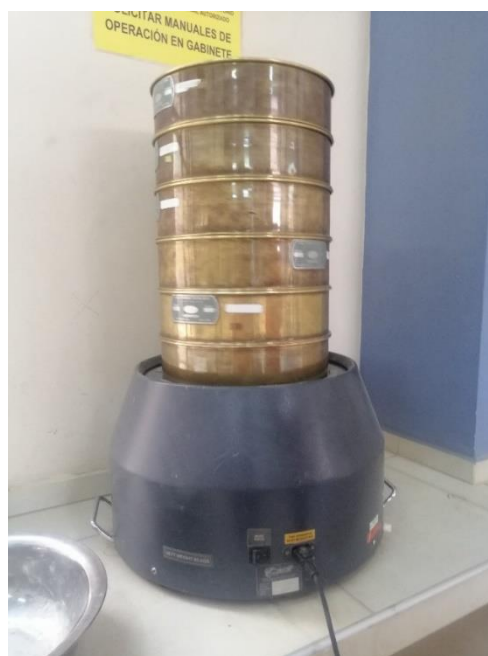
Figura 2. Ensayo de caracterización del material “Análisis de granulometría”
