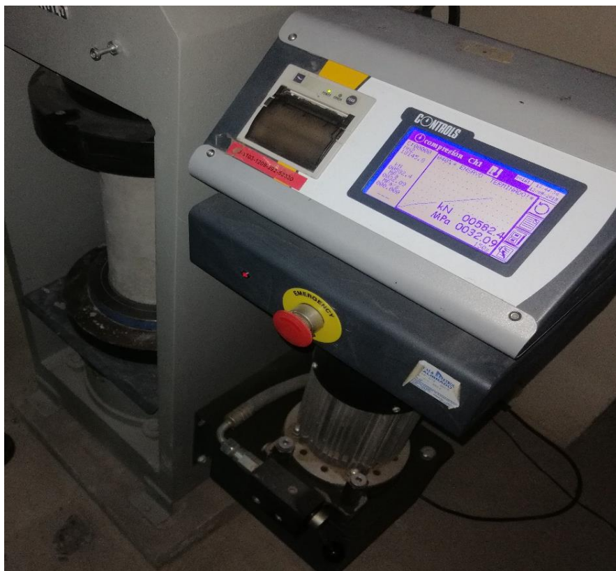
Figura 15. Rotura de probeta 30 Mpa
