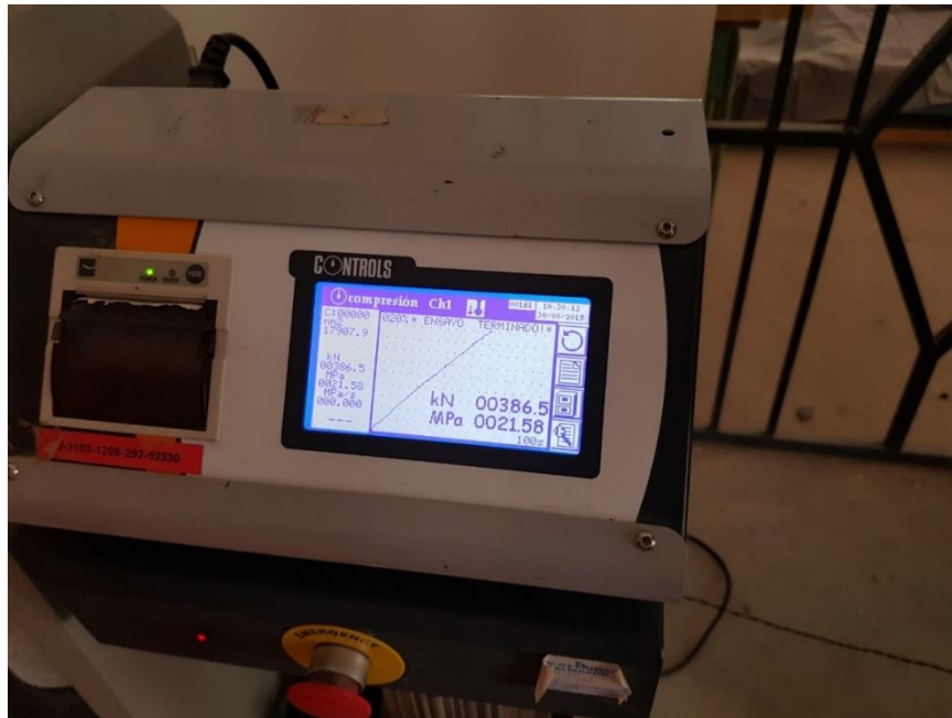
Figura 13. Rotura de probeta 21Mpa
