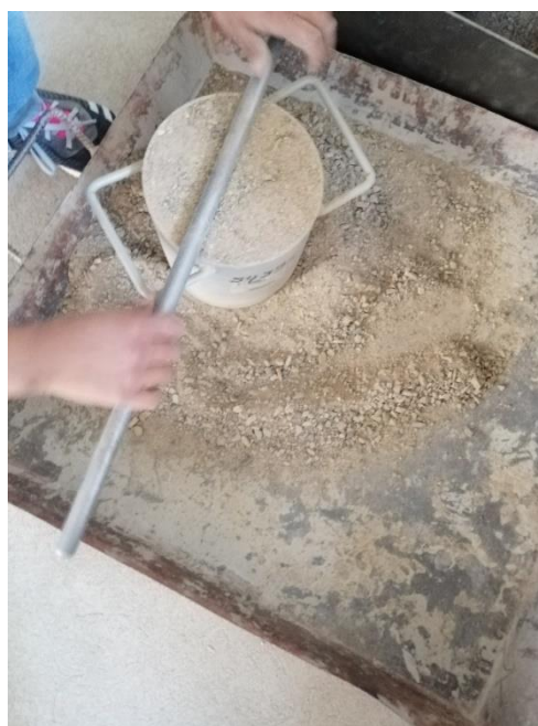
Figura 4. Ensayo de caracterización del material “Peso unitario”
