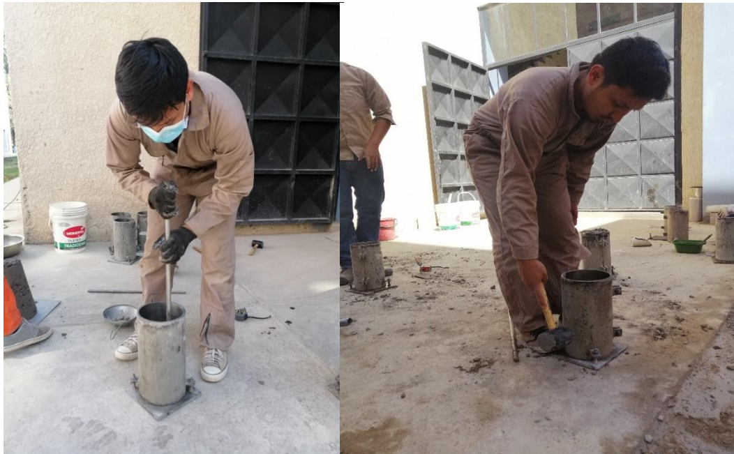
Figura 8. Elaboración de las probetas
