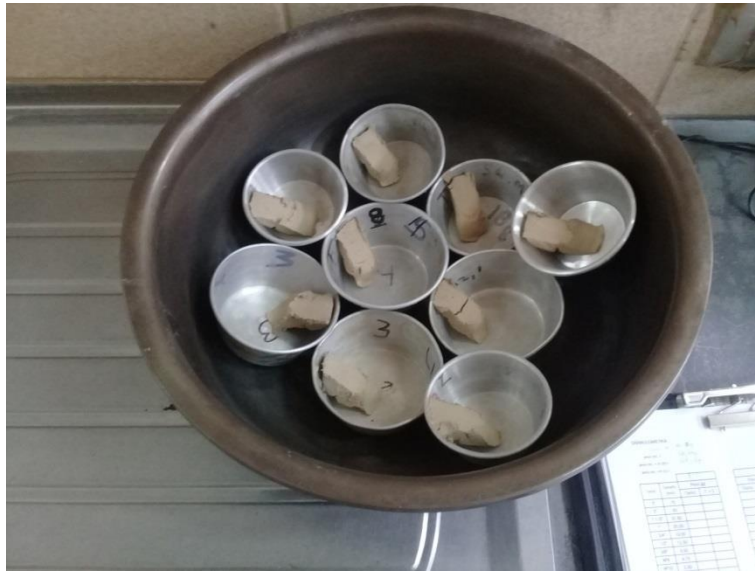
Muestras de suelo fino del límite líquido a ser llevadas al horno.
