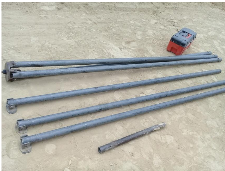
Conjunto de barras del trípode, herramientas generales y muestreador.
