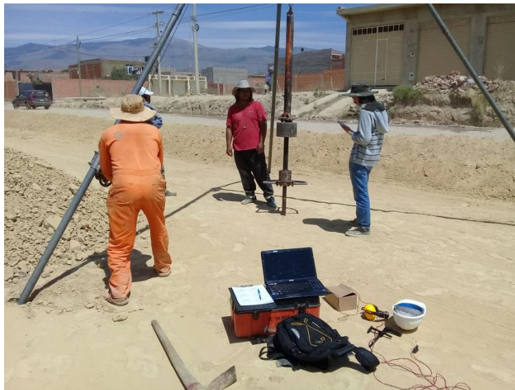
Preparación del dispositivo para ser colocado en el equipo de SPT.
