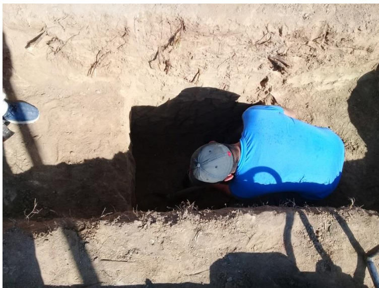
Extracción del muestreador y toma de muestra de suelo.
