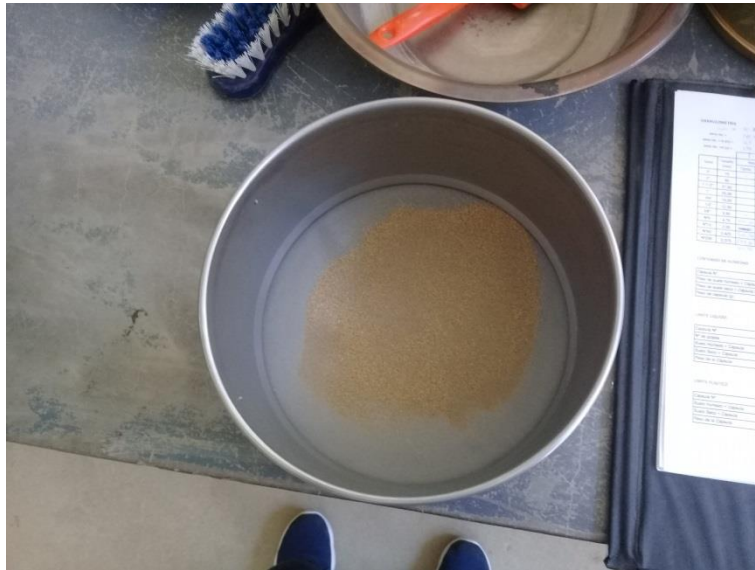
Muestra de suelo fino retenida en tamiz N° 200.
