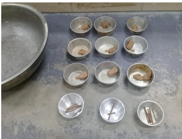
Muestras de suelo para ser llevadas al horno.
