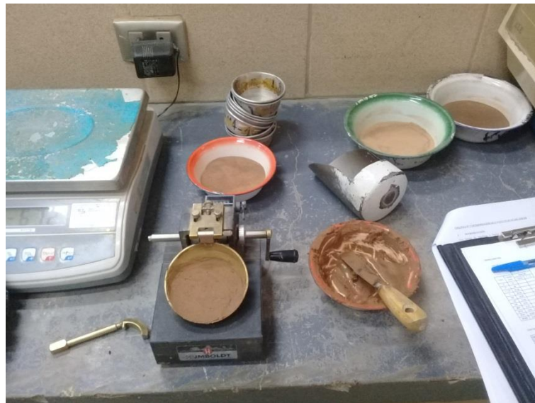
Equipo de Casagrande para la determinación de límite líquido.
