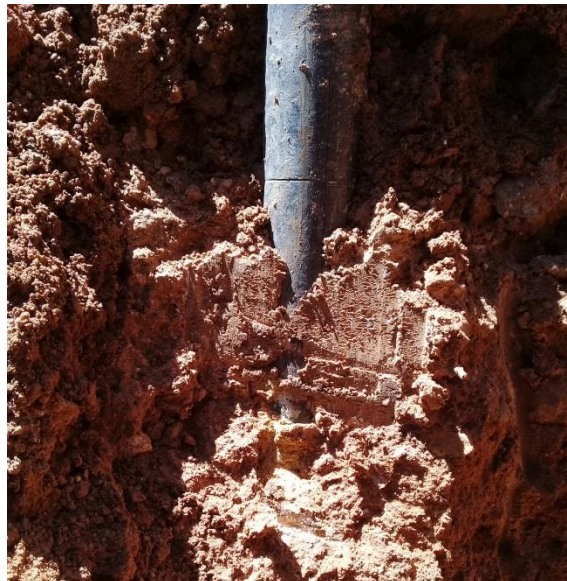
Extracción del muestreador del pozo C, para la profundidad de 3 m.
