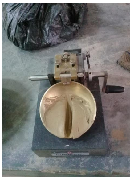
Muestra de suelo del área 3, en la copa de Casagrande.
