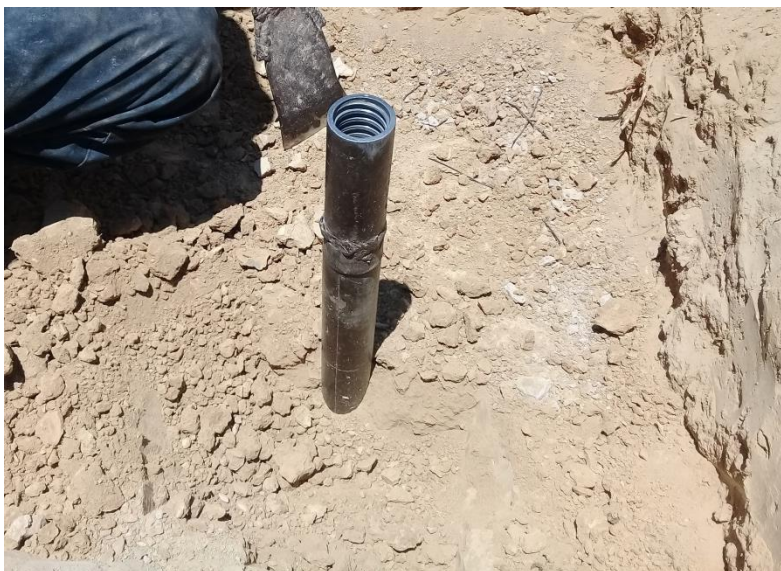
Extracción del muestreador.
