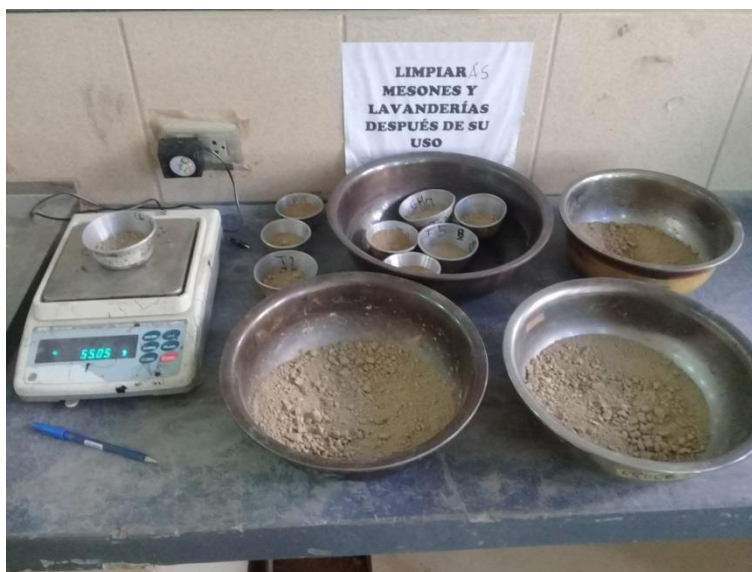
Preparación del suelo para tamizado y contenido de humedad.
