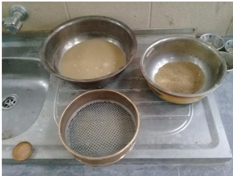
Método del lavado para suelos finos.
