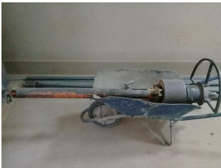
Equipo de SPT usado para los ensayos, perteneciente al laboratorio de suelos UAJMS.
