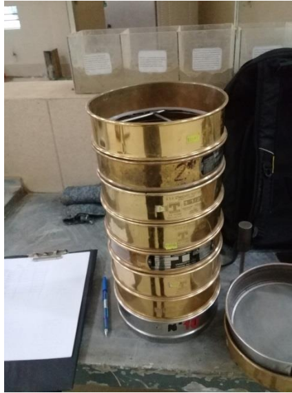
Preparación para el tamizado de las muestras de suelo.
