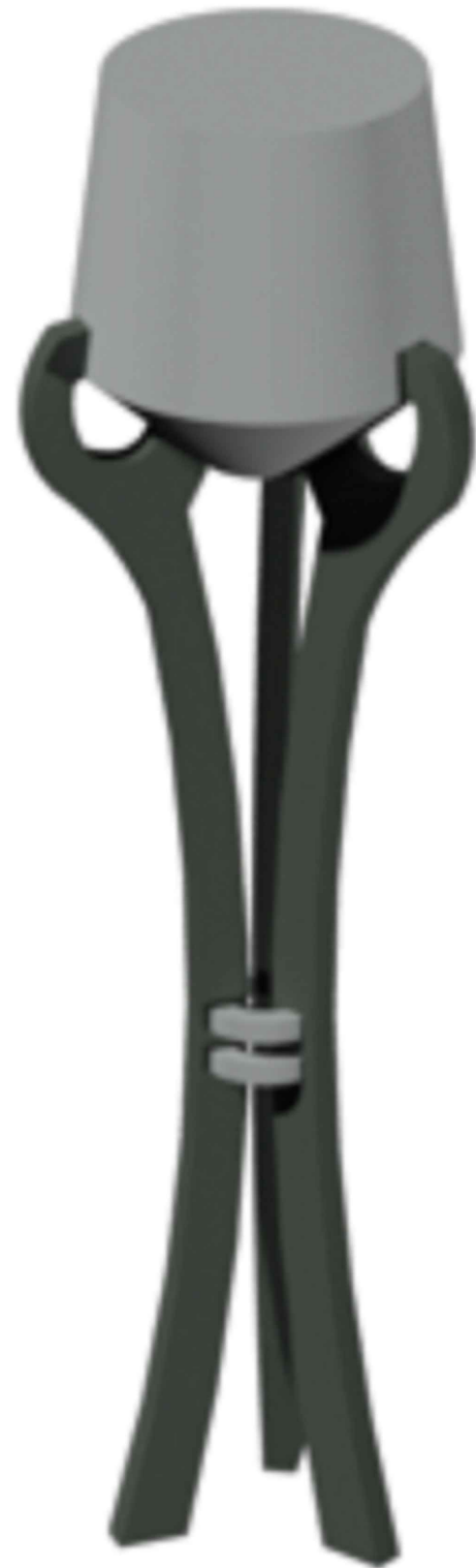
VISTA ISOMETRICA DEL TANQUE ELEVADO
