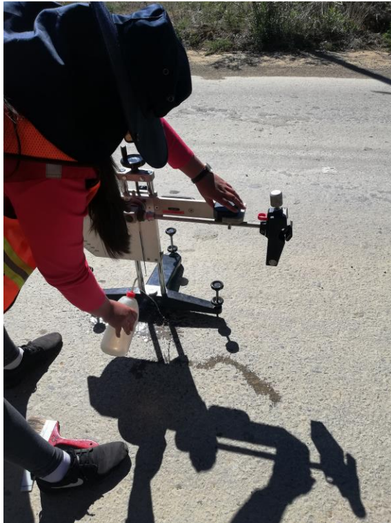
Aplicación del metodo del pendulo Britanico.
