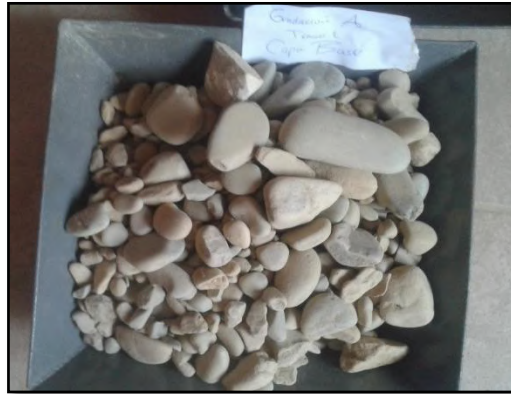
Figura 1. Material retenido en el tamiz 1 \parallel , \frac{3}{4} , \frac{1}{2} y \frac{3}{8}
