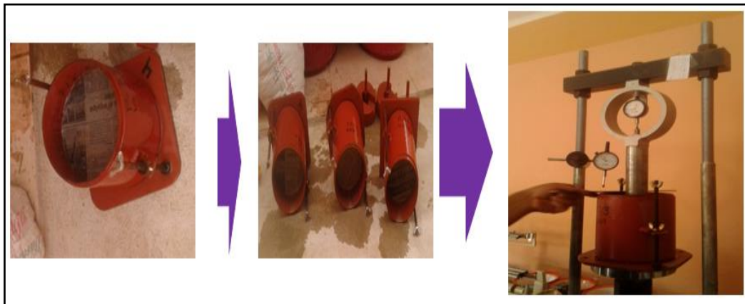
Figura 2. Determinación de la resistencia a la penetración
