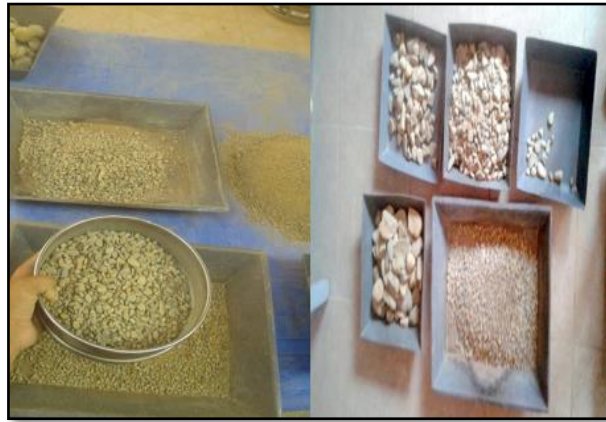
Figura 3. Proceso del tamizado del material
