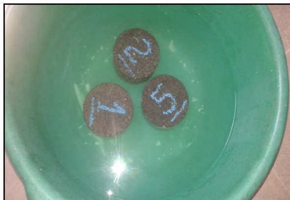
Figura 2. Briquetas en baño maría a 25°C por un mínimo de 10 min
