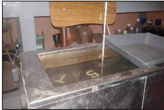
Figura 1. Briquetas en baño maría a 60°C por 35 minutos
