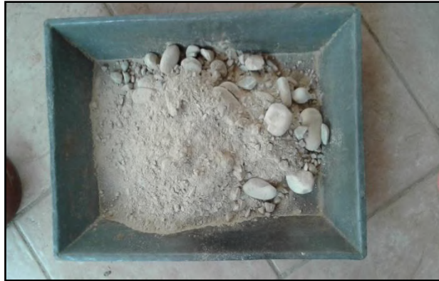
Figura 4. Material obtenido de la máquina de los Ángeles.
