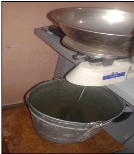
Figura 4. Determinación del peso sumergido en el agua
