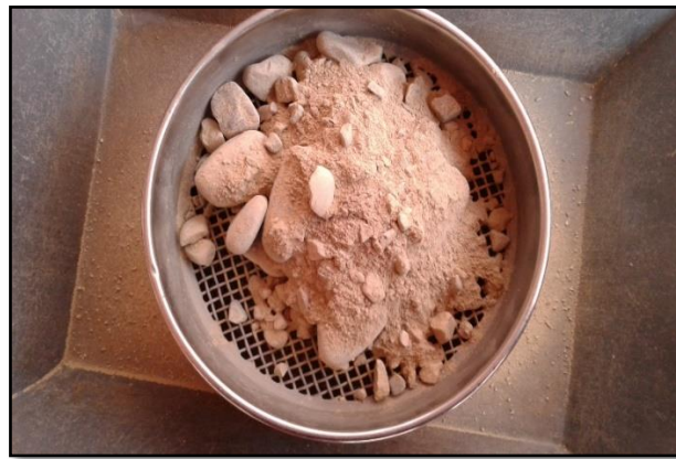
Figura 5. Tamizado de la muestra después del sacado de la máquina de los Ángeles.
