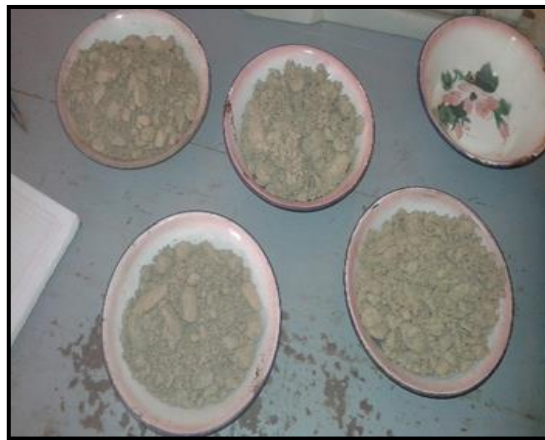
Figura 3. Muestras sacadas del horno para determinar el contenido el contenido de humedad.
