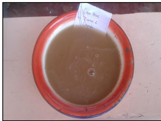
Figura 2. Material fino reposando en agua
