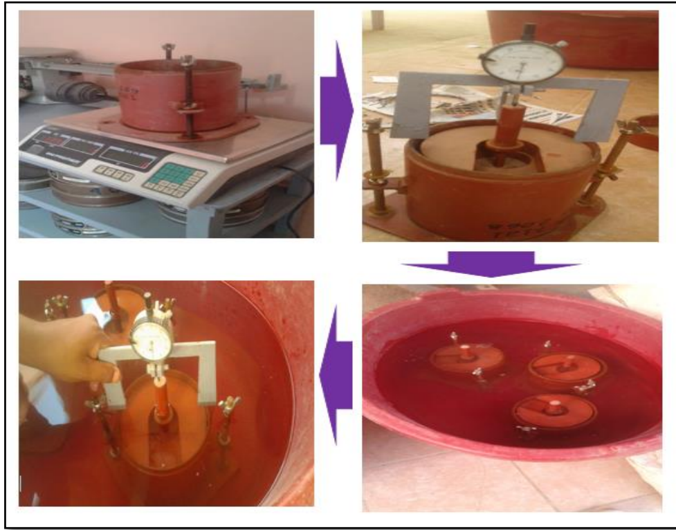
Figura 1. Determinación de la expansión del suelo
