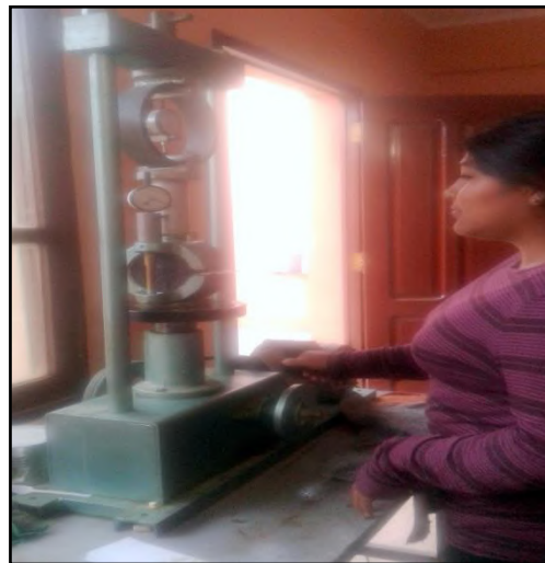
Figura 2. Lectura del dial de estabilidad (dentro del anillo de Marshall) y el dial de deformación para el flujo
