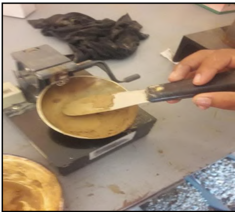
Figura 6. Muestra horizontal (equipo Casagrande)
