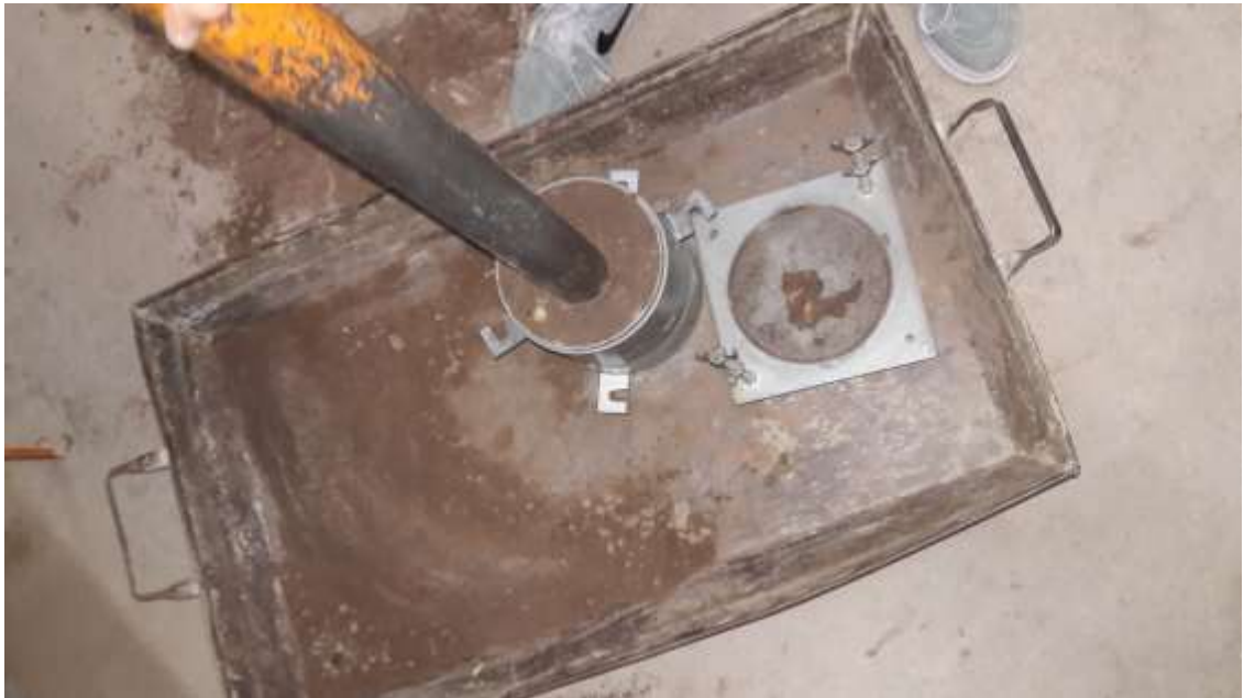
27. Ensayo Proctor Modificado.
