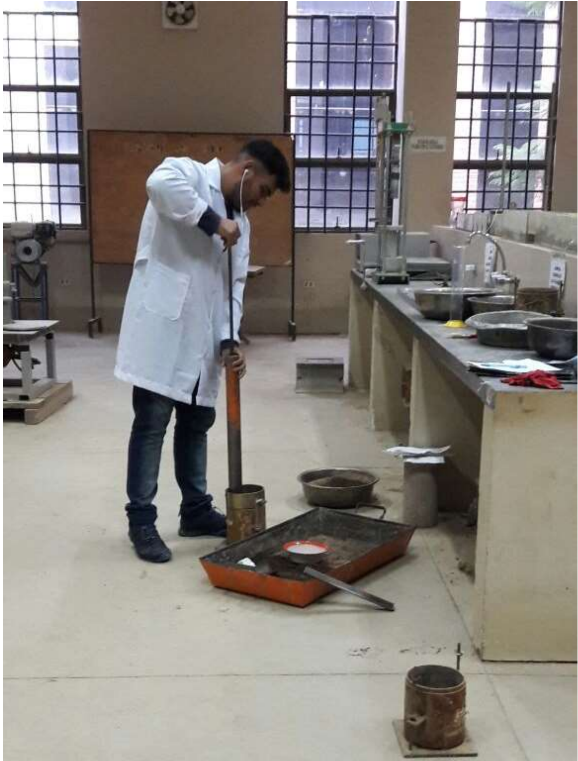
33. Univ. Mogro Sánchez José Mauricio haciendo ensayo de Compactación en laboratorio de suelos de la UAJMS.
