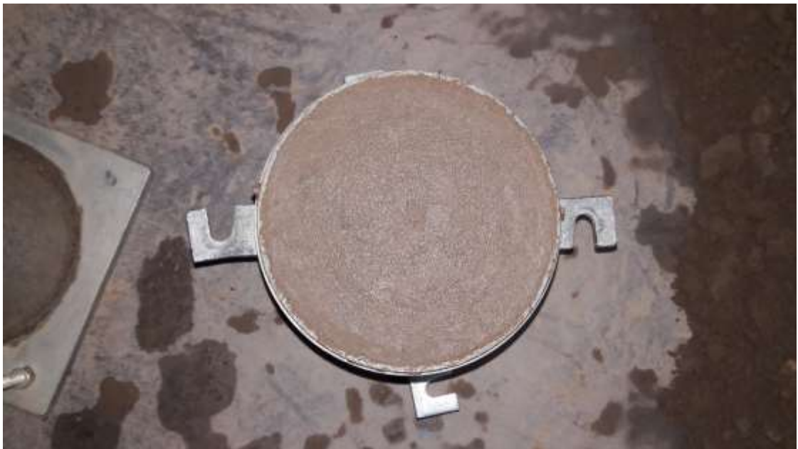
28. Ensayo de CBR
