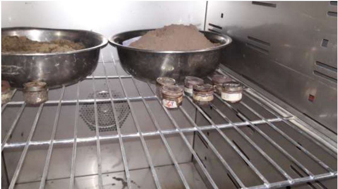
23. Estudio de suelos, secado de muestra y obtención de contenido de humedad.
