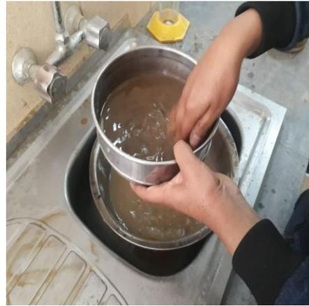
Lavado de muestra para granulometría método de lavado
