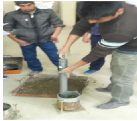
Fotografía N°31. Compactación al 100% 56 golpes
