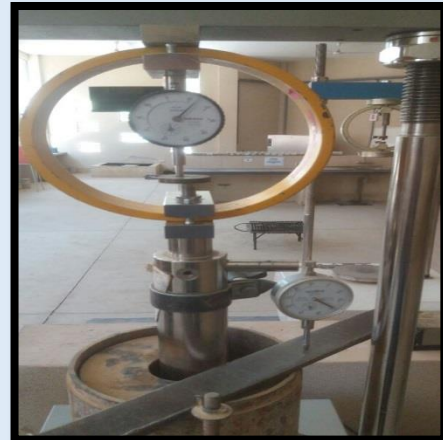
Fotografía N°33. Penetración de muestra de suelo después de la saturación 4 días
