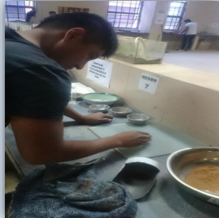
Fotografía N°24. Determinación del límite plástico.
