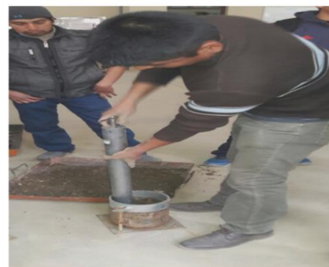
Fotografía N°27. Compactación 56 golpes por capa
