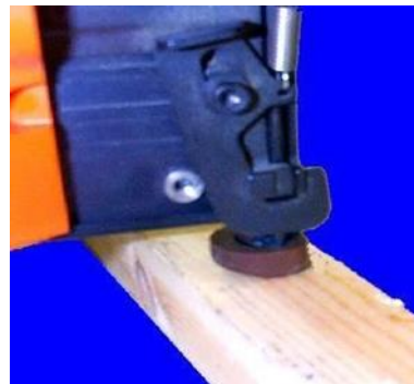
Imagen N°9 Boquilla en contacto con el trabajo
