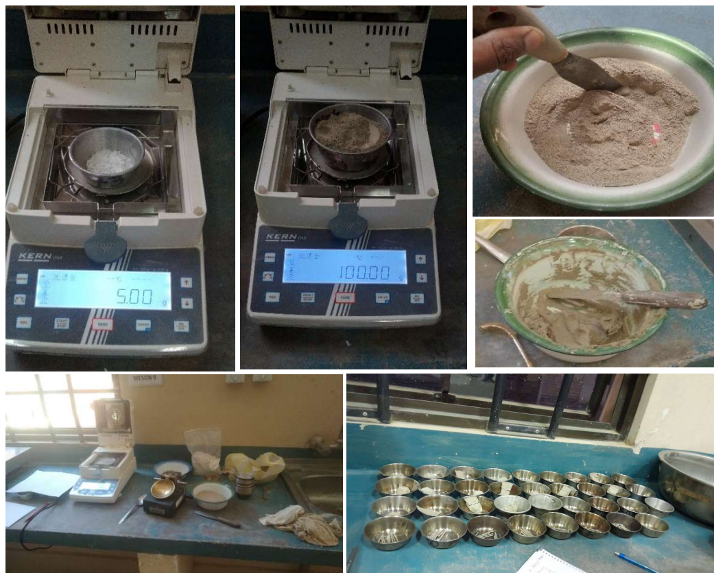
Figura 3.24: Preparación de la muestra y ensayos de límite líquido y plástico
