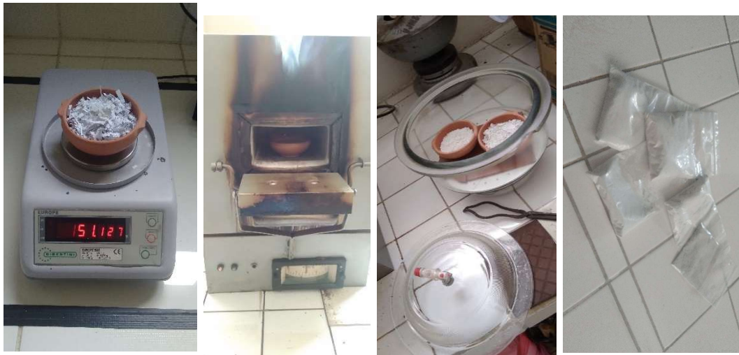
Figura 3.4: Obtención de la ceniza de papel
