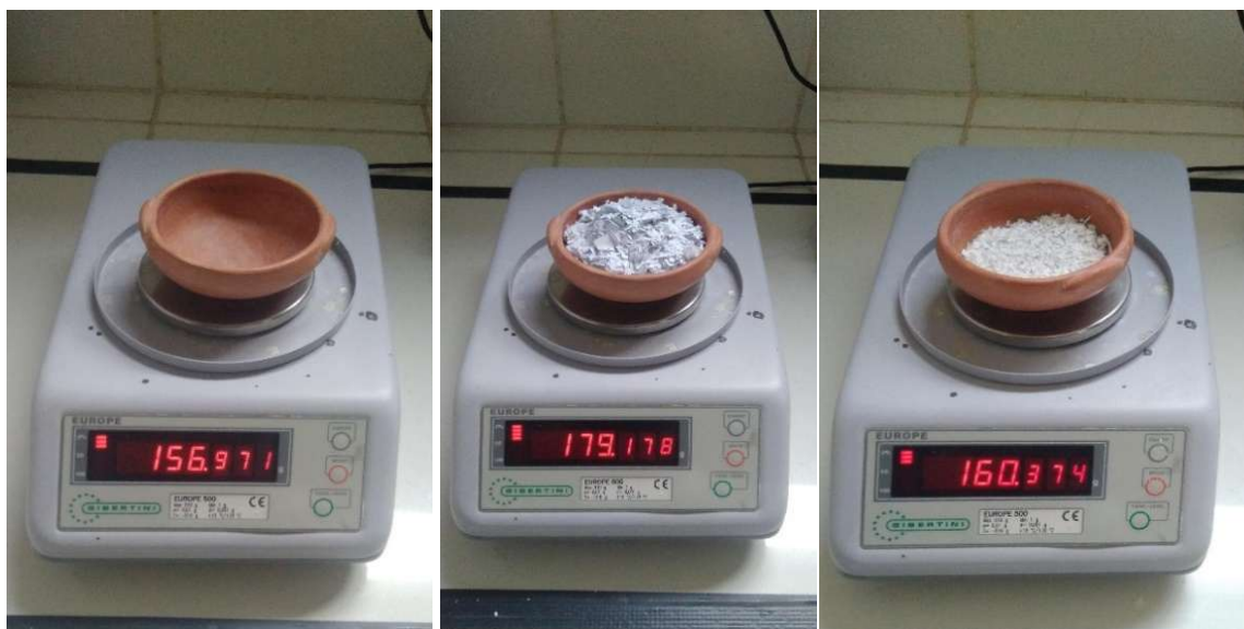
Figura 3.18 Reducción por calcinación
