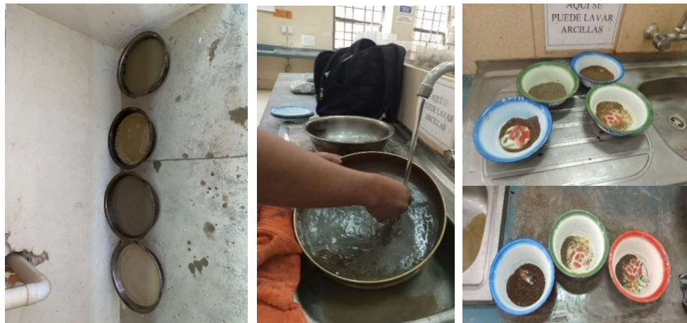
Figura 3.9: Lavado por el tamiz #200 de arcillas de baja compresibilidad
