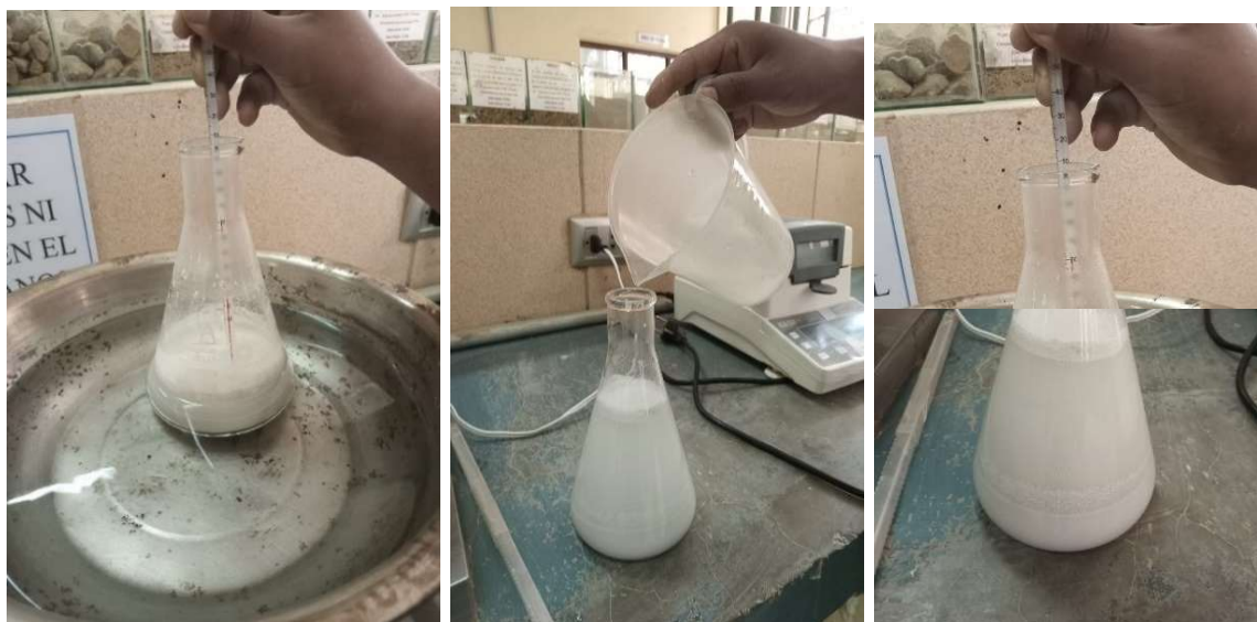
Figura 3.19: Peso específico de la ceniza de papel
