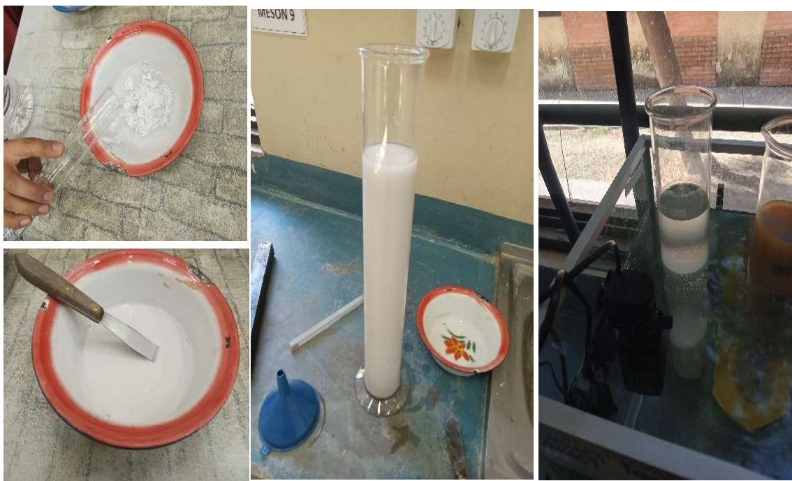
Figura 3.21: Hidrometría con 152 H para "CP"
