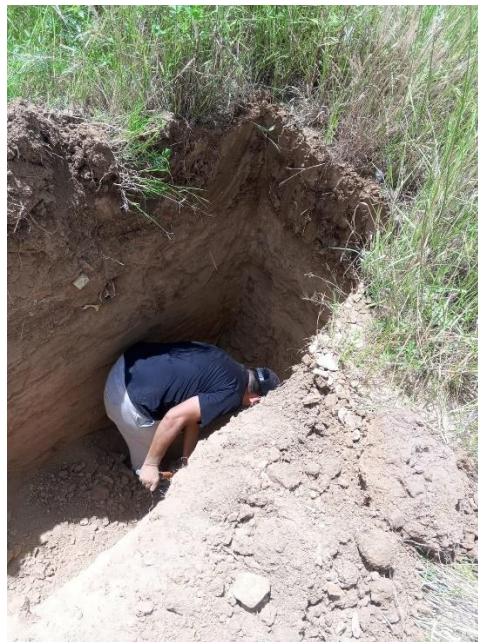
Figura 20. Extracción de la muestra inalterada a 2 metros de profundidad.
