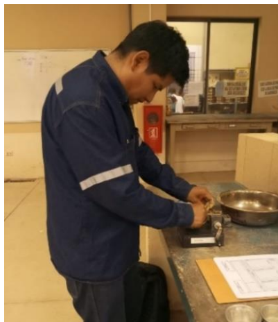
Figura 31. Equipo de casa grande para ensayo de límite líquido
