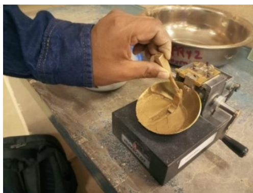
Figura 32. Equipo de casa grande para ensayo de límite líquido
