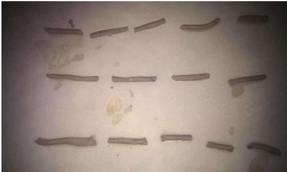
Formacion de hilos de aproximadamente 3mm de diámetro para determinar el limite plástico con el criterio de quiebre.
