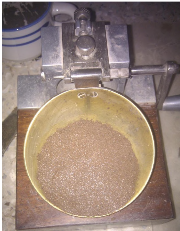
Dispositivo Casagrande, para determinar el limite liquido.
