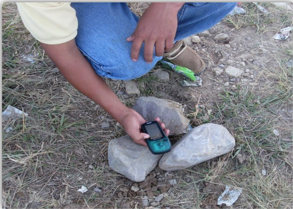
Uso de GPS, para determinar puntos y coordenadas en el levantamiento topográfico.
