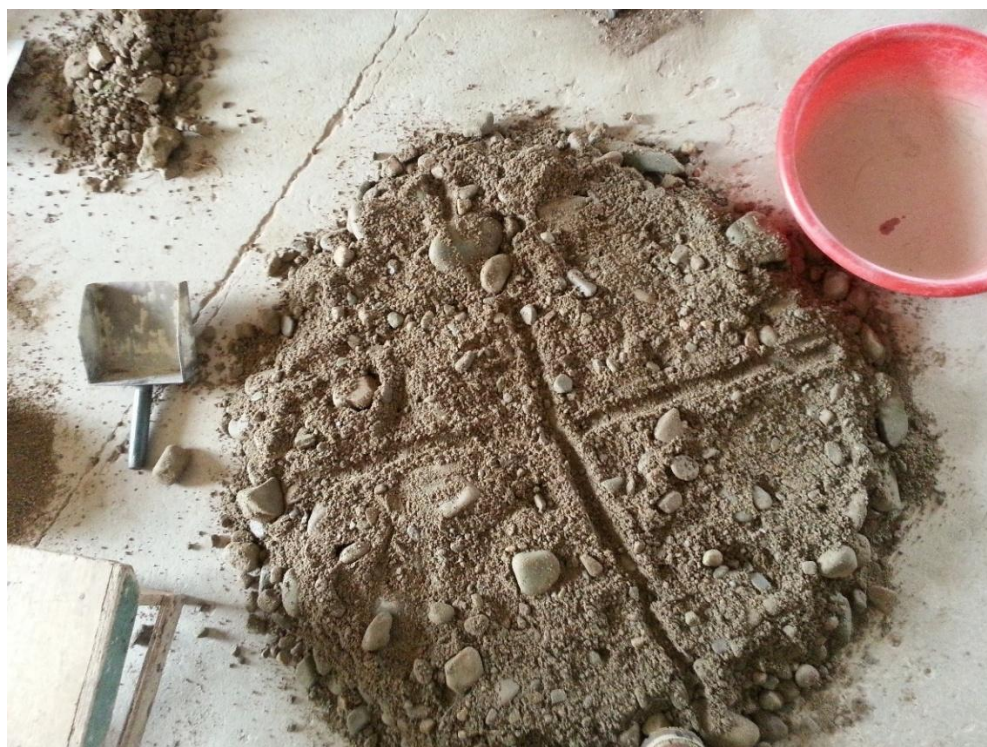
Extendido y cuarteo de las muestras de material para realizar los trabajos de gabinete.
