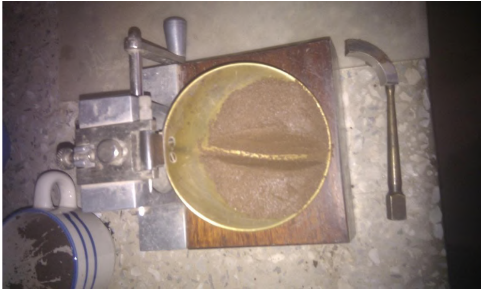
Dispositivo Casagrande, para determinar el limite liquido.
