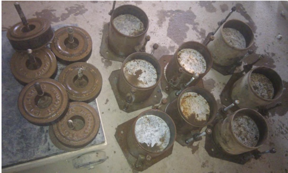
Moldes de CBR sacados de la saturación para empezar a realizar el ensayo de penetración.
