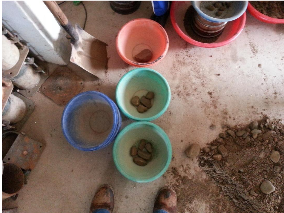
Tamizado a travez de tamices metalicos para su correspondiente clasificacion y analisis.
