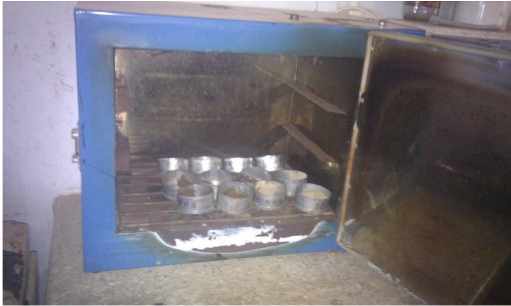
Procedimiento de secado en el horno de muestras para determinar el contenido de humedad.
