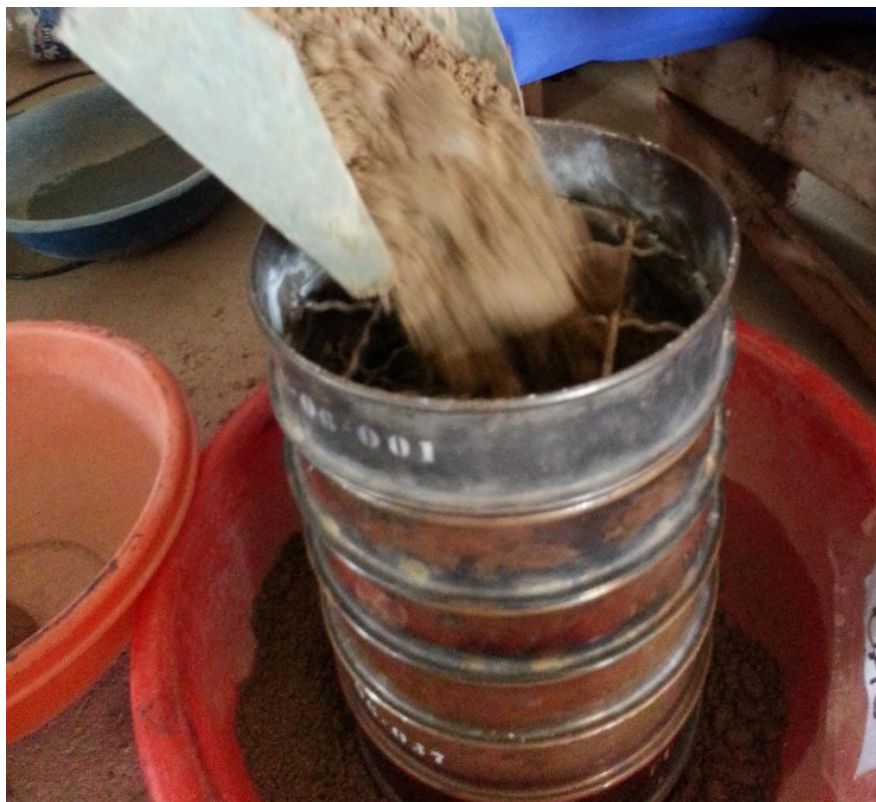
Tamizado a travez de tamices metalicos para su correspondiente clasificacion y analisis.
