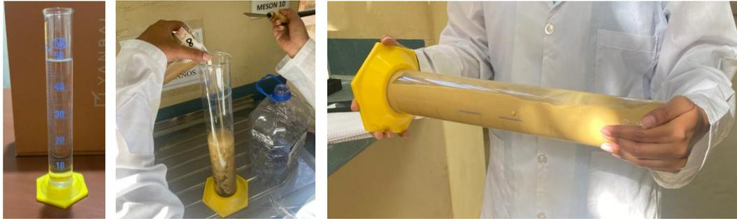
Preparación de la muestra con defloculante y agua destilada
