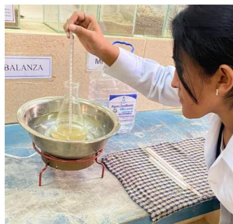
Llenado hasta los 250ml a una temperatura de 60°C
