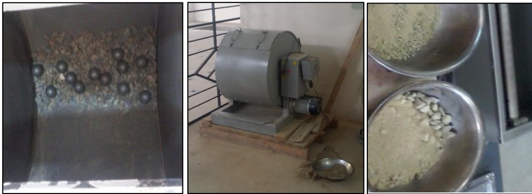
Figura 3.10. Colocado de la muestra en la máquina de los ángeles y obtención de muestra post rodillo giratorio
