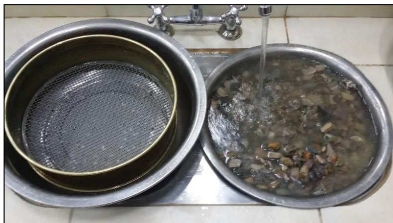
Figura 3.5. Lavado de la muestra para granulometría
