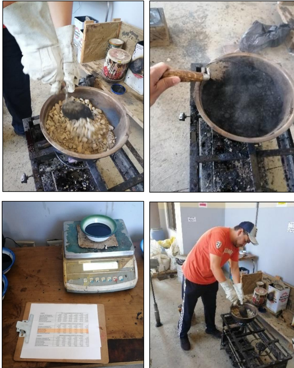
Figura 3.15. Elaboración de mezcla asfáltica aditivada según calculo
