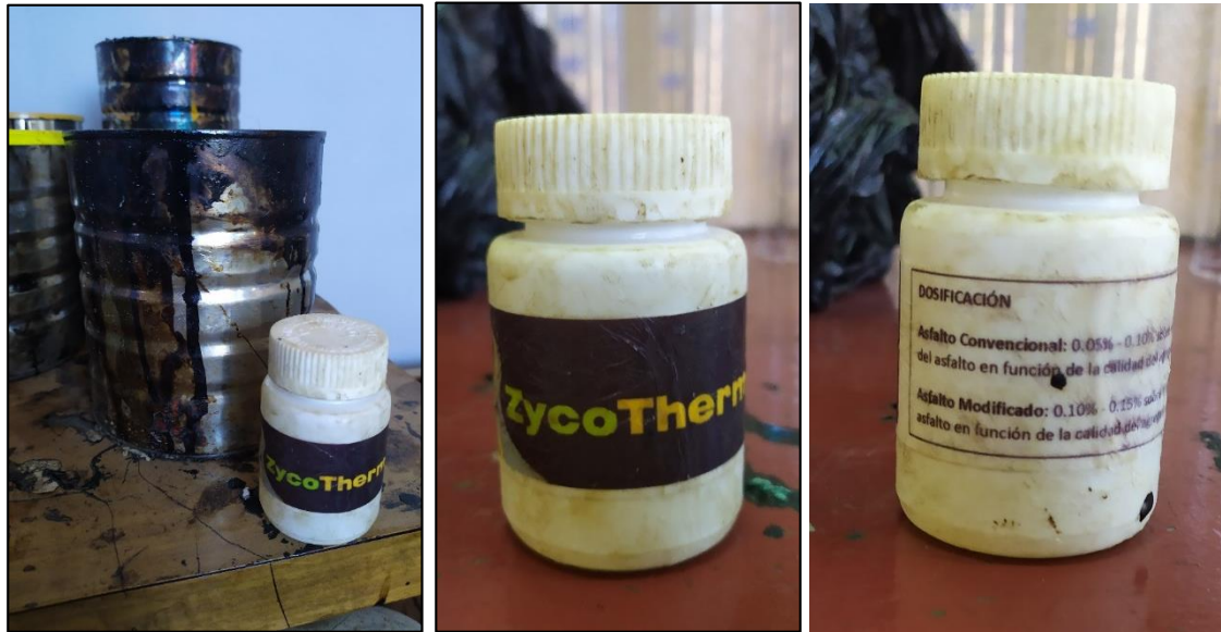
Figura 2.10. Aditivo multipropósito Zycotherm (presentación de laboratorio)
