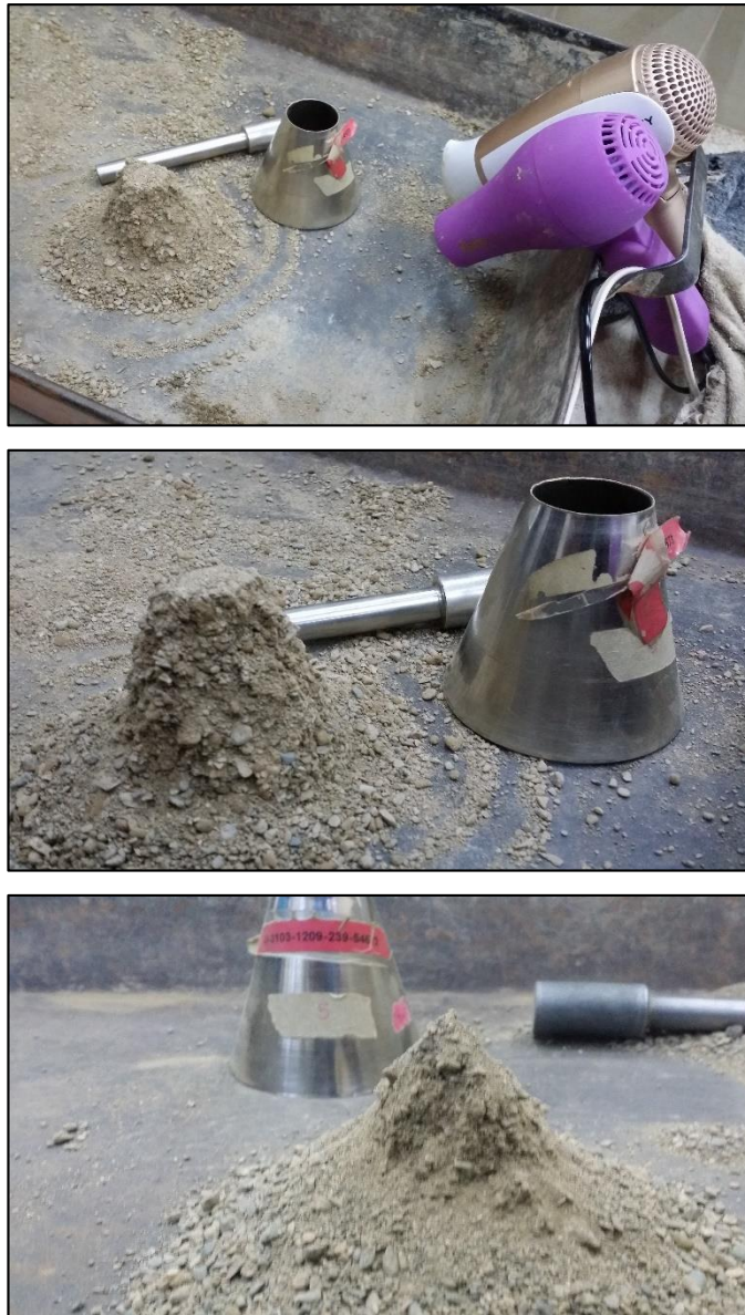
Figura 3.8. Verificación de la condición muestra saturada con superficie seca
