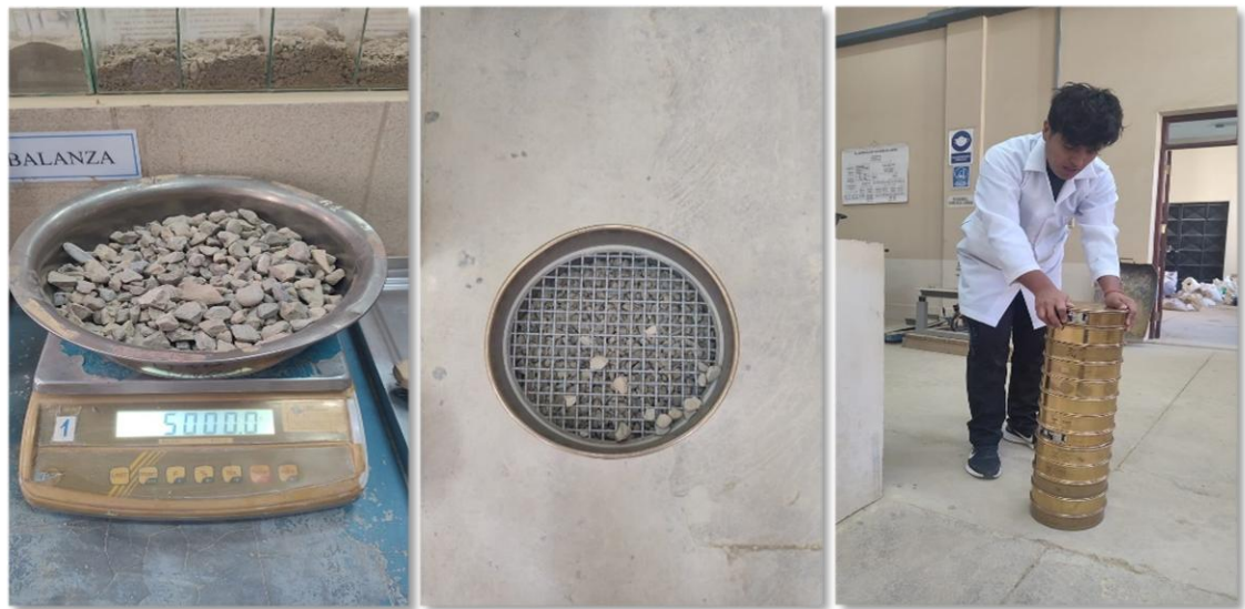
Figura 3.9. Proceso de tamizado de los agregados pétreos
