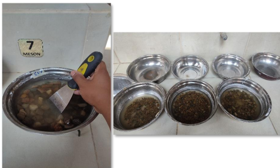
Figura 3.19. Proceso de saturación de los agregados
