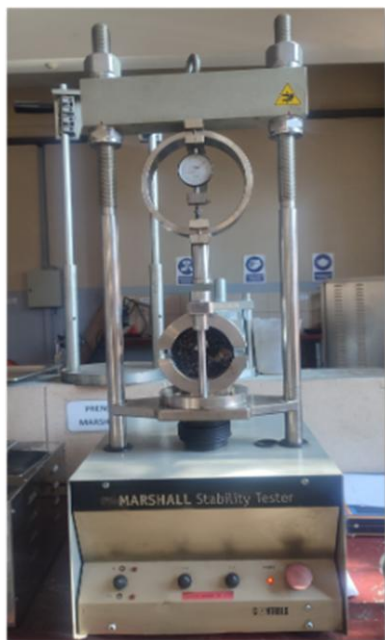
Figura 2.11. Aparato de Marshall para determinar la estabilidad y fluencia
