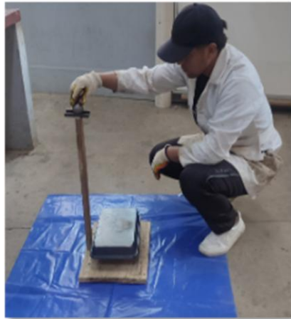
Figura 2.12. Ensayo del Vialit
