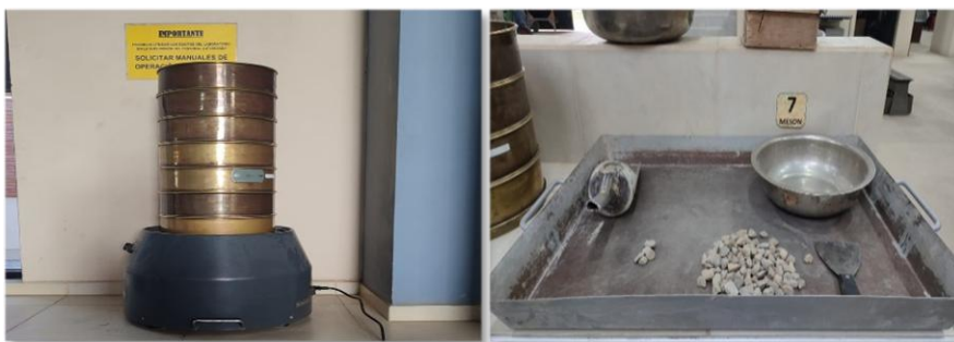
Figura 3.18. Determinación de las partículas que presentan caras fracturadas
