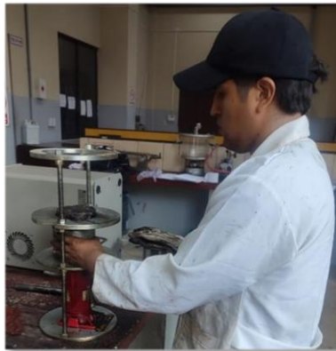
Figura 3.32. Desmoldado de las briquetas
