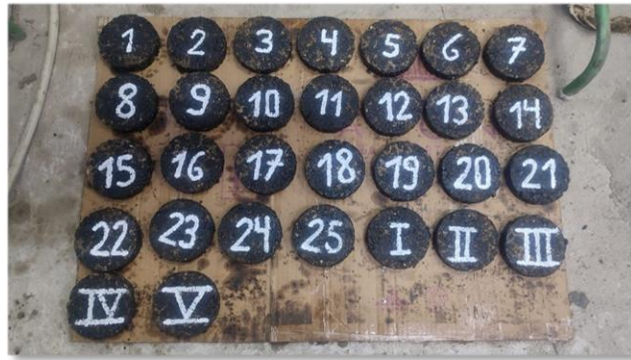
Figura 3.34. Briquetas de tratamiento doble modificado
