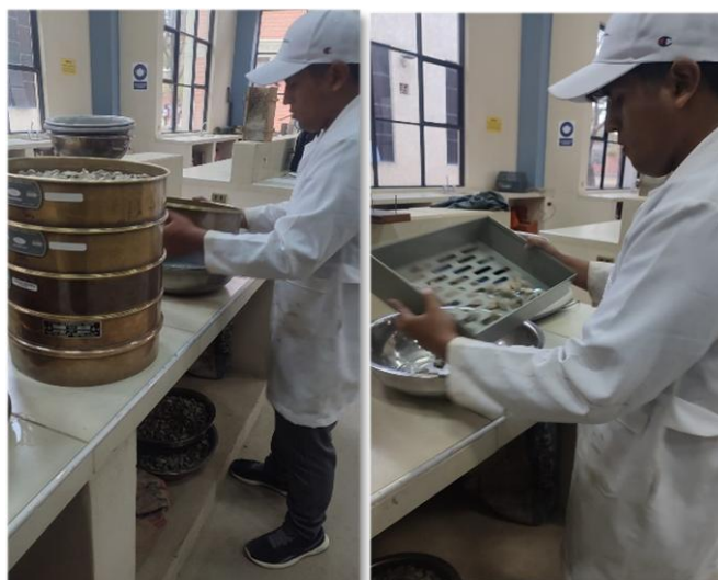
Figura 3.14. Determinación de las partículas planas de los agregados
