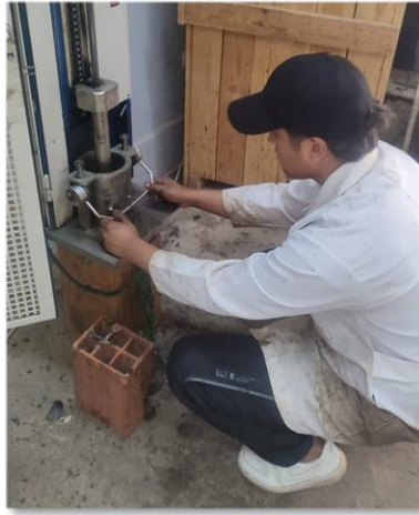
Figura 3.31. Proceso de compactación de las briquetas
