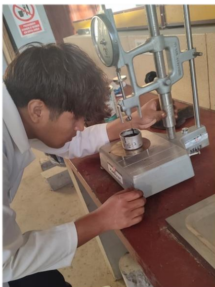
Figura 3.30. Determinación de la penetración del asfalto modificado
