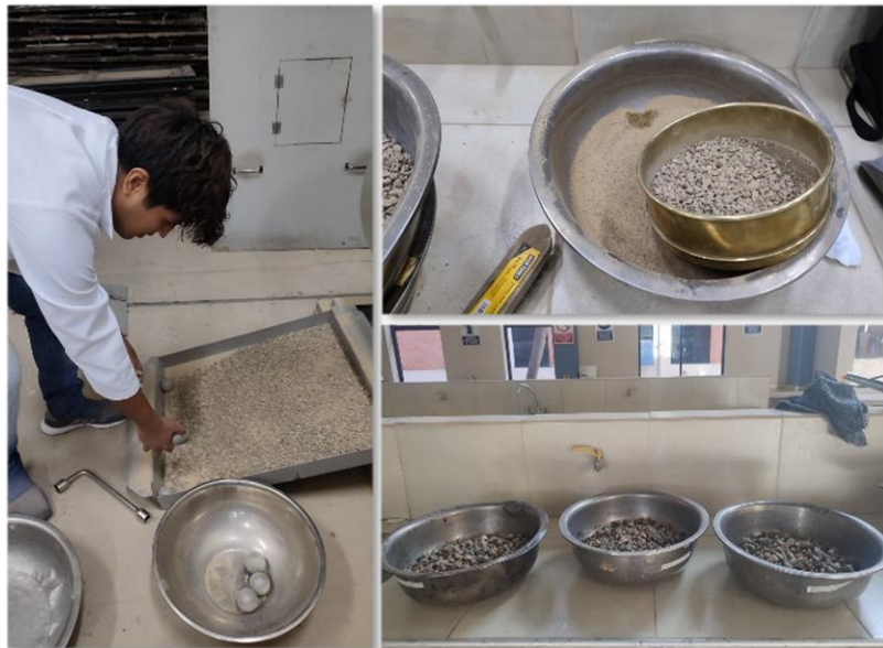
Figura 3.17. Proceso por desgaste por medio de la máquina de los ángeles
