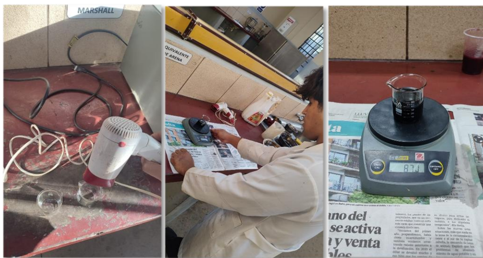
Figura 3.24. Proceso para el pesaje del picnómetro más el asfalto
