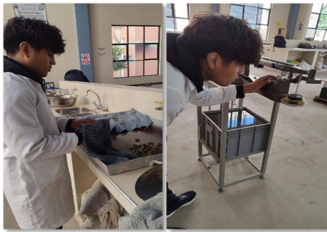
Figura 3.12. Determinación de la masa superficialmente seca y sumergida
