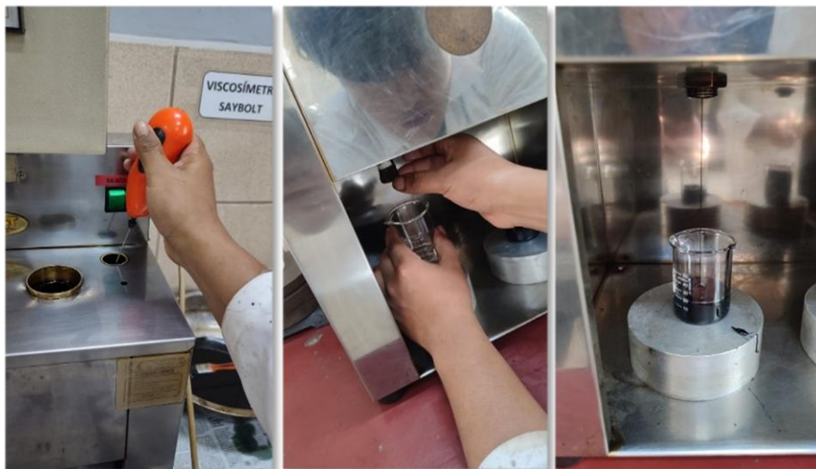
Figura 3.25. Determinación del tiempo de flujo
