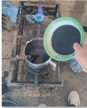
Figura 3.6. Asfalto modificado con polvo de neumático
