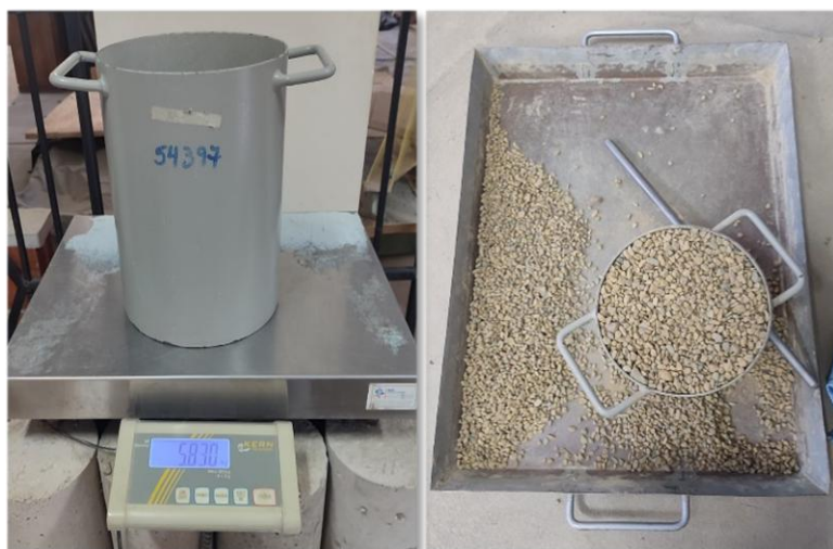
Figura 3.13. Ensayo del peso unitario del agregado
