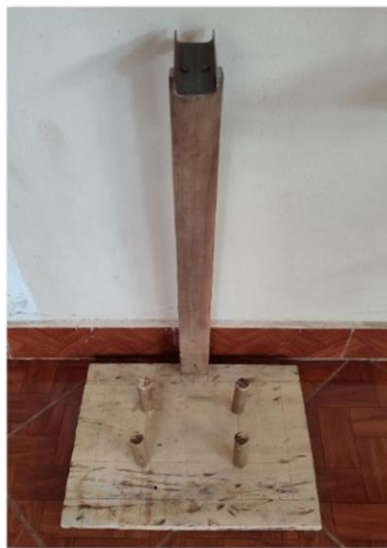
Figura 3.42. Dispositivo del ensayo de Vialit
