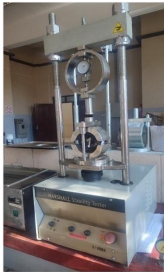
Figura 3.35. Determinación de la estabilidad y fluencia
