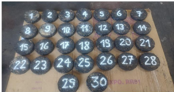
Figura 3.33. Briquetas de tratamiento doble convencional
