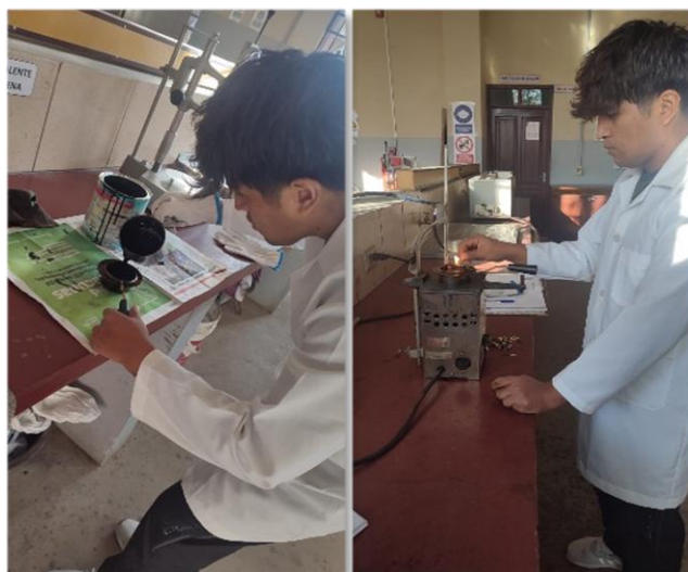
Figura 3.21. Determinación de la temperatura de punto de inflamación
