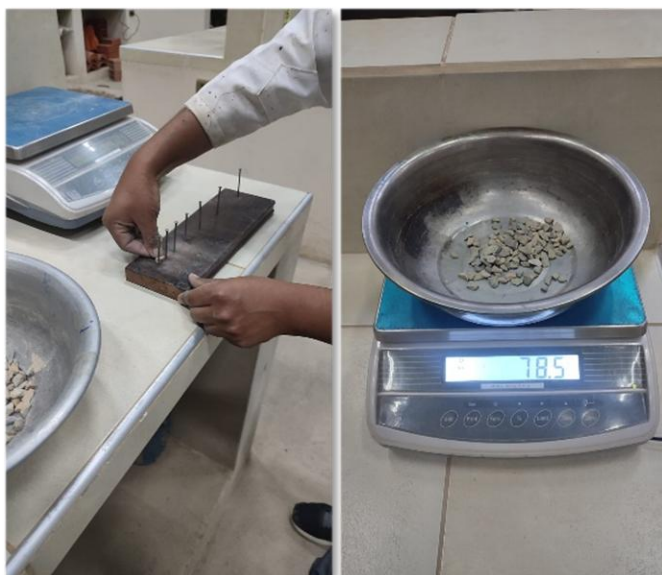
Figura 3.15. Determinación de las partículas alargadas de los agregados
