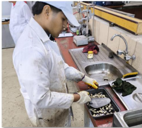
Figura 3.43. Distribución del agregado en el ensayo de Vialit
