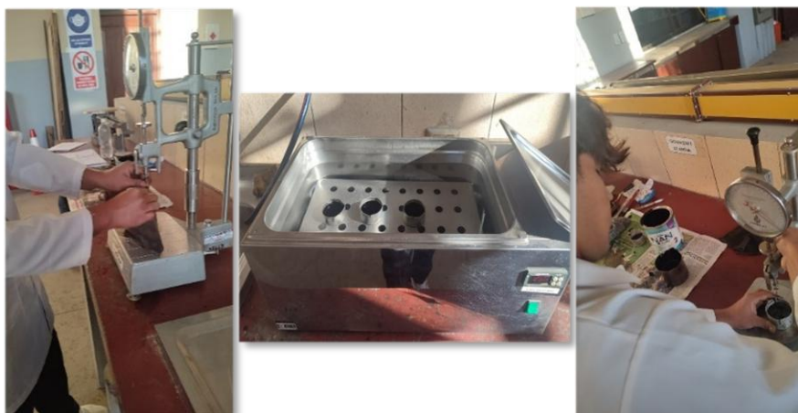
Figura 3.20. Proceso para la determinación de la penetración
