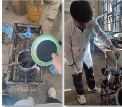
Figura A.3.16. Elaboración del asfalto modificado por vía húmeda
