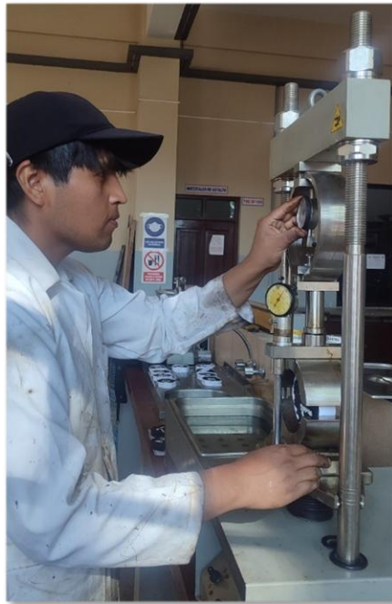
Figura A.3.22. Rompimiento de las briquetas del Marshall
