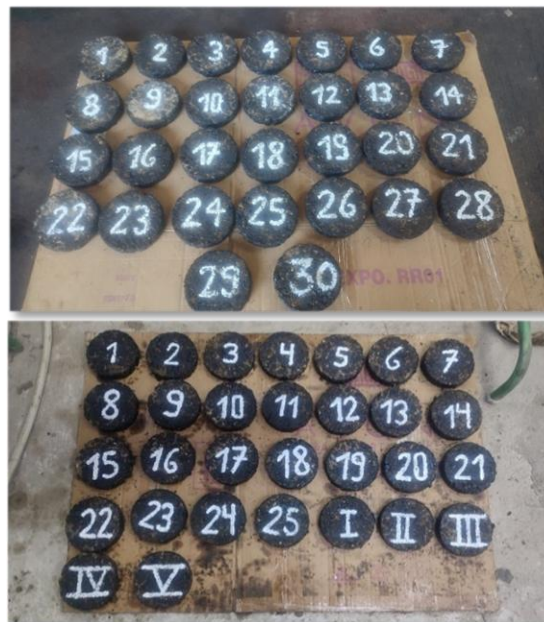
Figura A.3.18. Briquetas de tratamiento doble con asfalto convencional y asfalto modificado con polvo de neumático
