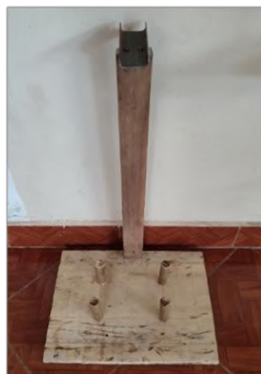
Figura A.3.30. Esquema del dispositivo de Vialit
