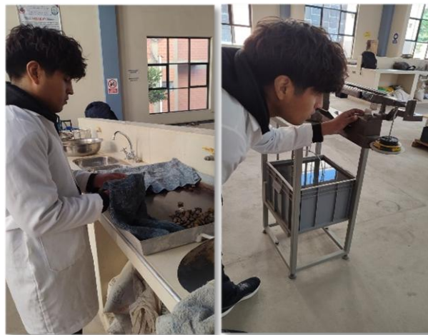
Figura A.1.5. Ensayo de peso específico del agregado grueso
