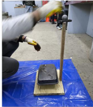
Figura A.3.37. Determinando las características adhesivas de los materiales del tratamiento superficial doble
