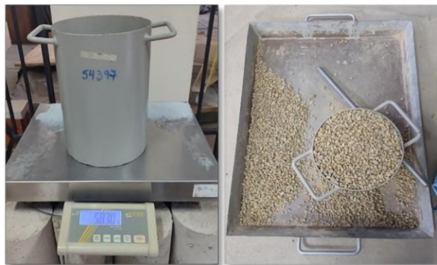
Figura A.1.7. Ensayo de peso unitario de los agregados gruesos
