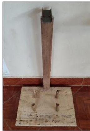
Figura A.3.35. Dispositivo de Vialit fabricado
