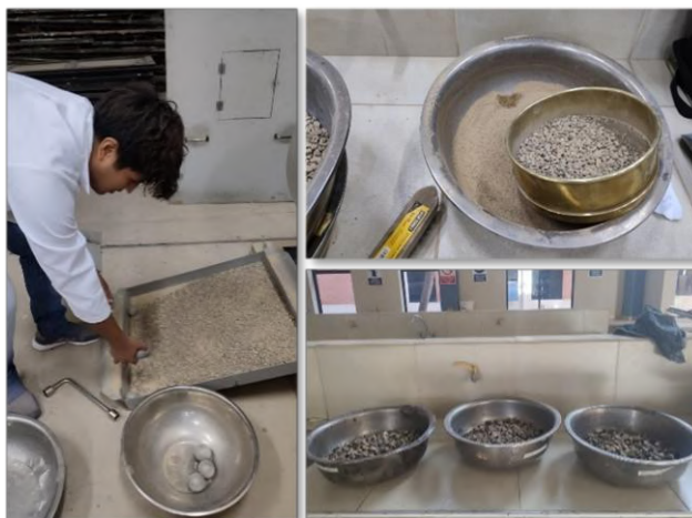
Figura A.1.11. Ensayo de desgaste por medio de la máquina de los ángeles
