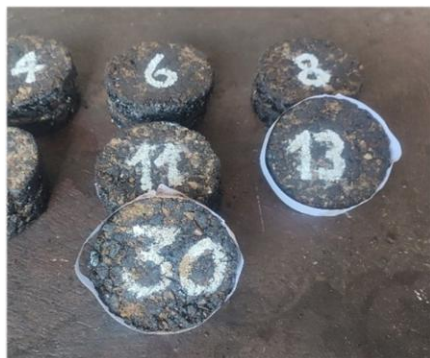
Figura A.3.23. Briquetas sometidas a la carga de rotura
