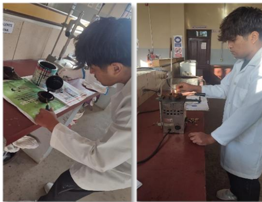
Figura A.2.4. Ensayo de punto de inflamación
