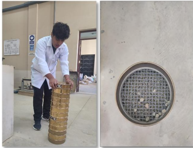
Figura A.1.3. Ensayo de la granulometría de los agregados
