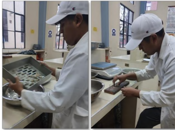
Figura A.1.9. Ensayo de índice de aplanamiento y alargamiento de los agregados
