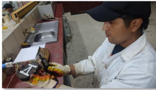
Figura A.3.19. Determinación de la altura de las briquetas de tratamiento doble
