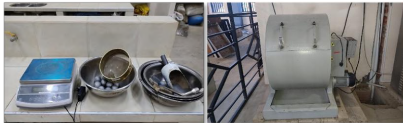
Figura A.1.10. Materiales del ensayo de desgaste de los Ángeles
