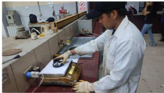
Figura A.3.20. Determinación del peso en seco de las briquetas de tratamiento doble
