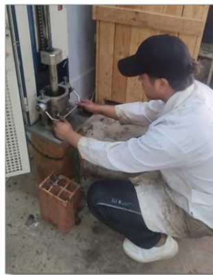
Figura A.3.1. Compactación de las briquetas de tratamiento doble
