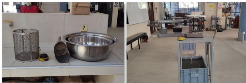
Figura A.1.4. Materiales del ensayo de peso específico y absorción de agua
