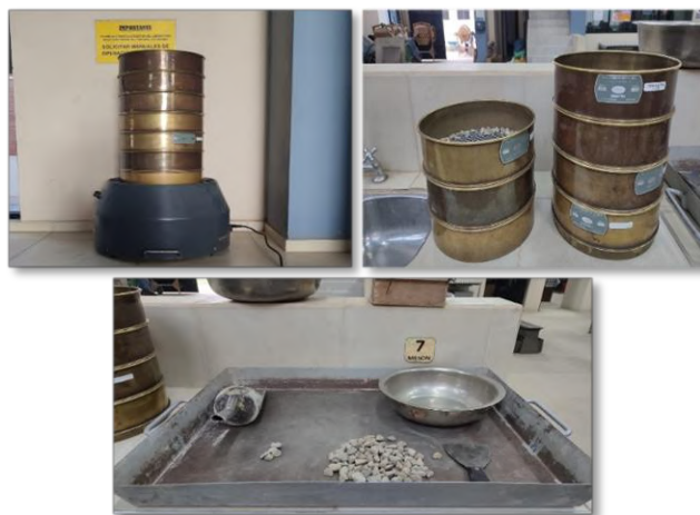
Figura A.1.13. Ensayo del porcentaje de caras fracturadas de los agregados
