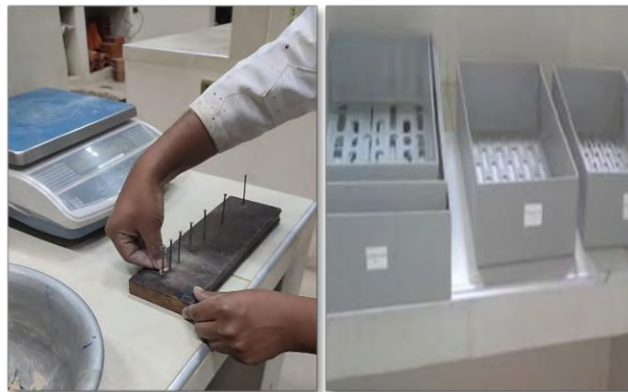
Figura A.1.8. Materiales del ensayo de índice de aplanamiento y alargamiento
