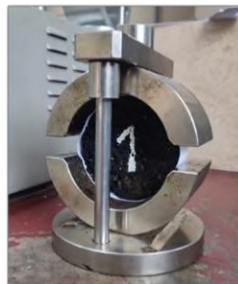
Figura A.3.21. Colocado de las briquetas en la mordaza de la prensa de Marshall.
