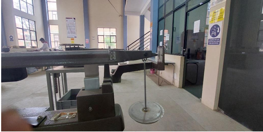
Figura 3.20 Balanza calibrada para conocer el peso sumergido del agregado
