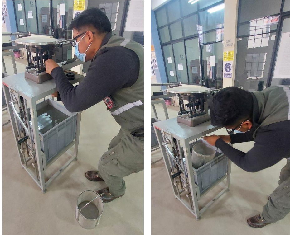
Figura 3.18 Preparación del equipo para hallar el peso sumergido del agregado
