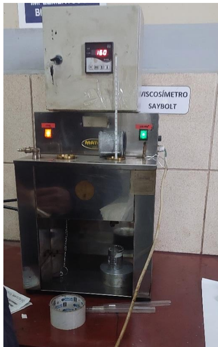
Figura 3.32 Medición de la temperatura del aceite y el asfalto
