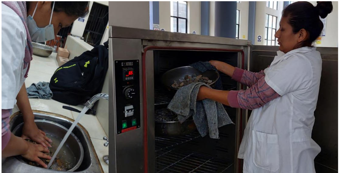
Figura 3.12 Lavado del material retenido en malla N.º 12
