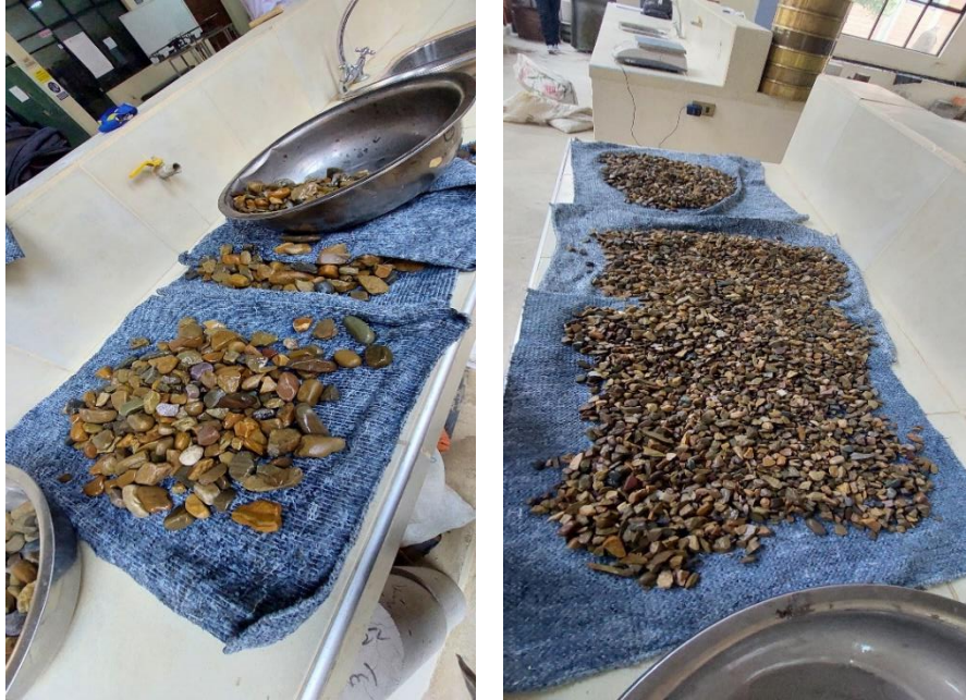
Figura 3.16 Agregados gruesos sumergidos en agua durante 24 horas.
