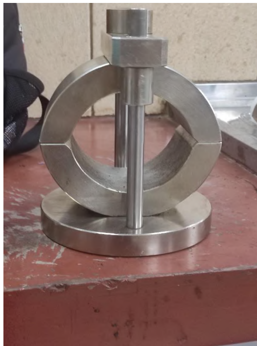
Figura 3.50 Mordaza para rotura de especímenes Marshall
