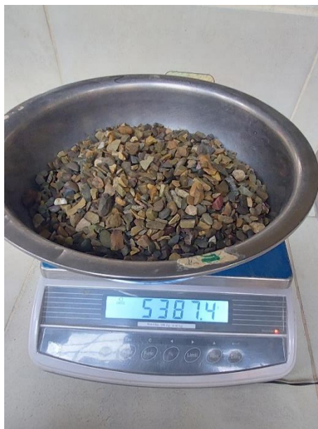
Figura 3.17 Obtención del peso en su condición superficialmente seca
