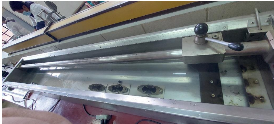
Figura 3.38 Colocación de los moldes en el baño María a temperatura de 25°C.
