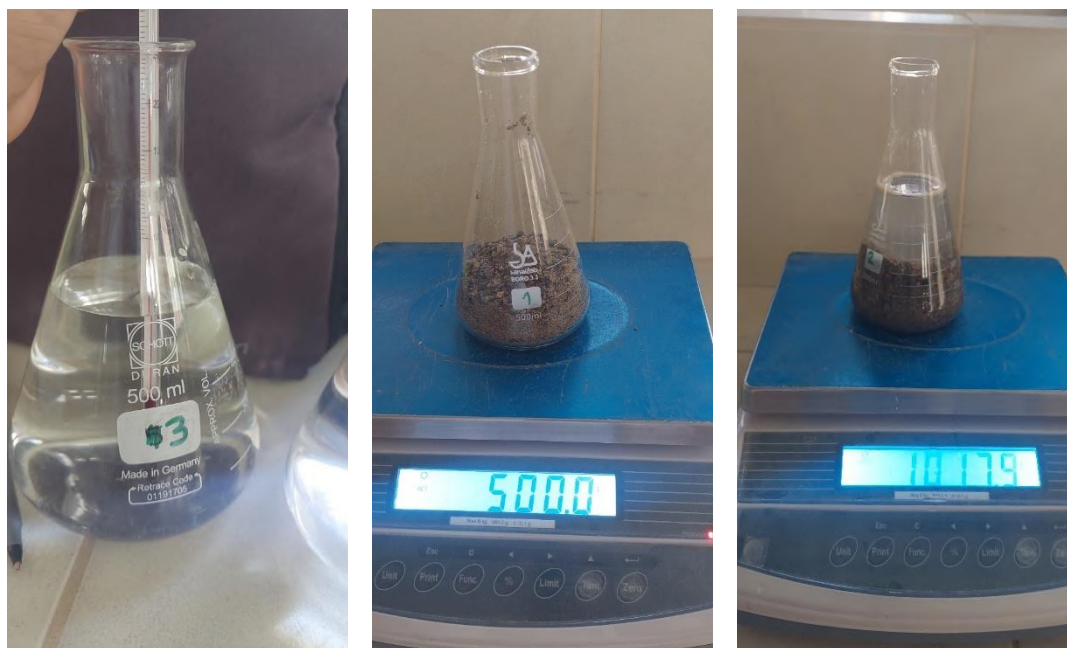
Figura 3.26 Medición de la temperatura y pesaje del material fino
