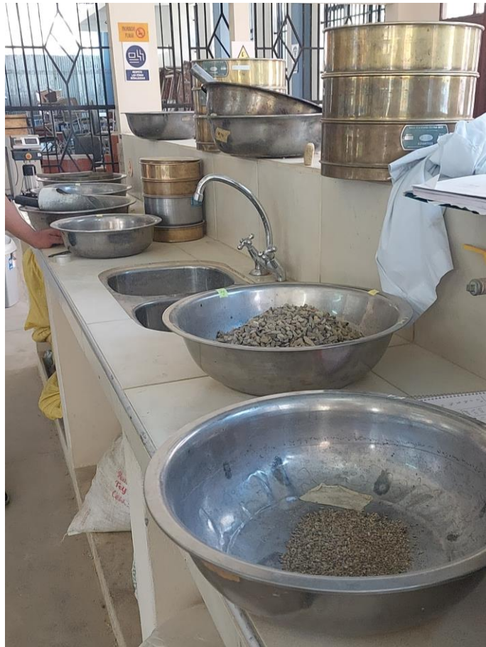
Figura 3.4 Pesado de los materiales retenidos en cada malla
