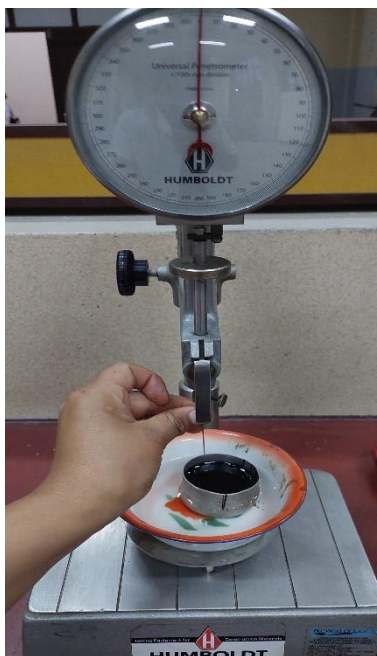
Figura 3.29 Ajuste de la aguja para ensayar la penetración
