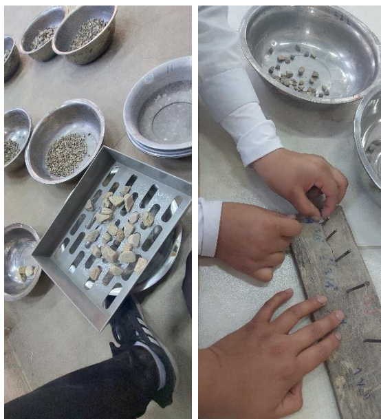
Figura 3.15 Tamizado y pesado del material grueso
