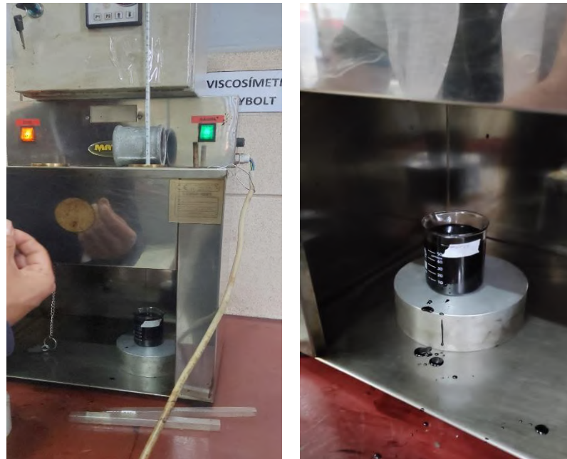
Figura 3.33 Medición del tiempo para calcular la Viscosidad Saybolt
