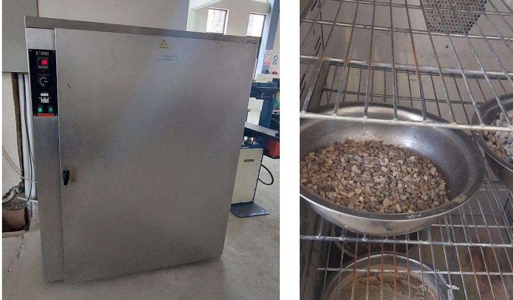
Figura 3.22 Secado en el horno del material grueso durante 24 horas
