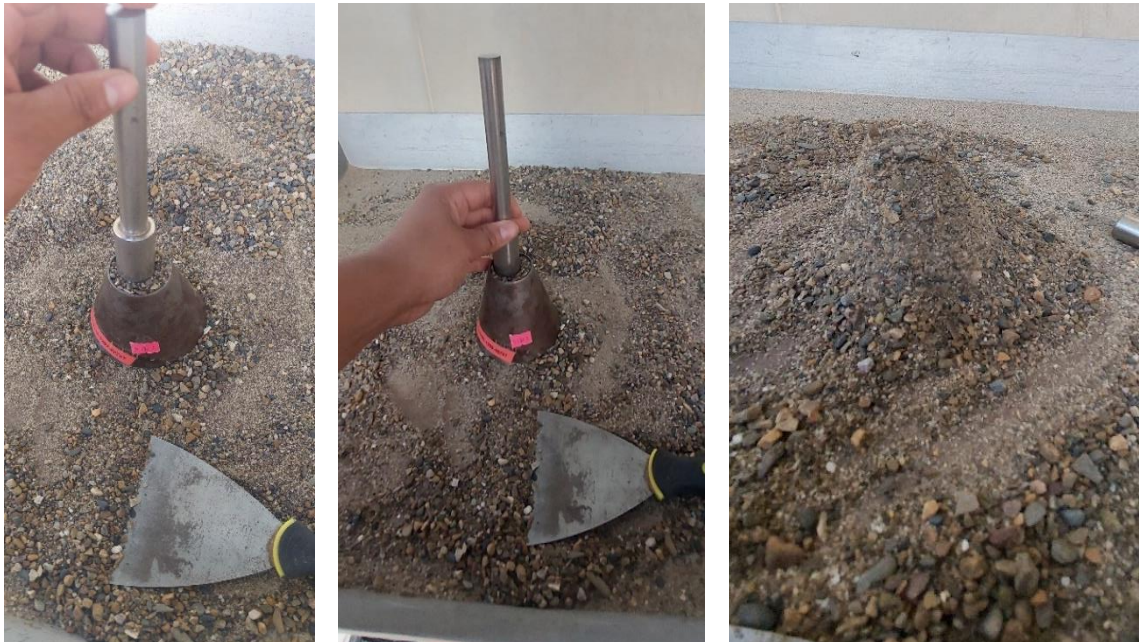
Figura 3.25 Colocación de las arenas en el cono metálico
