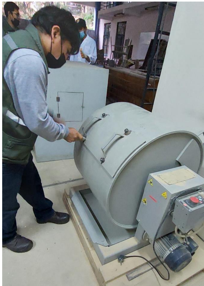
Figura 3.8 Cilindro metálico para realizar la prueba de desgaste de “Los Ángeles”
