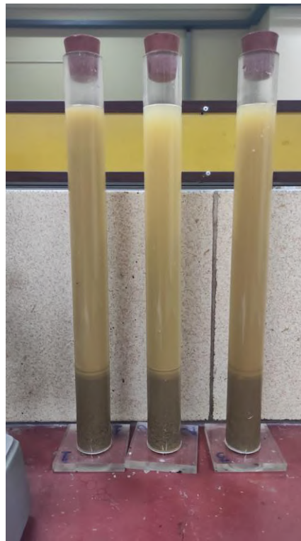
Figura 3.13 Probetas de ensayo por cada arena utilizado en diferente M.A.
