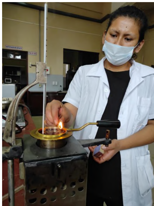
Figura 3.43 Control del destello y anotación de la temperatura en ese instante
