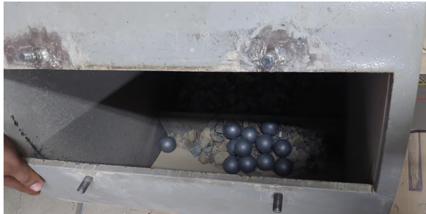
Figura 3.10 Introducción de la muestra en la máquina de “Los Ángeles”
