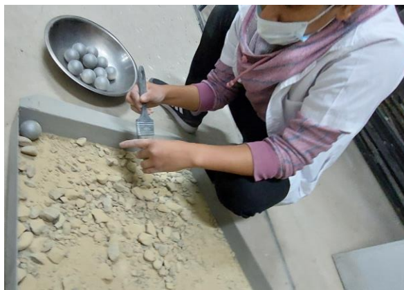
Figura 3.11 Tamización del material por malla N.º12
