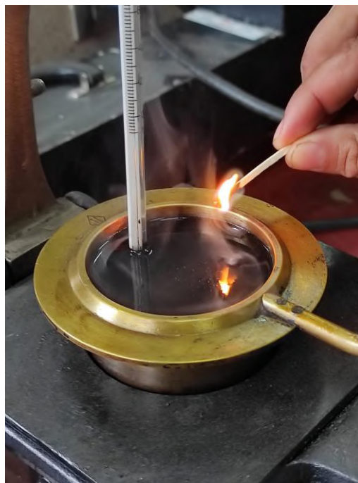
Figura 3.43 Control del destello y anotación de la temperatura en ese instante
