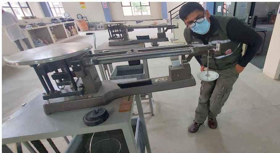
Figura 3.19 Calibración de la balanza para el peso sumergido
