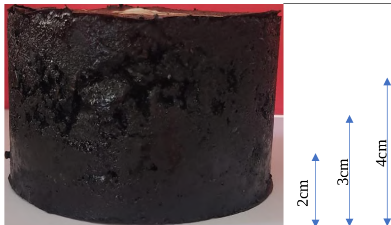
Figura 3.78 Extracción de imágenes mediante tomografía a diferentes alturas
