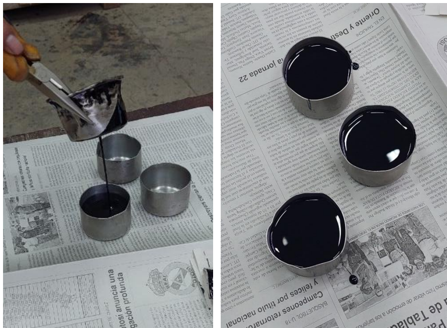
Figura 3.28 Muestra de C.A. en 3 vasos de precipitación de 50 ml
