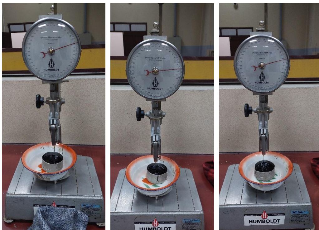
Figura 3.30 Medición de las muestras de C.A. con el equipo de penetración
