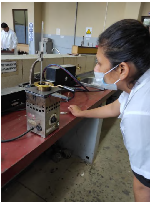
Figura 3.42 Control de la temperatura en la copa de Cleveland
