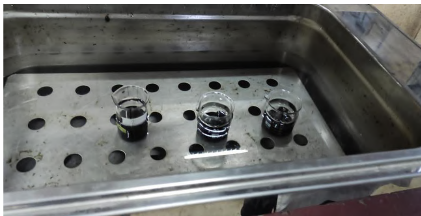
Figura 3.35 Muestras colocadas en el baño María para el ensayo de peso específico
