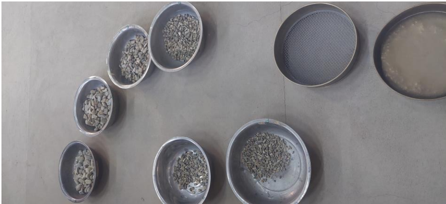
Figura 3.9 Pesaje de los materiales retenidos según el método de abrasión
