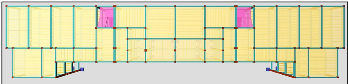
Figura N°3.6: Estructura con Separación de Junta de Dilatación
