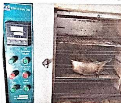
ENSAYO DE CONTENIDO DE HUMEDAD
