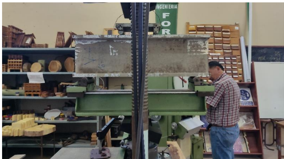
Figura 3.5. Ensayo experimental en viga tipo I de ferrocemento
