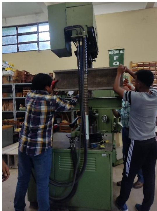
Fotografía 38. Colocación del espécimen a ensayar
