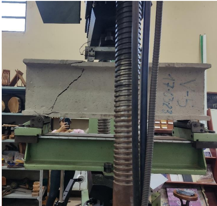
Fotografía 42. Apreciación de la falla diagonal
