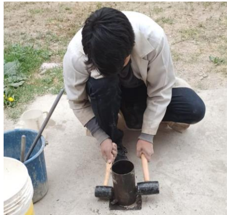
Fotografía 20. Compactado manual de la mezcla de mortero
