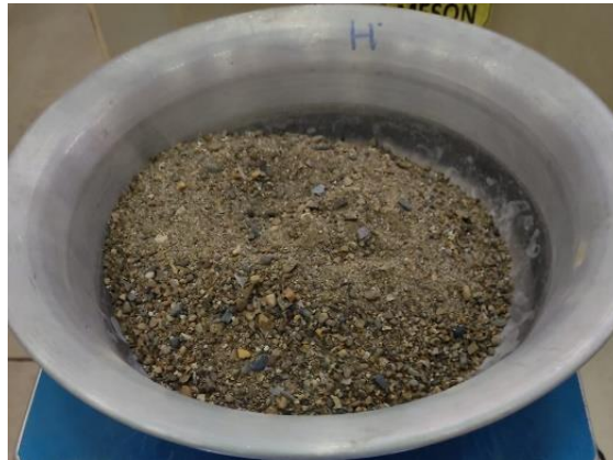
Fotografía 9. Tamizado mecánico de agregado fino
