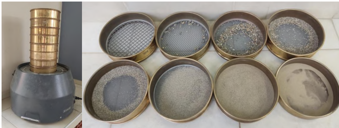
Fotografía 9. Tamizado mecánico de agregado fino
