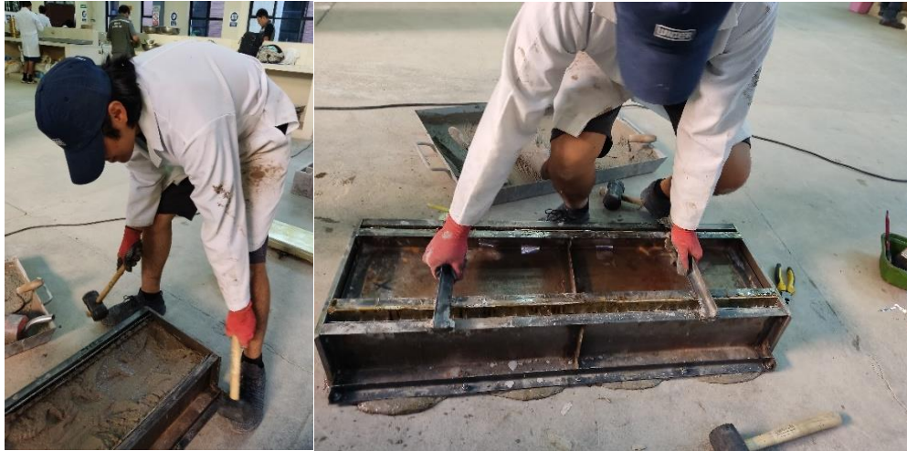
Fotografia 34. Vibrado manual del mortero
