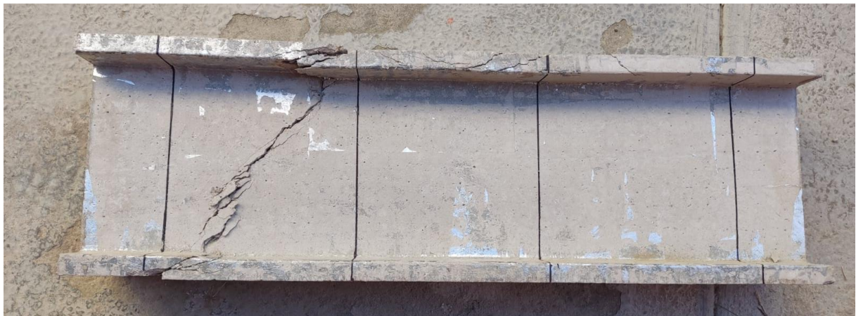
Fotografia 43. Fisuras fuera del tercio central
