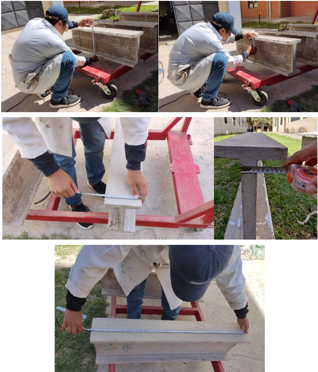
Fotografía 36. Medición de las dimensiones de la viga
