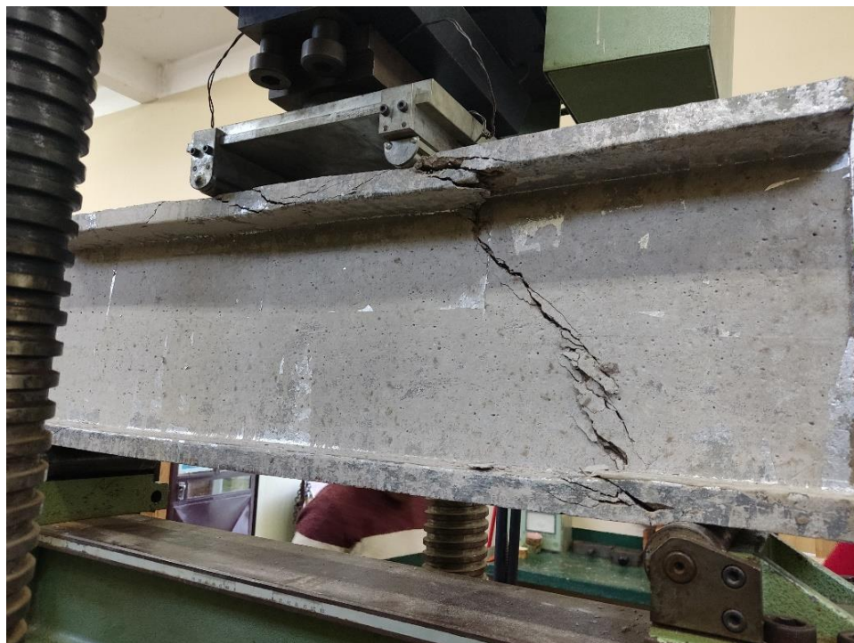
Fotografía 42. Apreciación de la falla diagonal
