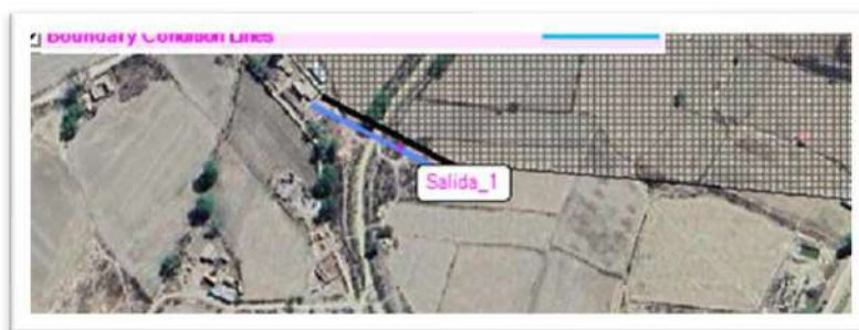
Figura 5.11: Generación del conector hidráulico SA/2D en HEC-RAS
