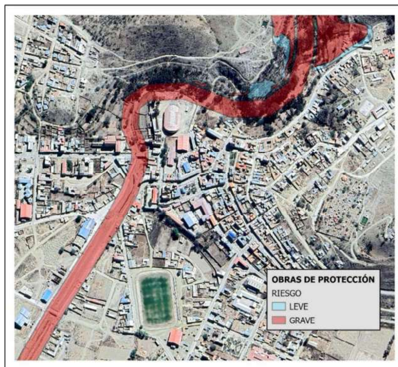
Figura 5.57: Mapa de riesgo con obras de protección Fuente: Elaboración propia.
