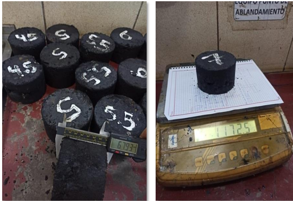
Figura 3.53 Medir sus alturas y pesar en estado seco al aire libre
