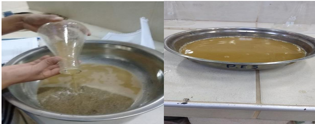
Figura 3.15 Sacar la muestra del matraz y dejar secar en el horno para posteriormente pesar
