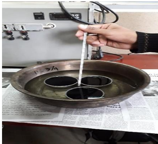
Figura 3.25 Colocamos las muestras en baño maría por 25° C por 30 min.
