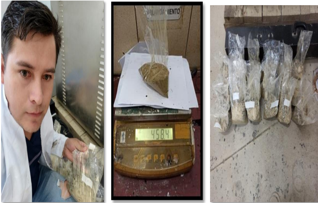
Figura 3.49 Pesar los agregados en cantidades necesarias
