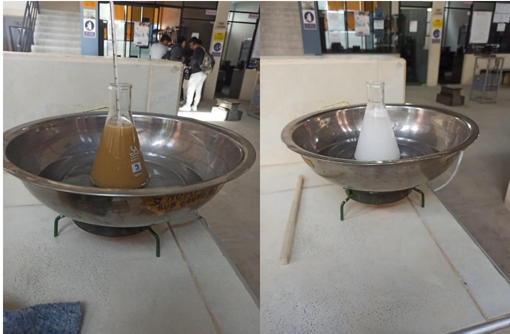
Figura 3.46 Poner en baño maria la muestra del filler introducida en el matraz luego pesar y hacer variar las temperaturas de 30 a 15°C
