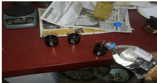
Figura 3.37 Llenar con agua destilada cada uno de los picnómetros y dejar en baño maría por 30 min sacar y pesar
