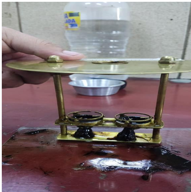
Figura 3.34 Alcanzada la temperatura de 5°C colocar las guías centradoras y las bolas de acero y calentar
