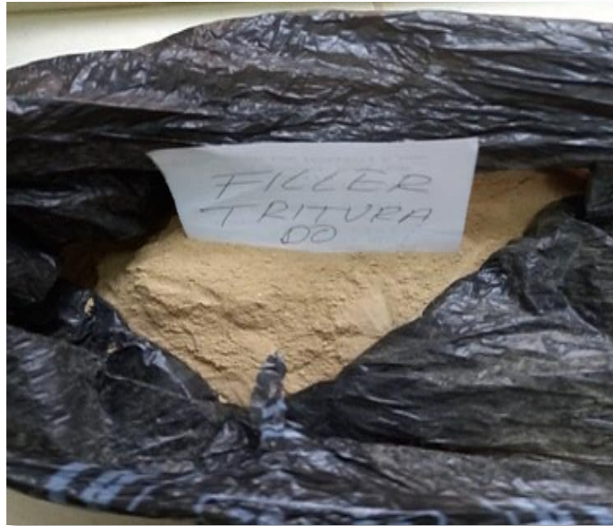
Figura 3.23 Tamizar la muestra por el tamiz N° 12 luego lavar y dejar al horno a secar y pesar.
