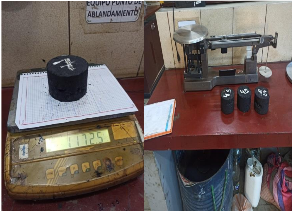
Figura 3.55 Pesar las briquetas saturadas con superficie seca
