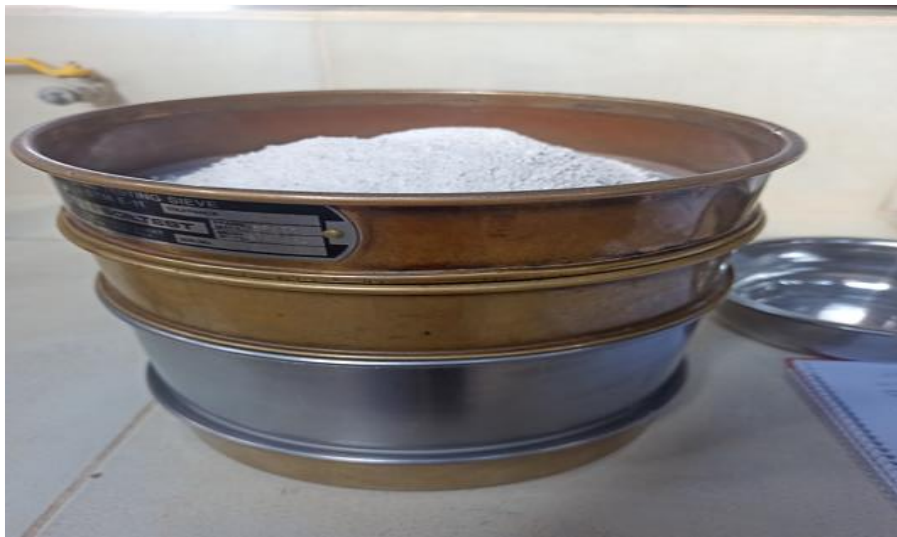
Figura 3.39 Vaciar el material en los tamices
