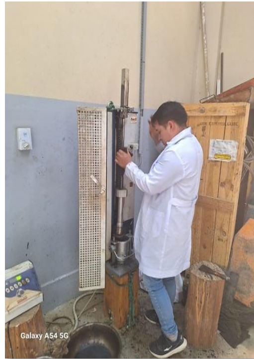
Figura 3.51 Compactamos con 75 golpes cada lado, desmoldar y dejar enfriar
