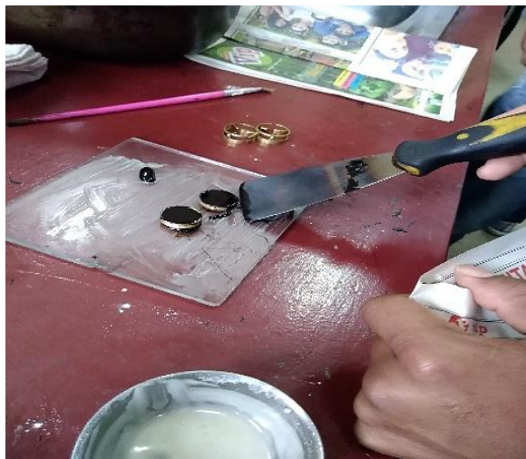
Figura 3.32 Verter el cemento asfáltico en los anillos y dejar enfriar
