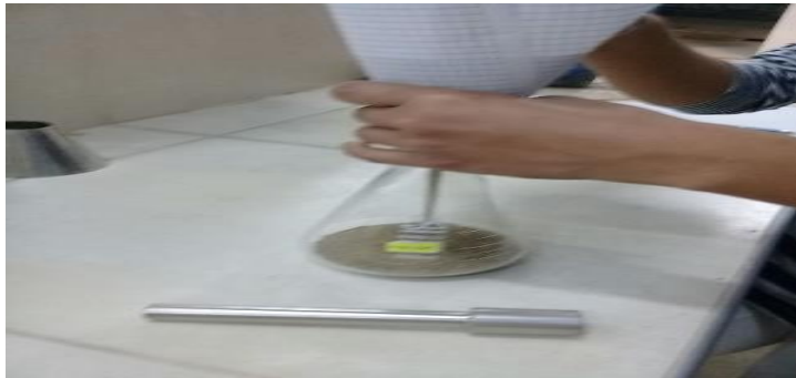
Figura 3.14 Colocar en un matraz de 500 gr de material y llenar agua y pesar
