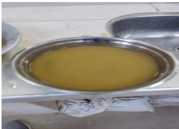
Figura 3.12 Lavar y dejar saturar en agua por 24 horas
