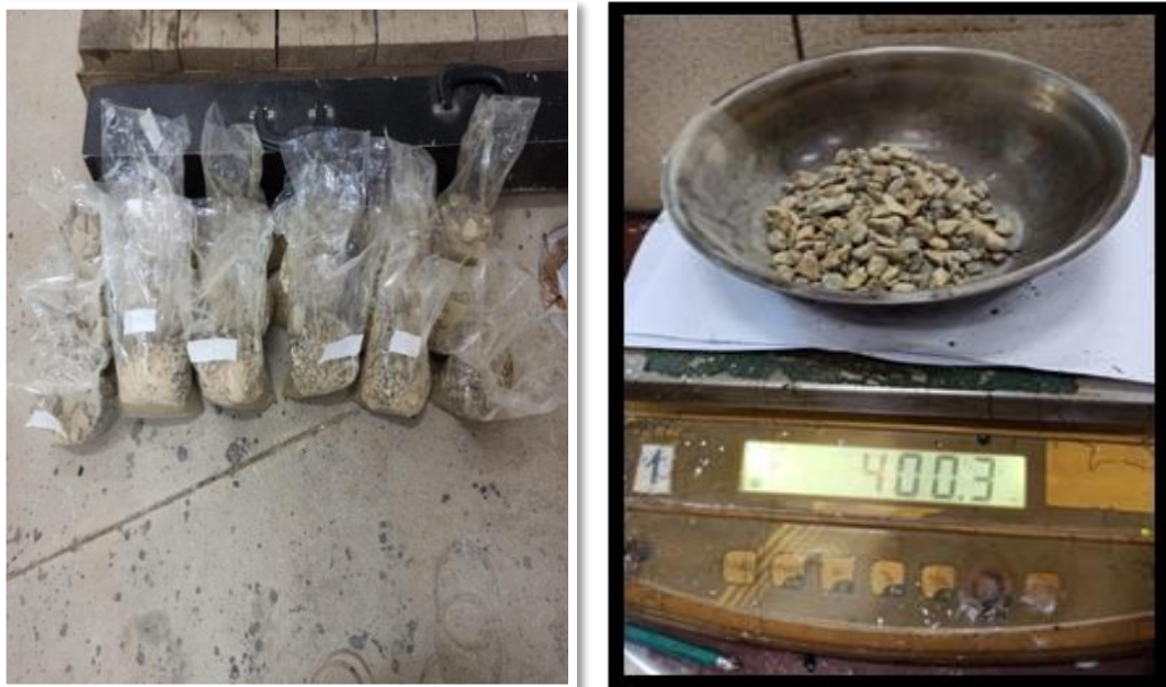
Figura 3.48 Separación de los agregados por tamaño para armar la granulometría
