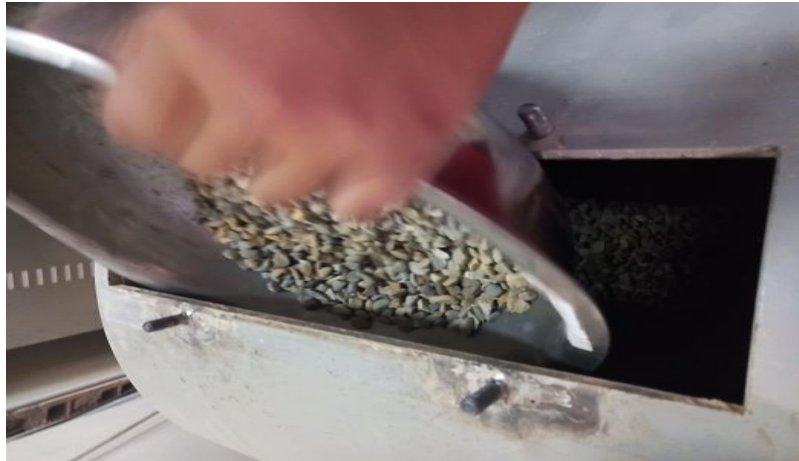
Figura 3.21 Introducir la muestra y las cargas abrasivas en la máquina de los Ángeles.
