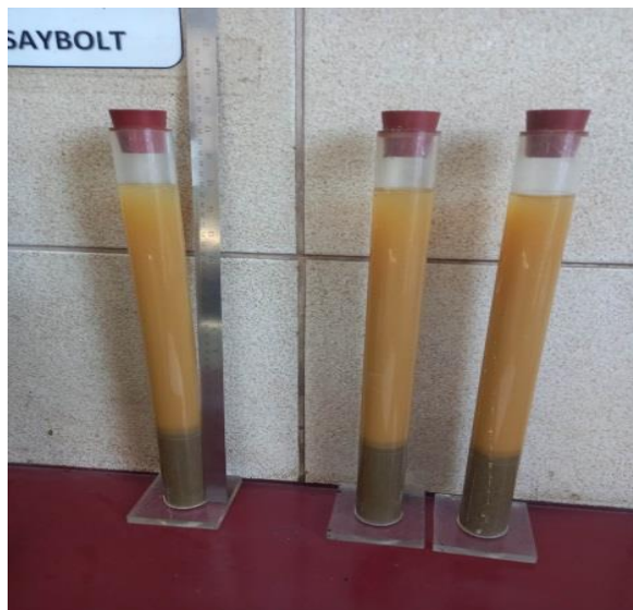
Figura 3.17 Colocar el material y golpear en la parte baja del cilindro para evitar burbujas de aire y dejar reposar por 10 minutos
