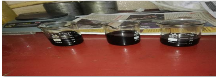
Figura 3.36 Verter el cemento asfáltico en los picnómetros
