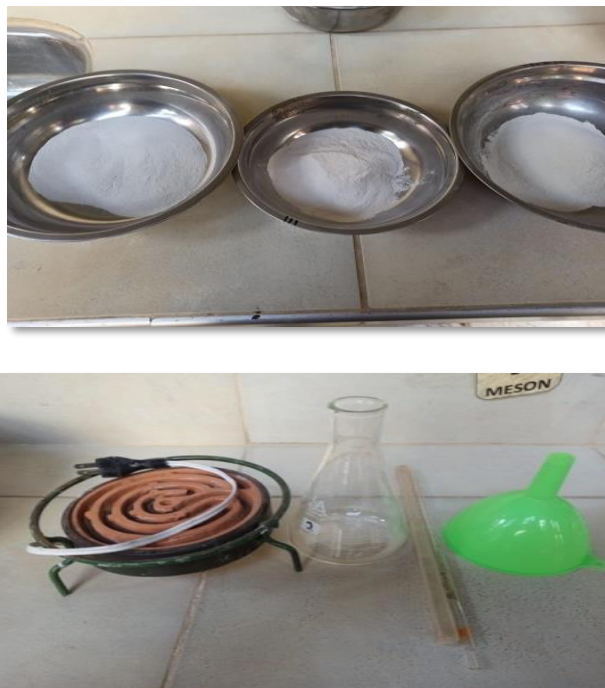
Figura 3.42 Materiales a ser utilizados para la calibración del frasco volumétrica
