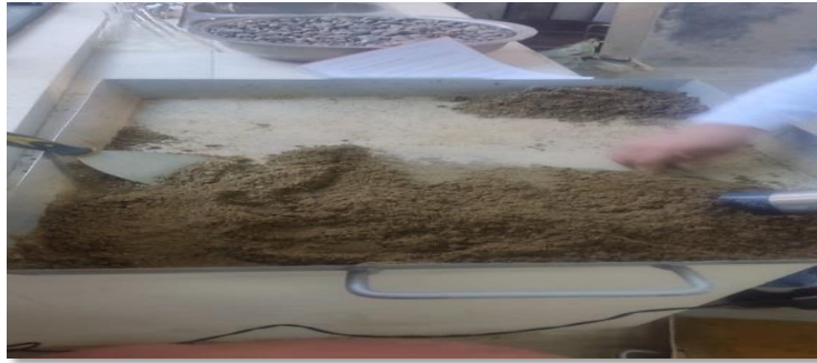
Figura 3.13 Secado superficial con secadora
