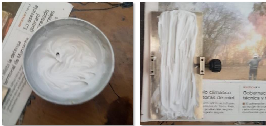
Figura 3.27 Armado engrasado de los platos de base y los moldes
