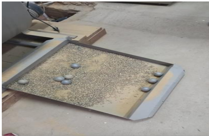
Figura 3.22 Sacar el material y las cargas abrasivas.
