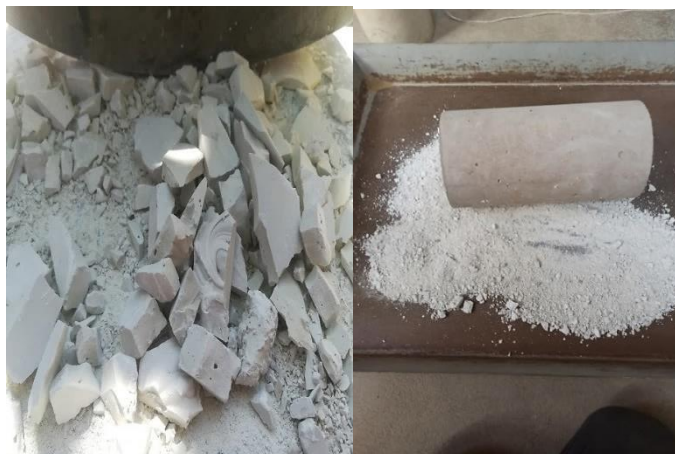
Figura 3.4 Una vez seco el material procedemos a pasar con el rodillo
