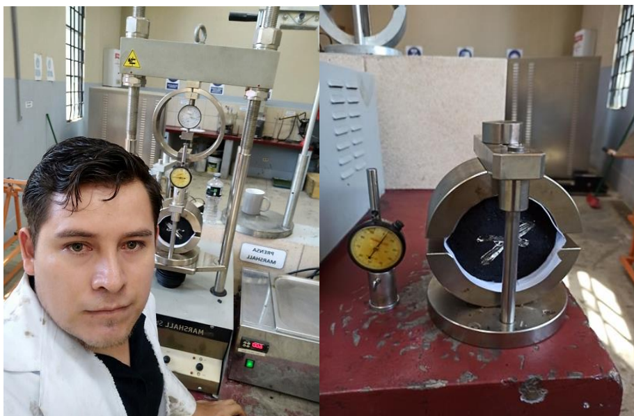
Figura 3.57 Colocar las briquetas en la mordaza y lectura del dial de estabilidad (dentro del anillo Marshall) y el dial de deformación para el flujo
