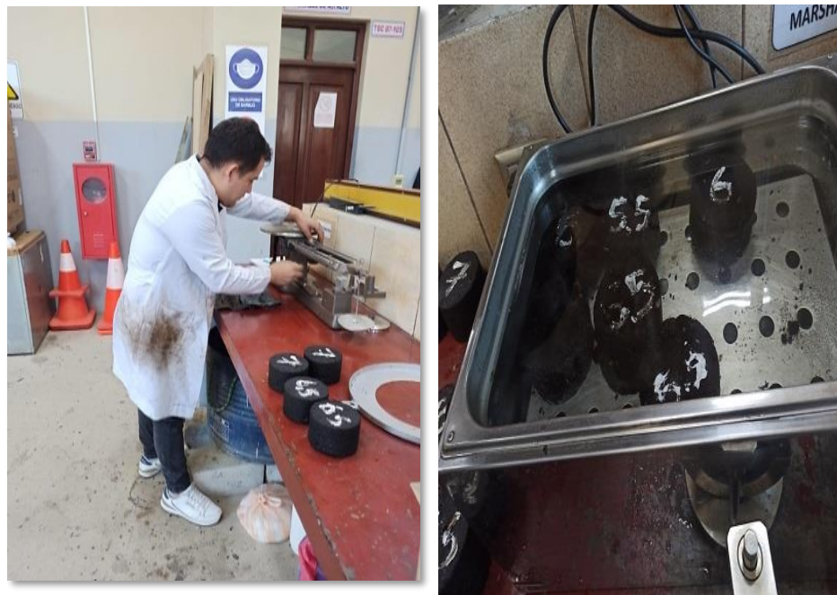
Figura 3.54 Sumergir las briquetas en agua durante 5 min a 25° C y después determinar el peso sumergido en agua
