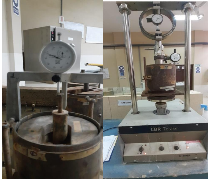
Figura N° 57 Ensayo de CBR
