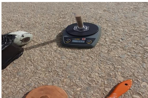
Figura N° 70 Pesaje de la arena
