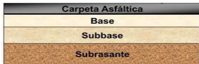
Figura N° 1 Capas del pavimento flexible
