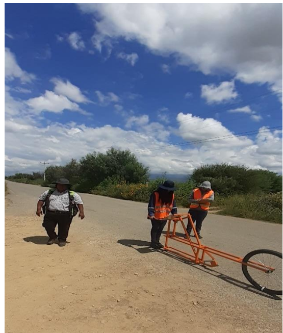
Figura N° 64 Lectura con el equipo merlín
