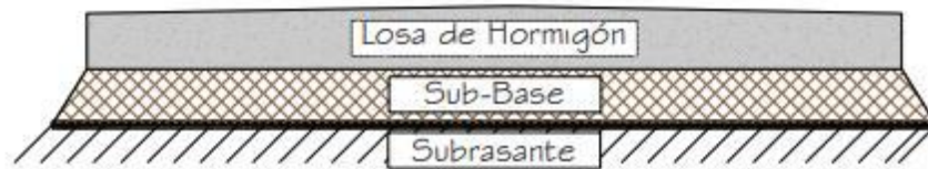
Figura N° 4 Sección de un pavimento rígido.
