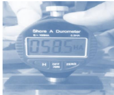
Figura N° 39 Medición de la dureza del caucho de la zapata del péndulo TRRL.
