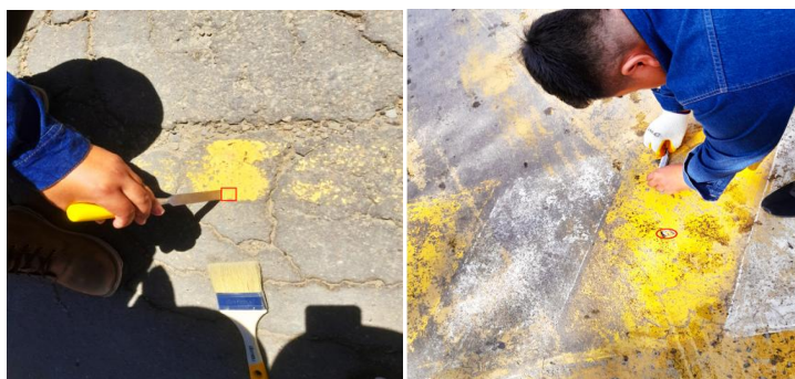
Figura 3. 18 Extracción de muestras de pintura en demarcaciones viales
