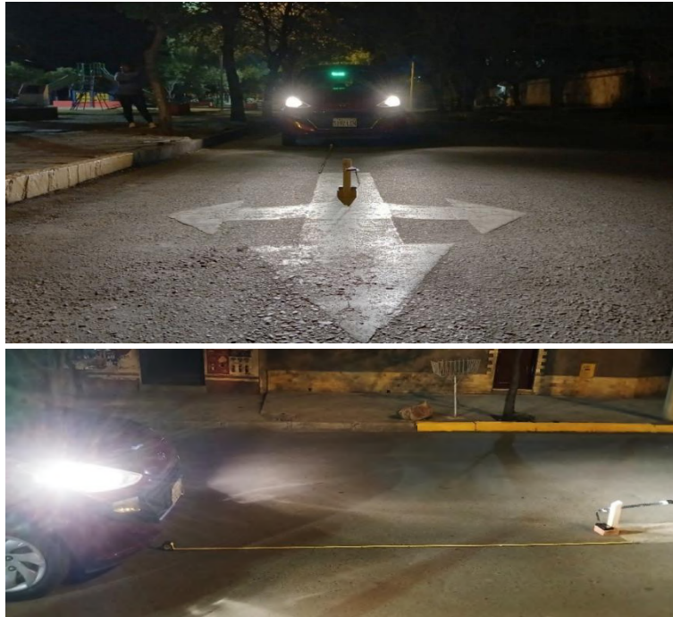
Figura 3. 27 Ubicación del vehículo para la medición de iluminancia reflejada
