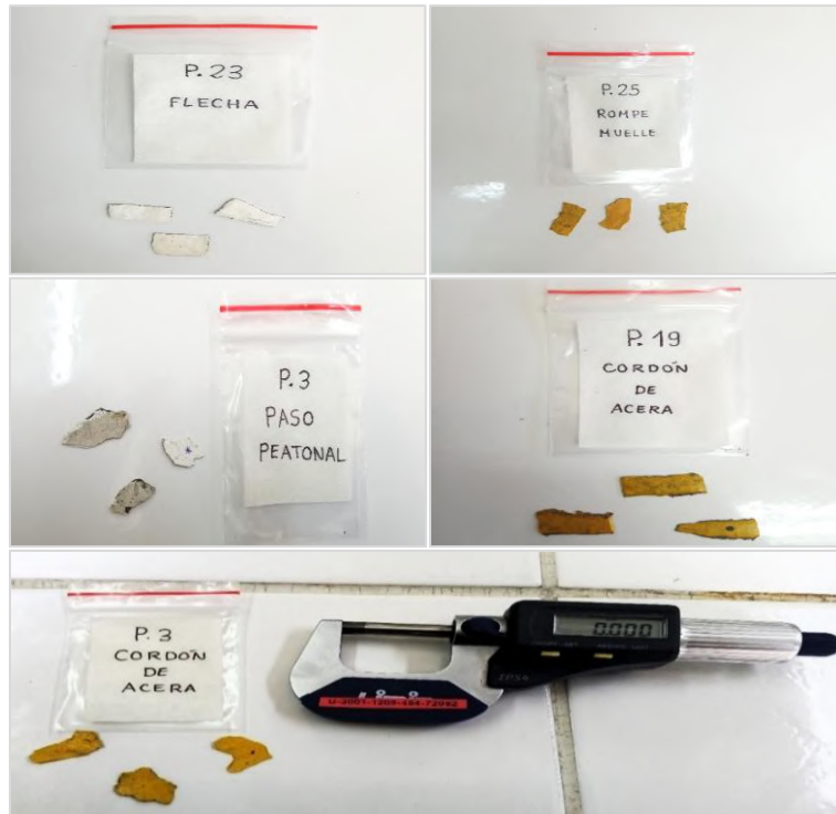
Figura 3. 23 Medición del espesor de las muestras con micrómetro
