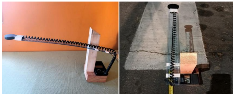
Figura 3. 28 Ubicación del sensor del luxómetro con la altura y ángulo definidos
