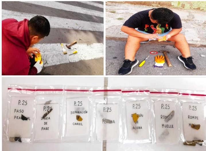
Figura 3. 19 Lijado, selección y almacenamiento de muestras de pintura
