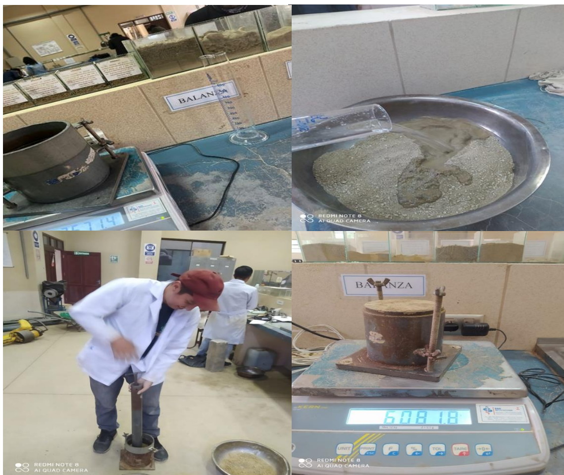
Figura 3.25: Ensayo de compactación Proctor (T 180)
