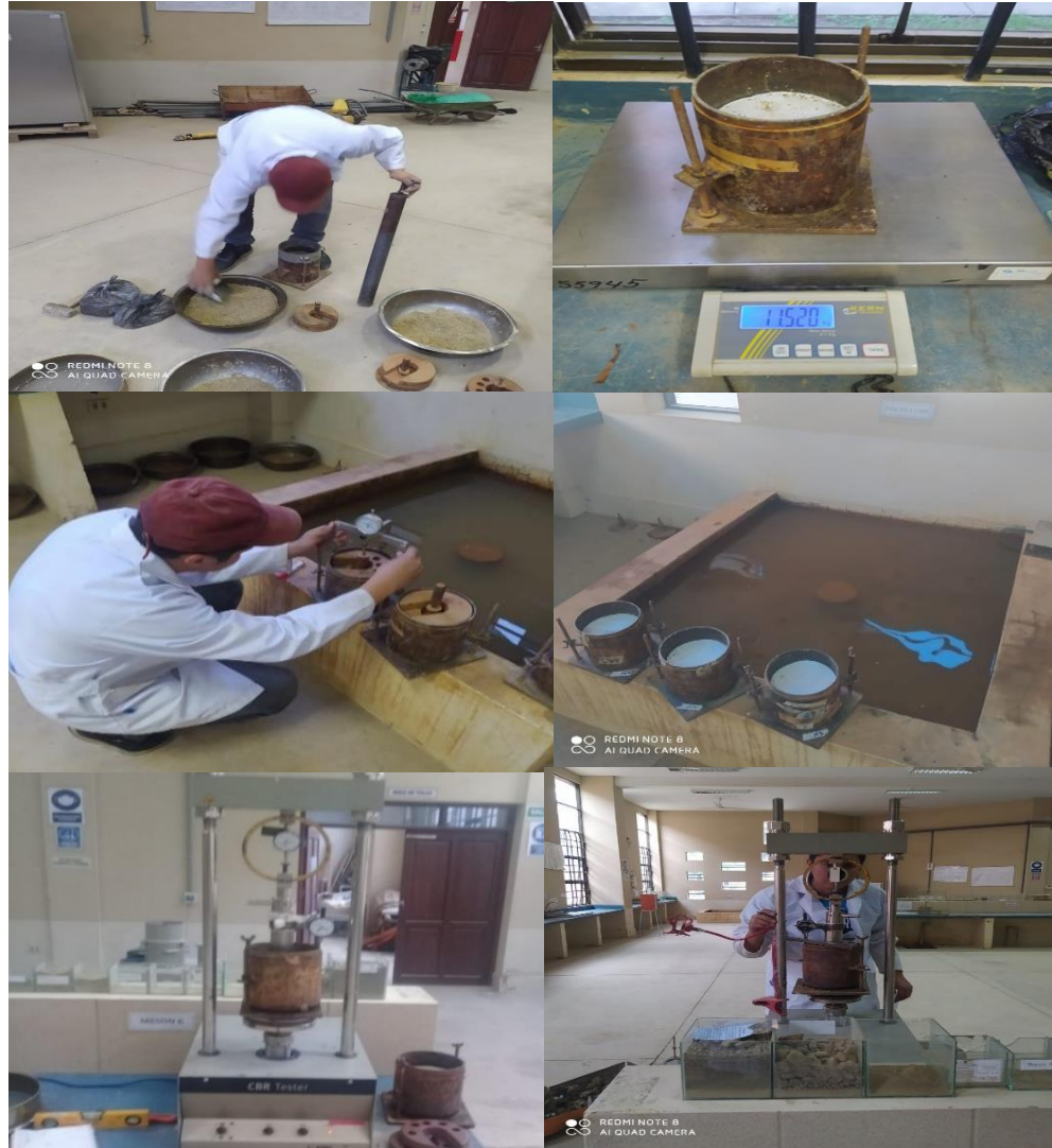
Figura 3.26: Ensayo de capacidad de soporte
