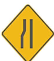
SP-40 REDUCCIÓN ASIMÉTRICA DE LA CALZADA IZQUIERDA
