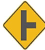
SP-20 VÍA LATERAL DERECHA
