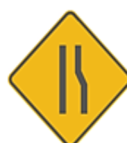
SP-39 REDUCCIÓN ASIMÉTRICA DE LA CALZADA DERECHA
