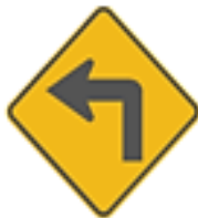
SP-1 CURVA PELIGROSA IZQUIERDA
