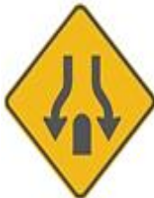
SP-61 TÉRMINO VÍA CON SEPARADOR (UN SENTIDO)
