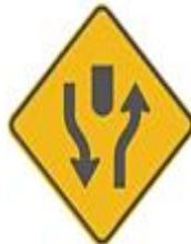
SP-62 INICIO VÍA CON SEPARADOR
