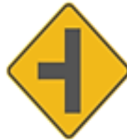
SP-19 VÍA LATERAL IZQUIERDA
