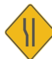
SP-42 ENSANCHE ASIMÉTRICO DE LA CALZADA IZQUIERDA
